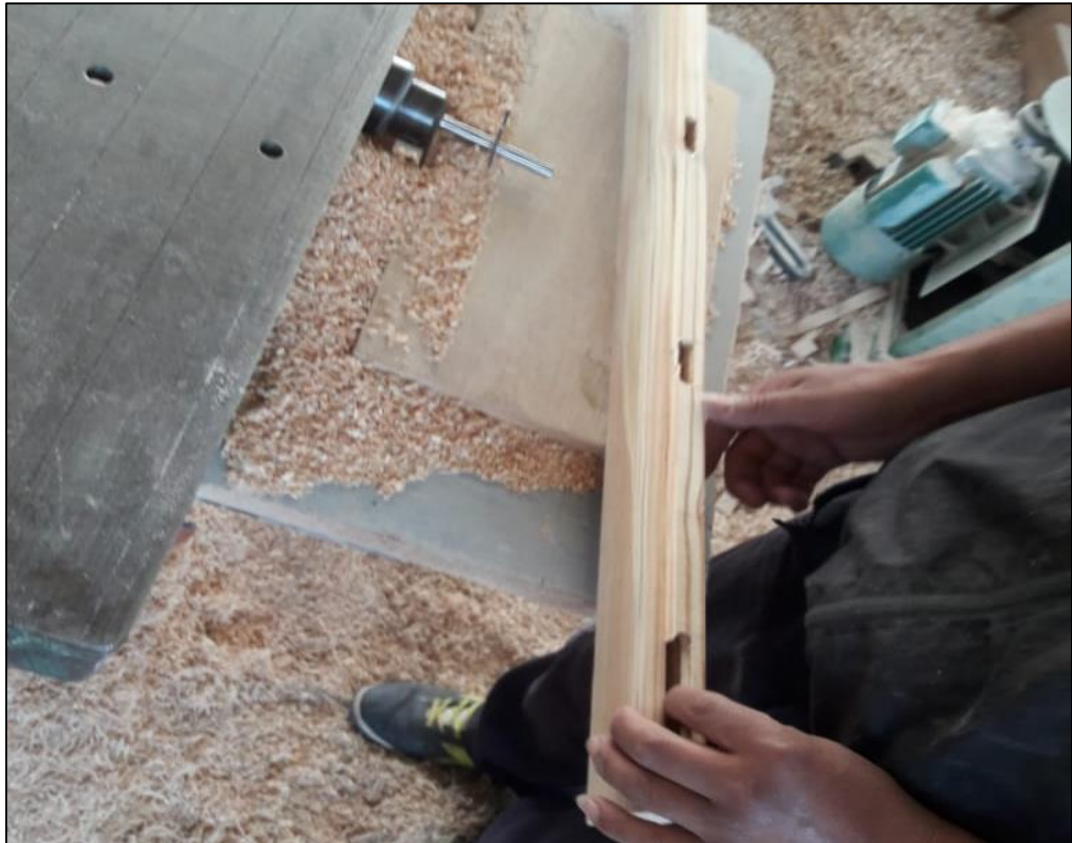
Figura 12. Falta de uso de equipo de protección adecuada.
