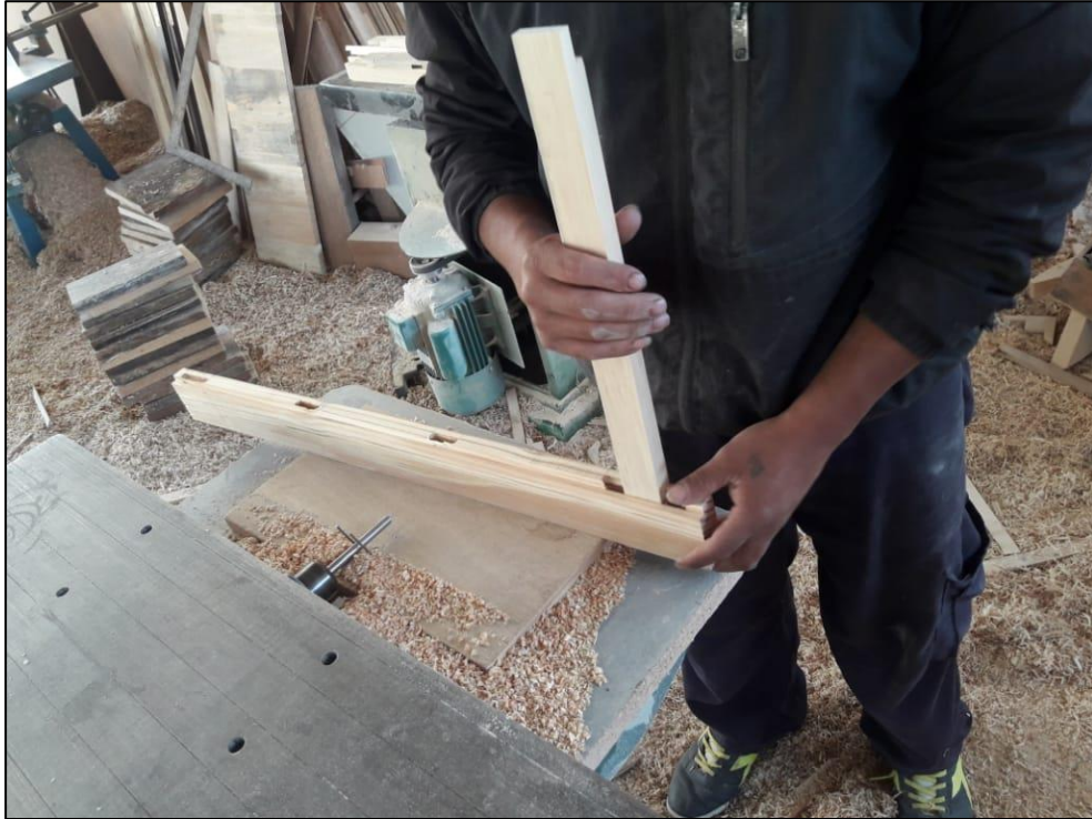
Figura 24. Armado inicial de puertas.
