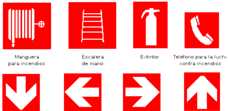
Figura 15: Señales relativas a los equipos de lucha contra incendios
