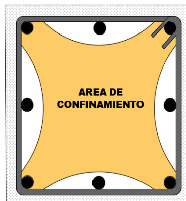
Figura 37. Área de confinamiento de columna no circular
