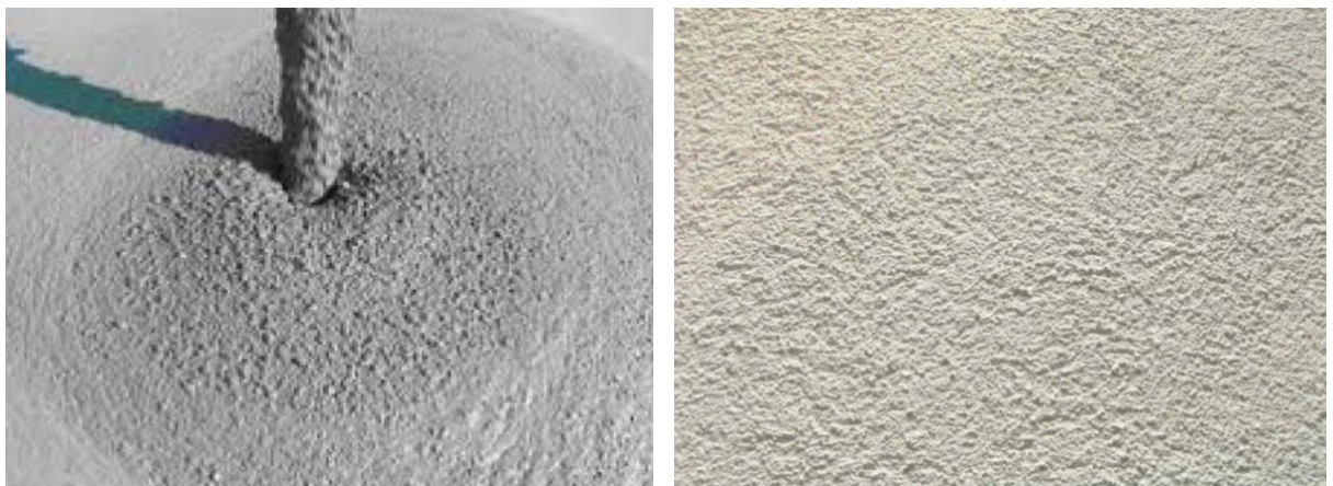
Figura 3. Muestra de concreto antes y después de fraguado.
