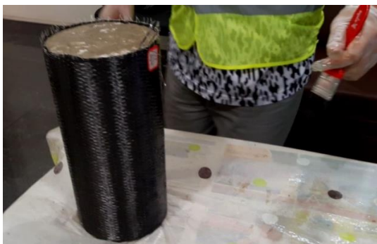
Figura 29. Muestra de concreto reforzada con Fibra de Carbono.
