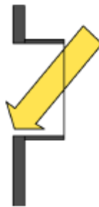
Figura 3.9. Ventana saliente o bow-window. Un menor porcentaje de radiación solar es recibida.
