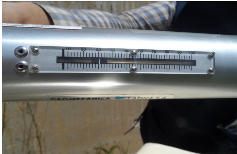
Figura 88 Esclerómetro con el que se trabajó en campo.
