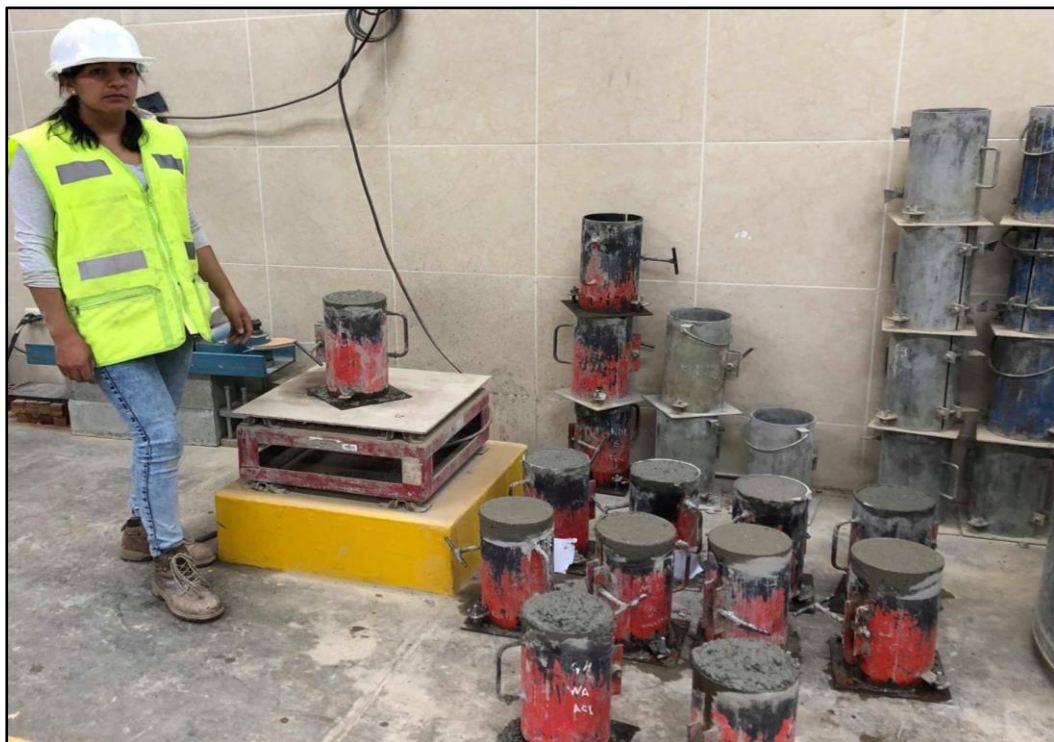
Foto N° 08: Laboratorio UPN – Vibrado de probetas.
