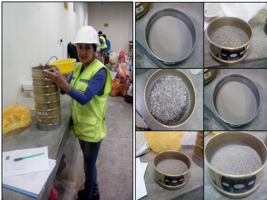
Foto N° 04: Laboratorio UPN – Ensayo de Granulometría de los agregados.
