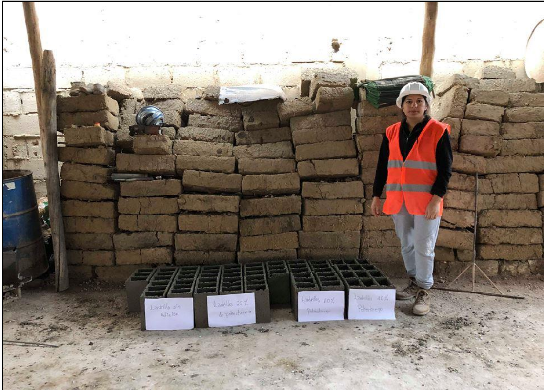
Foto N° 15: Curado de ladrillos para losa aligerada con y sin adición de poliestireno.
