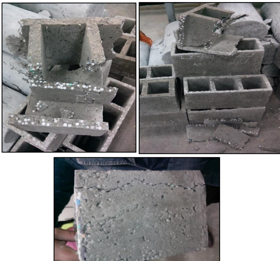
Foto N° 18: Laboratorio UPN – Verificación de fallas en ladrillos con y sin adición de poliestireno en diferentes porcentajes.
