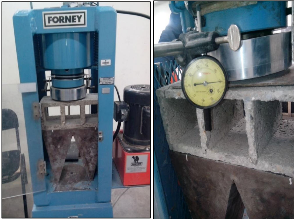
Foto N° 17: Ensayo a compresión de ladrillos con y sin adición de poliestireno.
