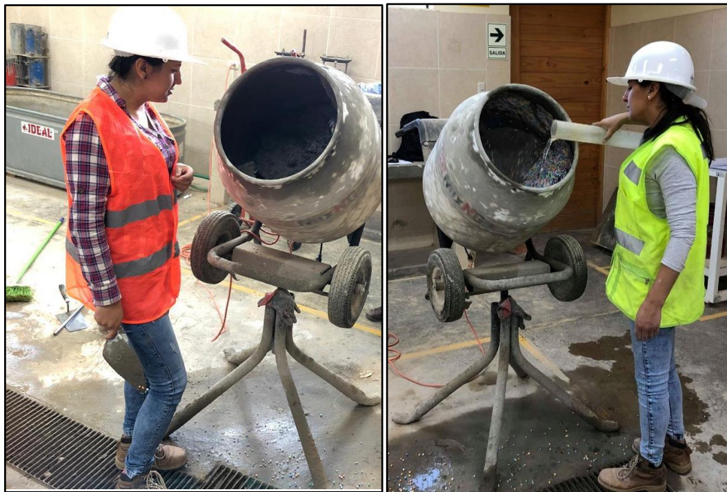
Foto N° 06: Laboratorio UPN – Preparación de Mezcla de concreto Con y sin adición de poliestireno.
