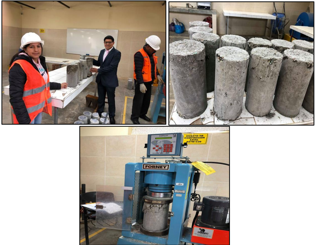
Foto N° 11: Laboratorio UPN – Verificación de fallas de probetas con adición de poliestireno en diferentes porcentajes.
