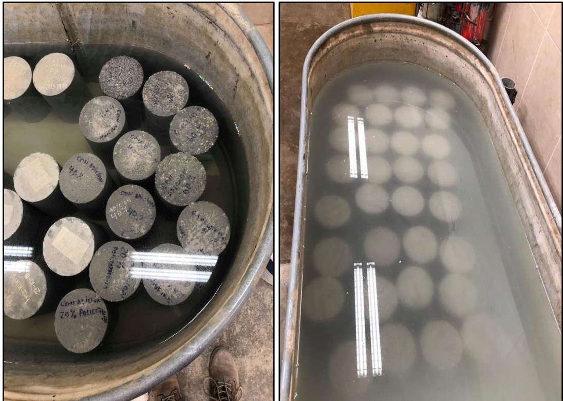
Foto N° 09: Laboratorio UPN – Curado de probetas de concreto.
