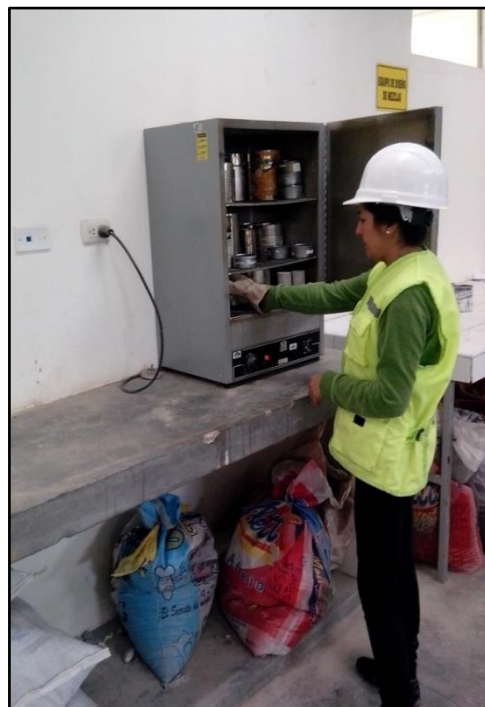
Foto N° 02: Laboratorio UPN – Ensayo de contenido de humedad de los agregados.
