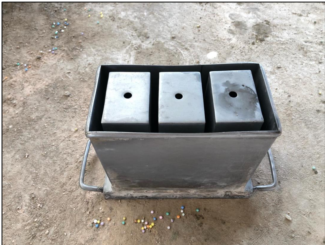
Foto N° 13: Molde para la elaboración de los ladrillos con y sin adición de perlas de poliestireno con diferentes porcentajes.
