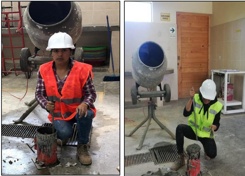
Foto N° 07: Laboratorio UPN – Elaboración de probetas Con y sin adición de poliestireno.
