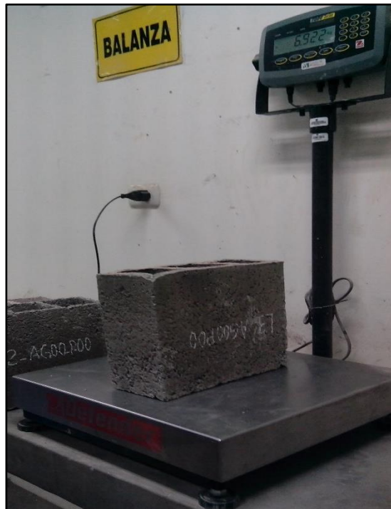
Foto N° 16: Peso de ladrillos con y sin adición de perlas de poliestireno
