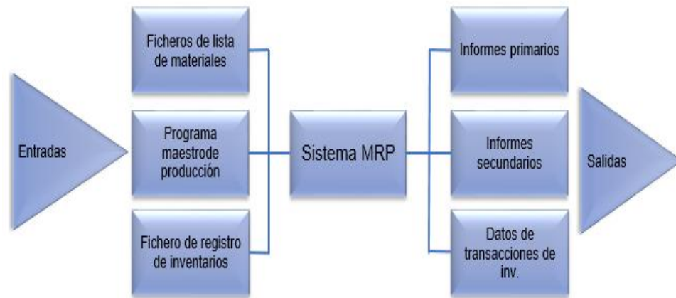
Figura 7: Funcionamiento del MRP I
