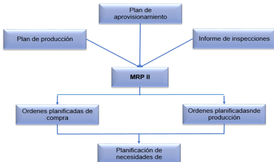
Figura 9: Funcionamiento del MRP II
