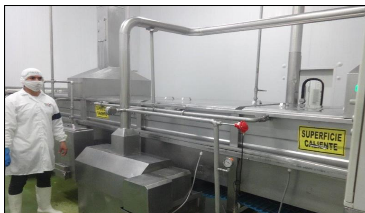
Figura 11: Desinfección Continua en el Blanching
