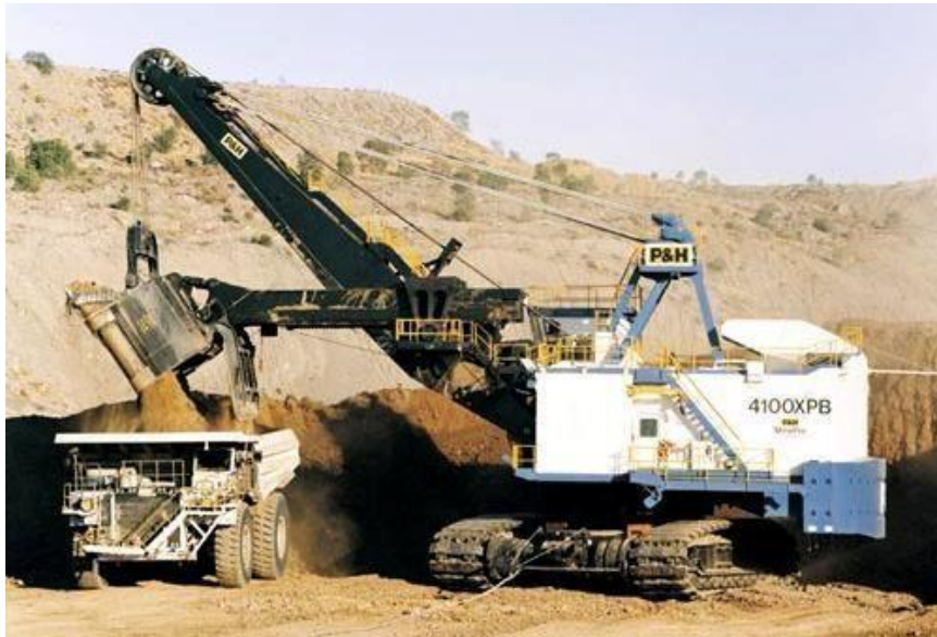
Figura N°1 Pala de Cables en Operaciones
