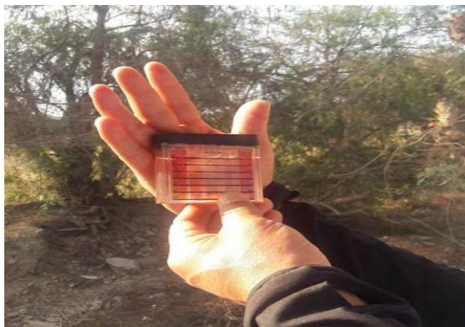
59. Cloro residual del caserío de Cajamarca-Simbal III
