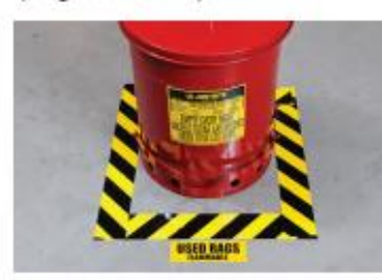
Área de riesgo (negro/amarillo)
