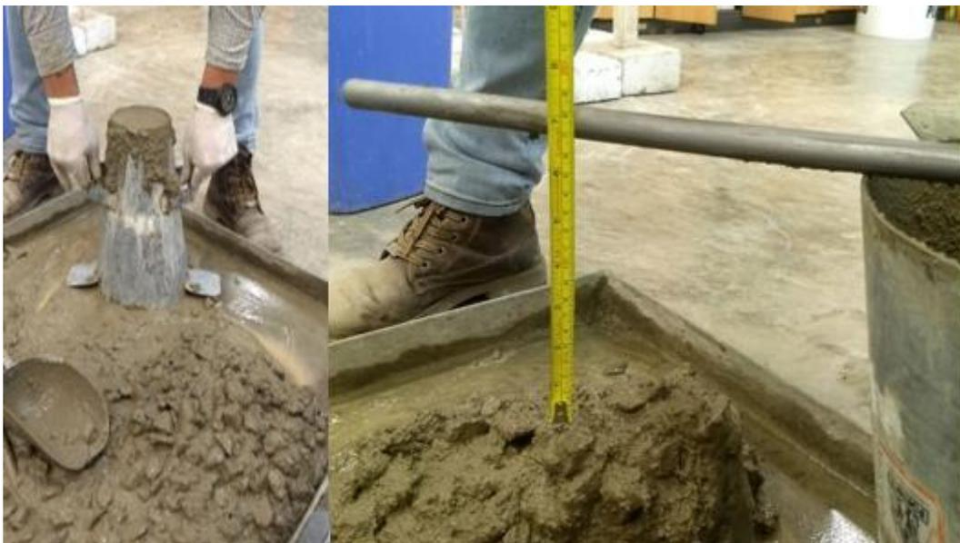
Figura 11. Medición de los asentamientos o Prueba de SLUMP.
