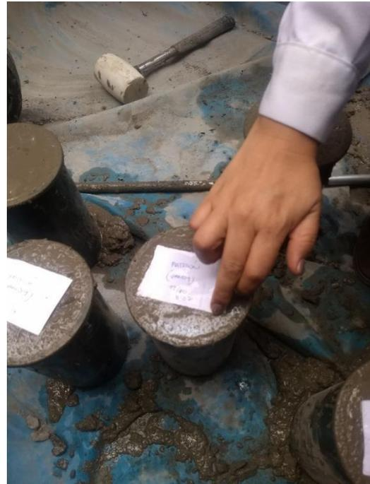
Figura 14: Etiquetado de probetas
