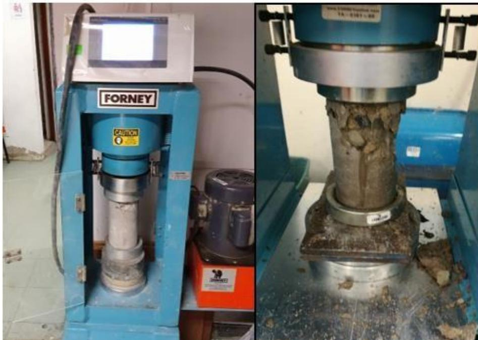
Figura 9. Rotura de probetas con Prensa Hidráulica.
