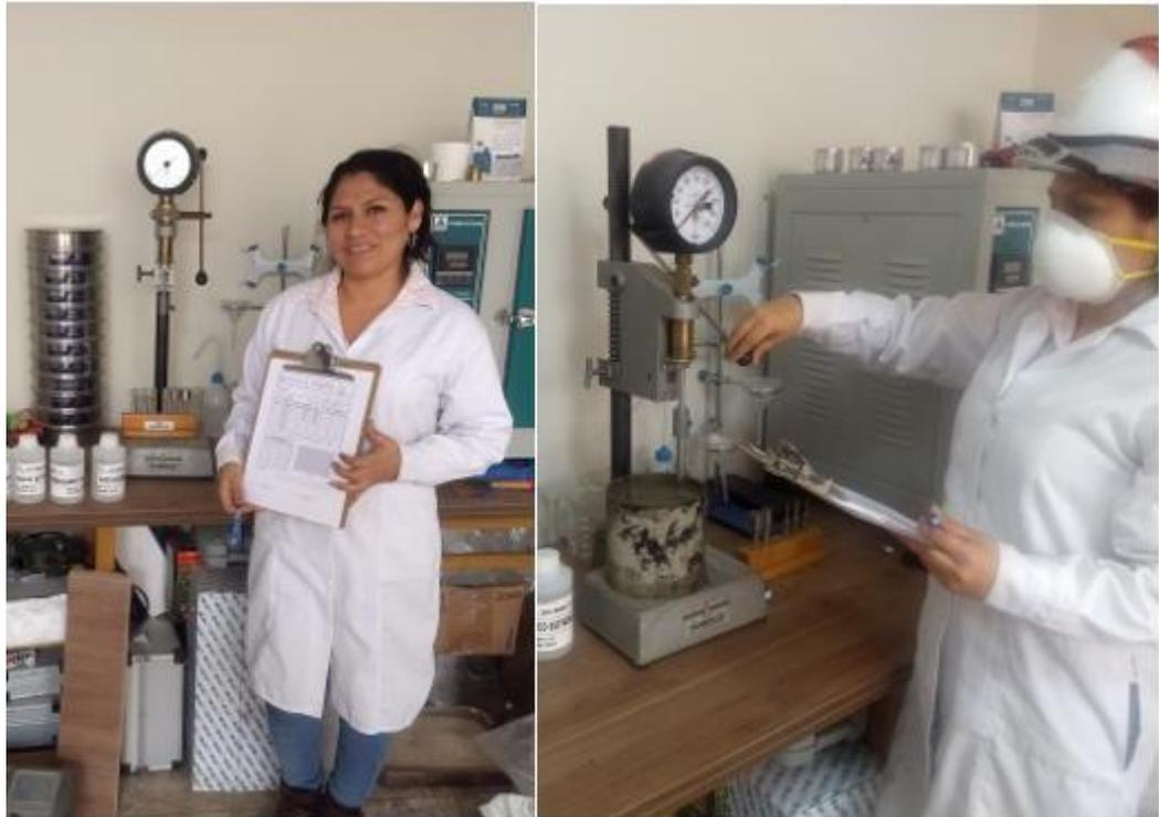
Figura 7. Medición de los tiempos de fraguado con el instrumento llamado Penetrómetro.
