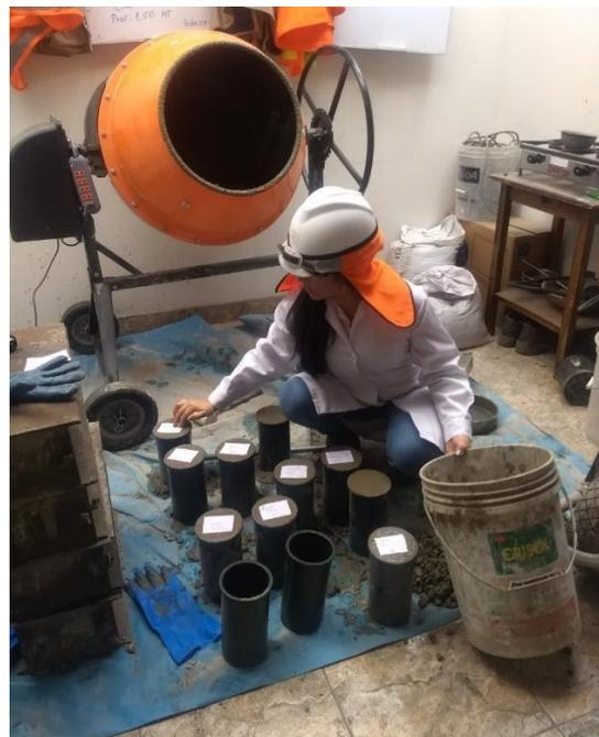
Figura 16: Etiquetado de probetas
