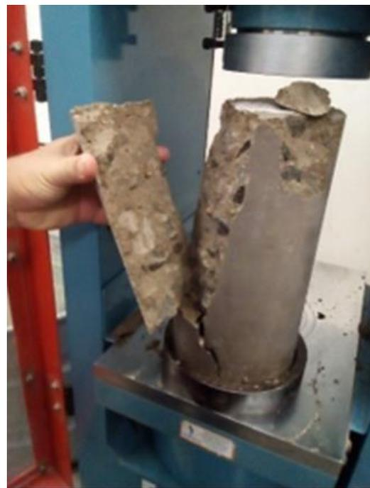
*Figura 24 : Prueba de resistencia a la compresión.*
