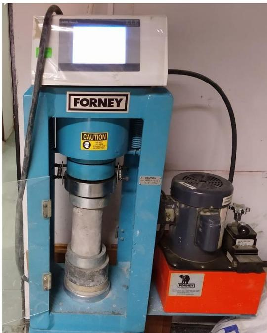
*Figura 23 : Prueba de resistencia a la compresión*
