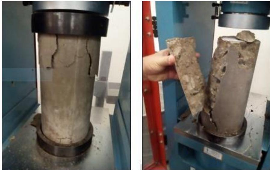
Figura 5. Probeta de concreto ensayadas a los 7 días
