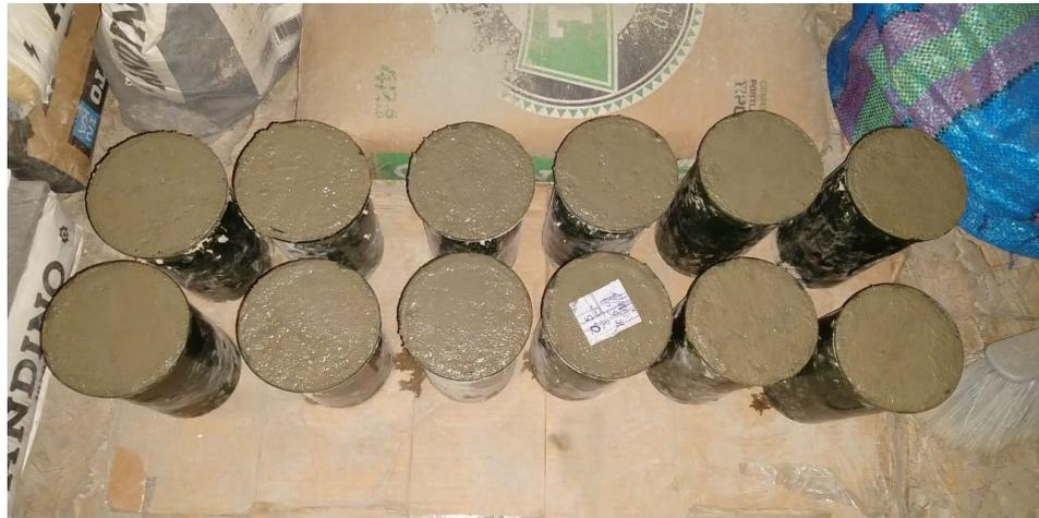
Figura 4. Probetas  $f_c=210$  Kg/cm<sup>2</sup> en estado fresco.
