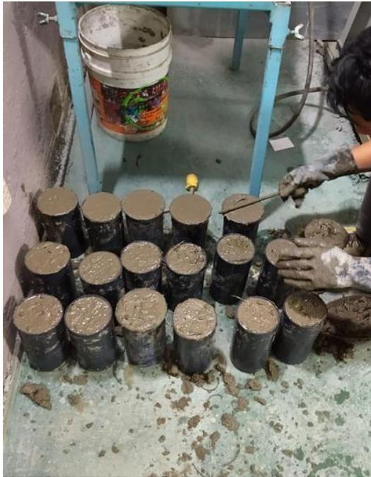
Figura 13: Elaboración de probetas
