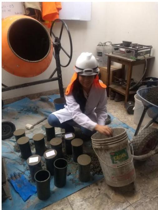
Figura 15: Etiquetado de probetas
