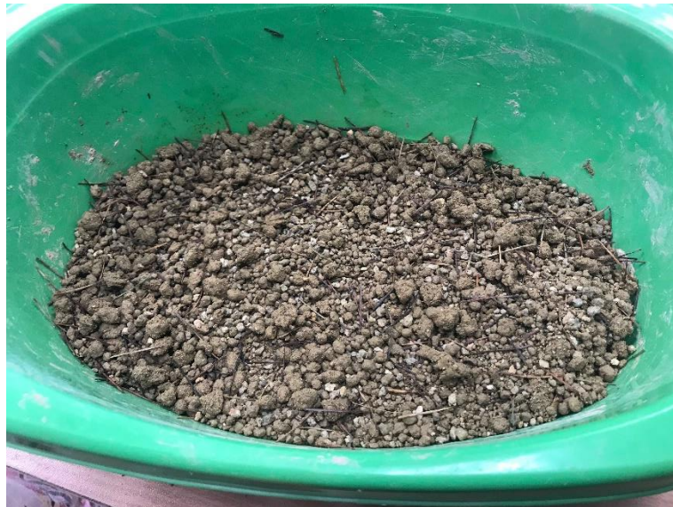
Figura 10 Preparación de muestra para ensayo proctor
