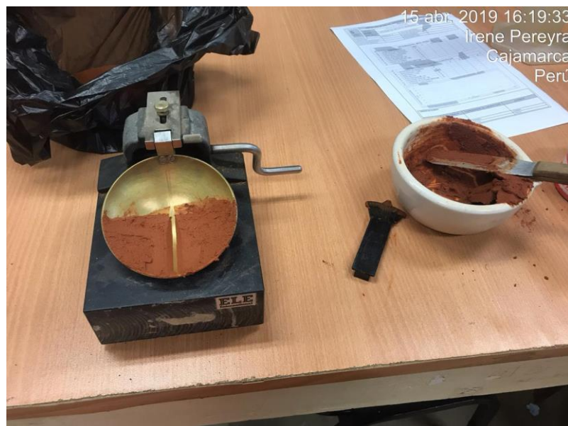
Figura 9 Limite liquido de la muestra con la cuchara de Casagrande.
