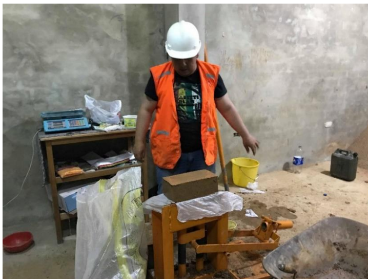
Figura 18 Extracción del adobe compactado
