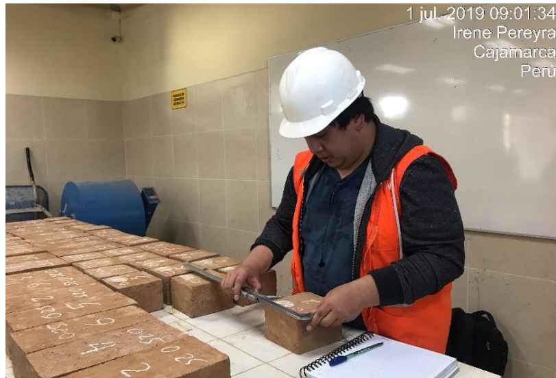
Figura 20 Toma de medidas de los adobes
