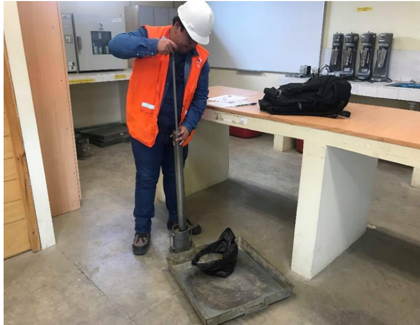
Figura 13 Compactación de la muestra en capas con el pistón
