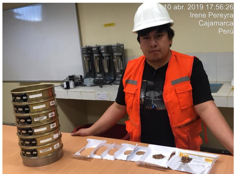
Figura 7 Tamizado de la muestra seca.
