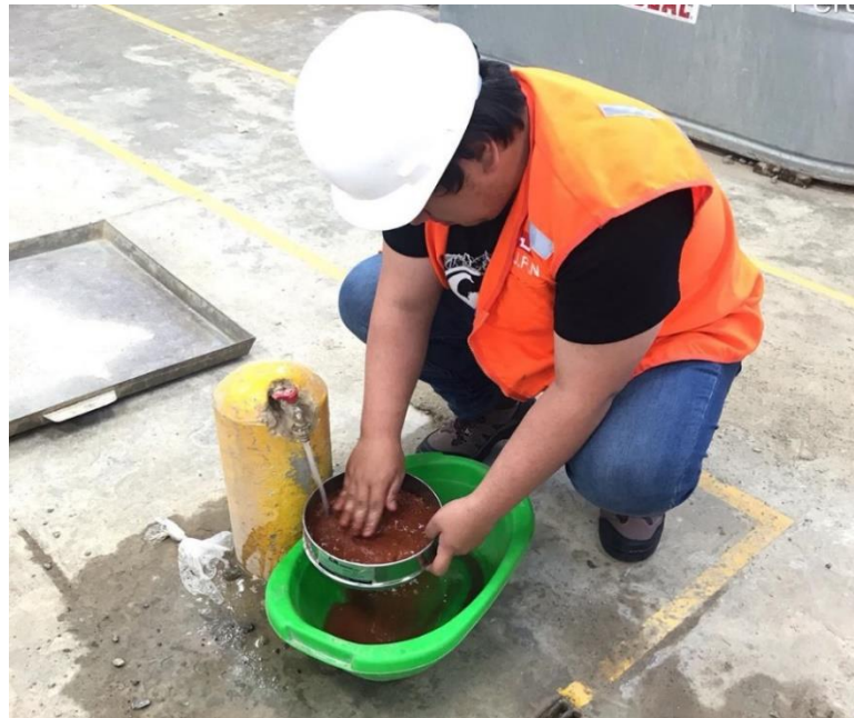
Figura 6 Ensayo de tamizado por lavado de la muestra.
