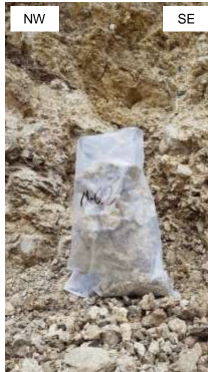
Figura 27. Muestra de suelo de la Estación de control geotécnico N°02 del Talud.
