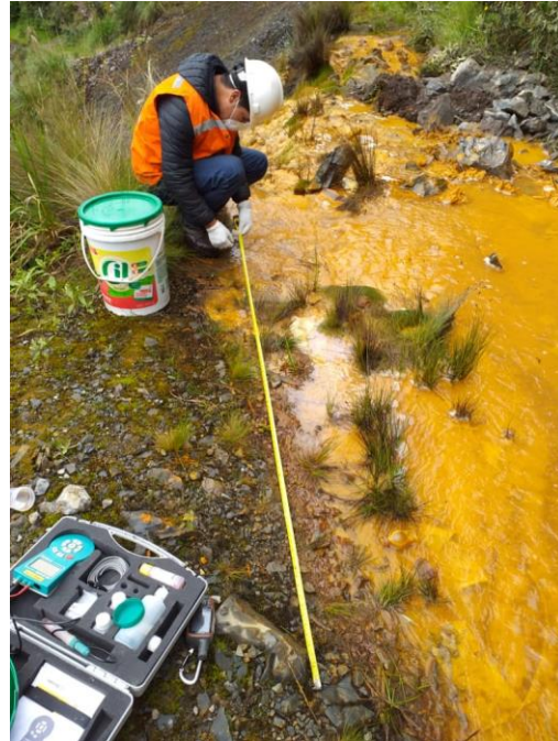
fotografía N° 8: toma de muestra de DAM
