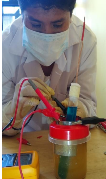
Fotografía N°22: proceso de tratamiento de electrolisis de DAM.
