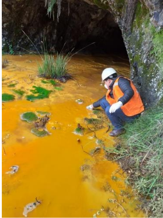
fotografía N°8: toma de muestra de DAM
