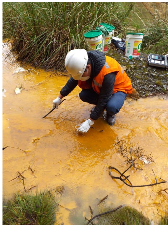
fotografía N° 8: toma de muestra de DAM
