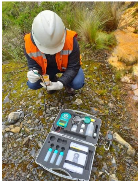
fotografía N°9: toma de Ph del DAM
