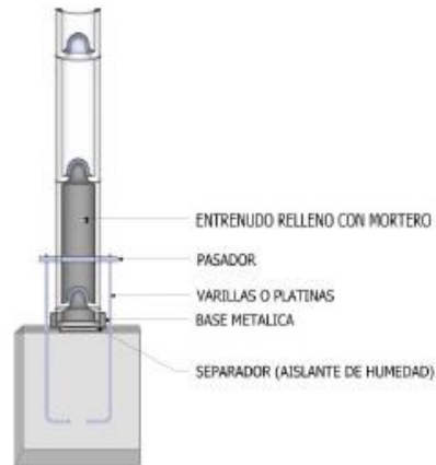
Figura 25. Unión de Anclaje Externo
