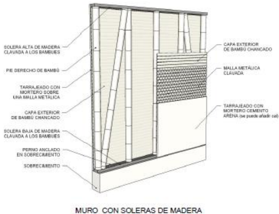
Figura 18. Muro con soleras de madera.
