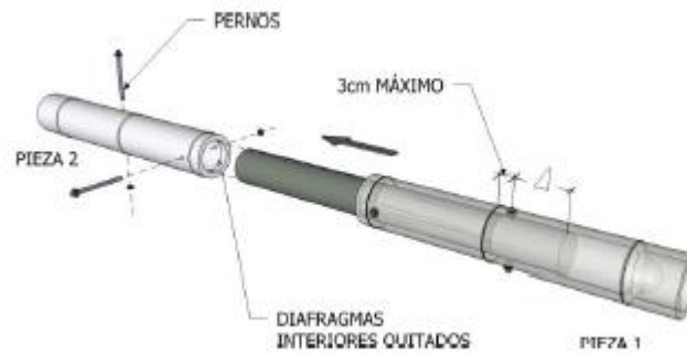
Figura 13. Uniones de dos piezas con maderas
