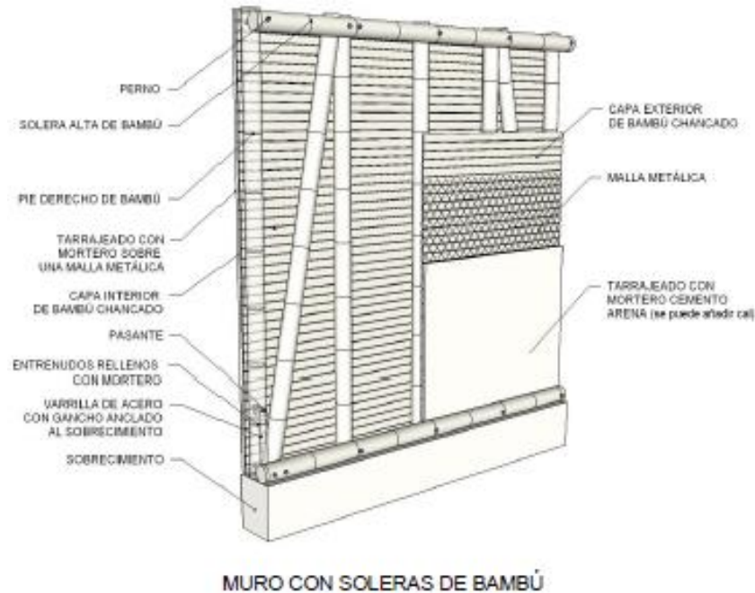
Figura 19. Muro con soleras de bambú.
