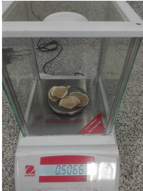
Figura 45. Determinación de SST en el laboratorio.
