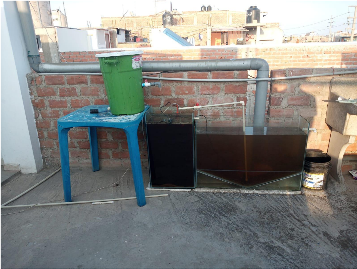
Figura 7. Sistema de lodos activados a escala de laboratorio construido.
