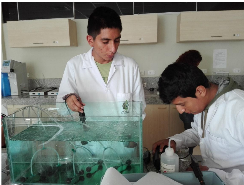
Figura 48. Ensayo de determinación de transferencia de oxígeno de las bombas de aire.
