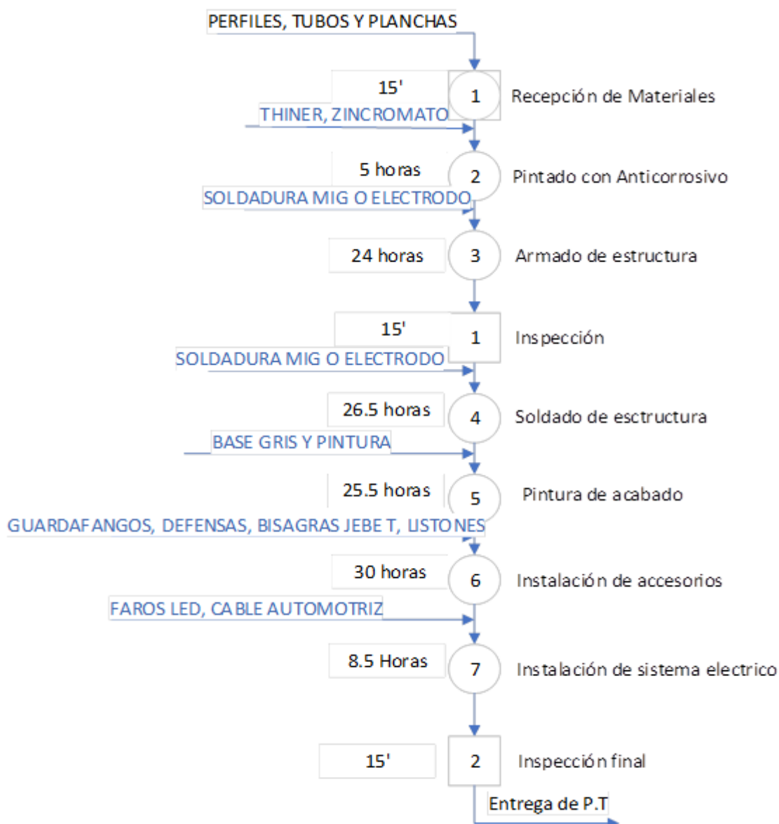
Figura 15. Proceso de fabricación de furgón liso de 2 toneladas
