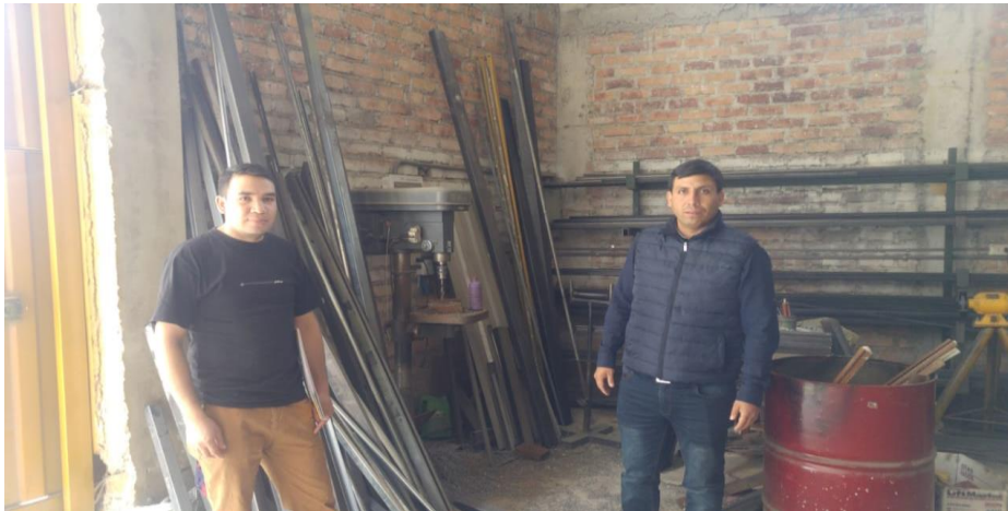
Figura 8: No existe señalizaciones, mapa de riesgos, un plan de orden y limpieza lo que contribuye a una mayor exposición ante riesgos de caídas, electrocución, aplastamiento de dedos, cortes, etc.
