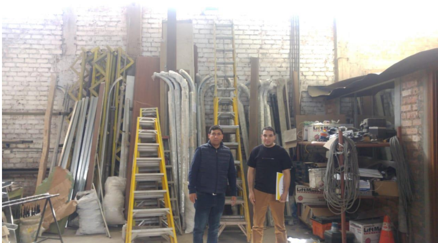
Figura 7: Las áreas no están definidas. Como puede apreciarse en la figura la materia prima y estructuras metálicas no están adecuadamente almacenadas, lo que puede generar aplastamiento, atrapamiento, golpes, heridas, contusiones, fracturas, esguinces, luxaciones, muerte.
