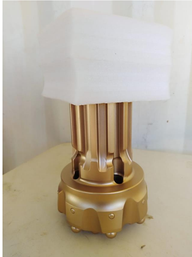
Foto 1: Broca ROCK 66 Domo 6 \frac{3}{4} "con 3 orificios.
