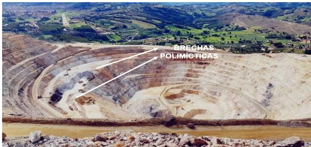
Ilustración 1: Zonificación de la brecha aflorando dacita sulfurada
