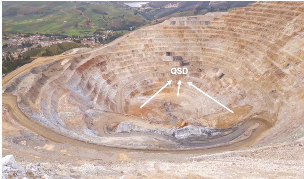
Ilustración 2: Zonificación del QSD de alta silificación.
