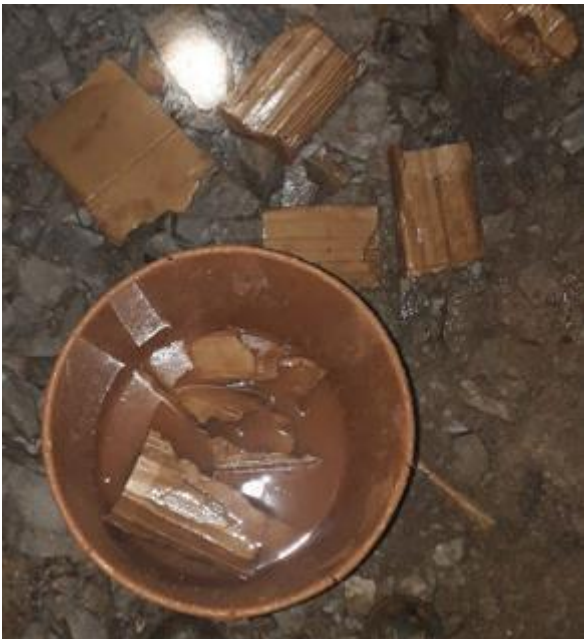
Para el taco se utiliza cartón y partes de saco minero.
