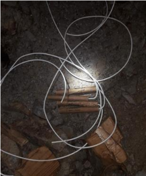
El cebo o caña (dinamita, fulminante N°8 y guía de seguridad).
