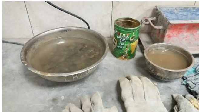
Figura 6: Saturación del Agregado- Peso Especifico
