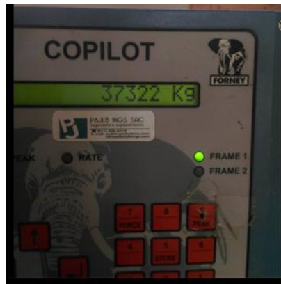
Figura 12: Valor de la resistencia a la compresión en kilogramos
