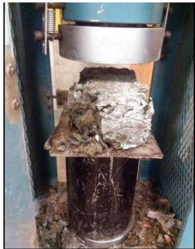
Figura 11: ensayo de resistencia a la compresión de los adoquines
