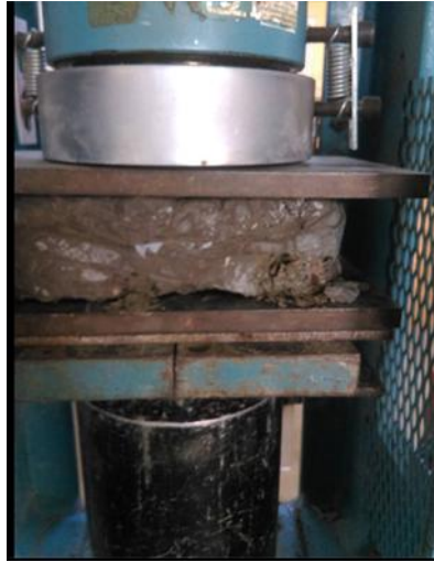
Figura 10: Ensayo de adoquines
