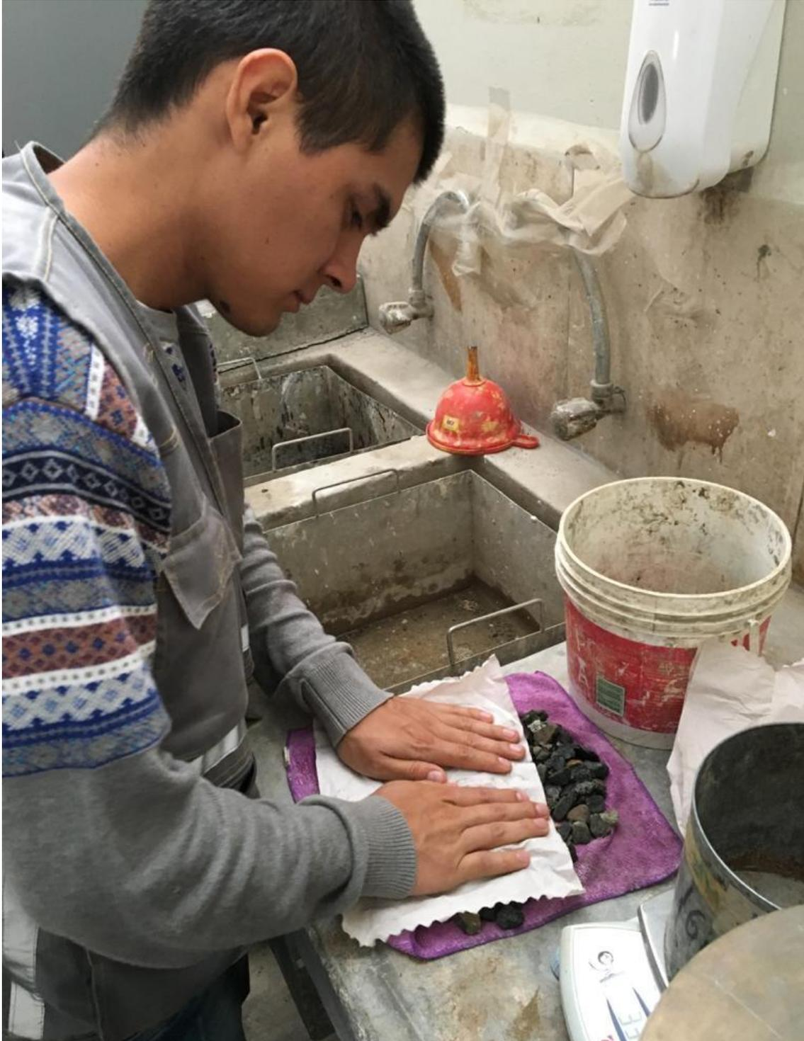
*Figura 34: Muestra saturada superficialmente seca*
