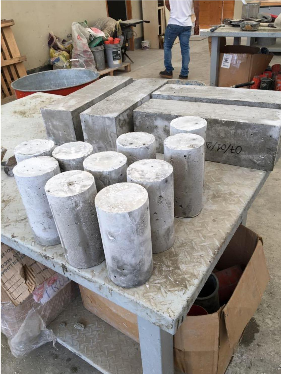
*Figura 45: Secado de probetas y vigas de concreto*
