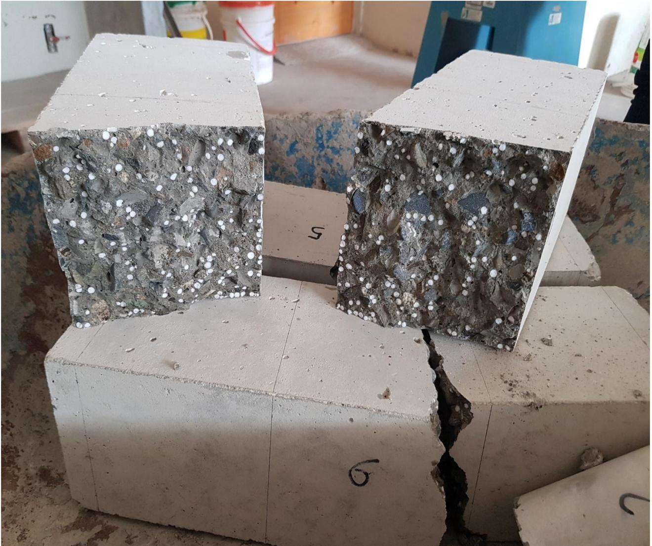
*Figura 53:* Distribución de las perlas de poliestireno en la viga de concreto en estado endurecido
