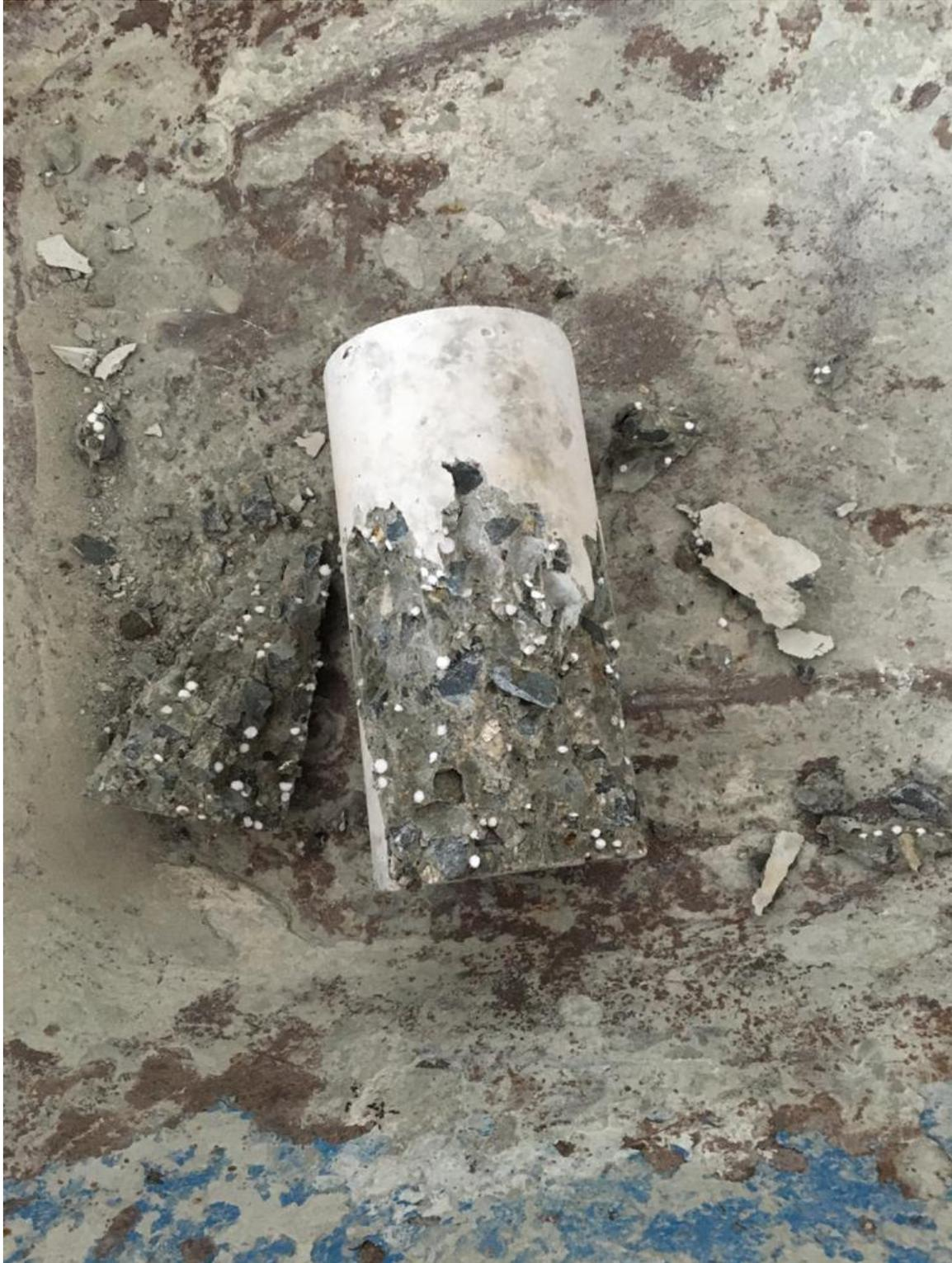
*Figura 51:* Distribución de las perlas de poliestireno en la probeta de concreto en estado endurecido
