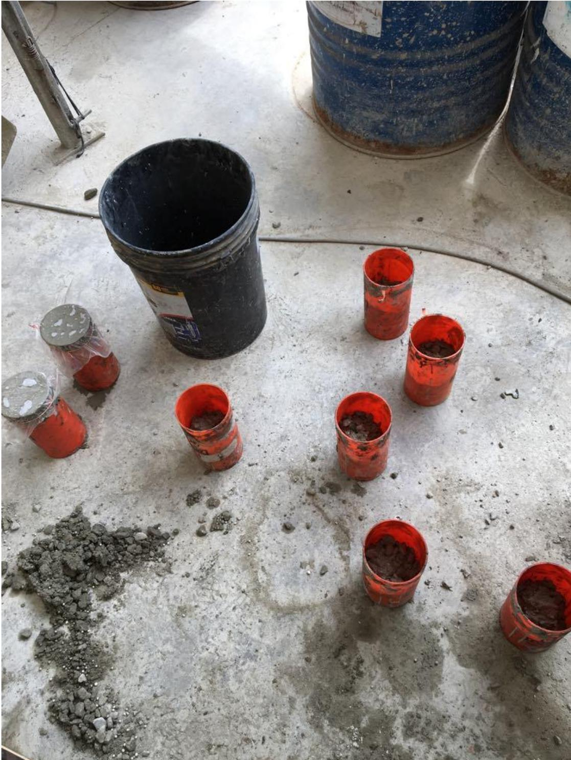
*Figura 41:* Elaboración de probetas de 4x8 pulgadas
