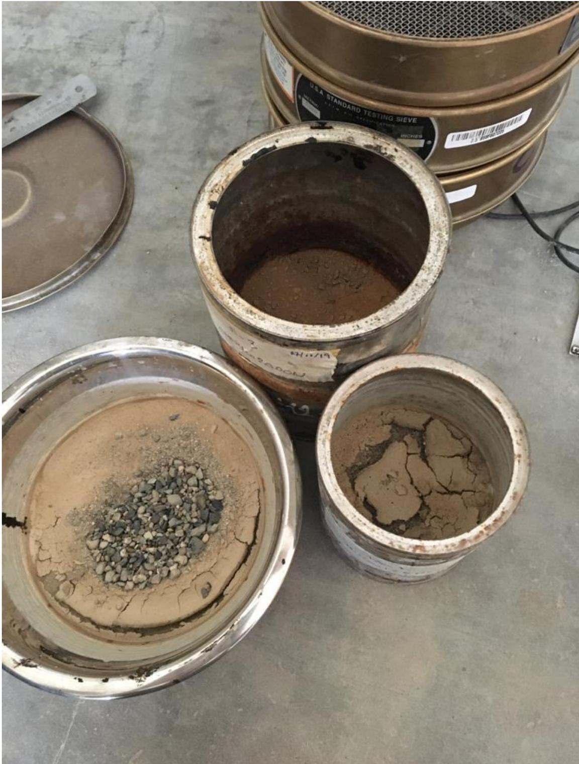
*Figura 33: Peso de la muestra sss del agregado fino*
