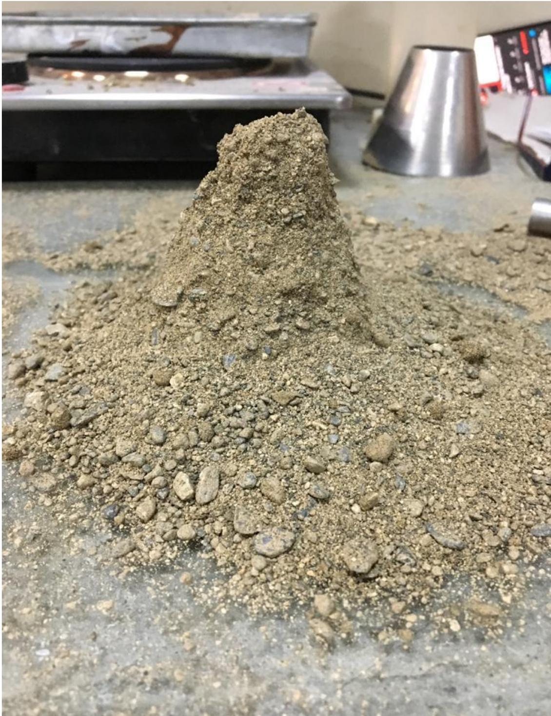
*Figura 31:* Prueba de humedad superficial del agregado fino
