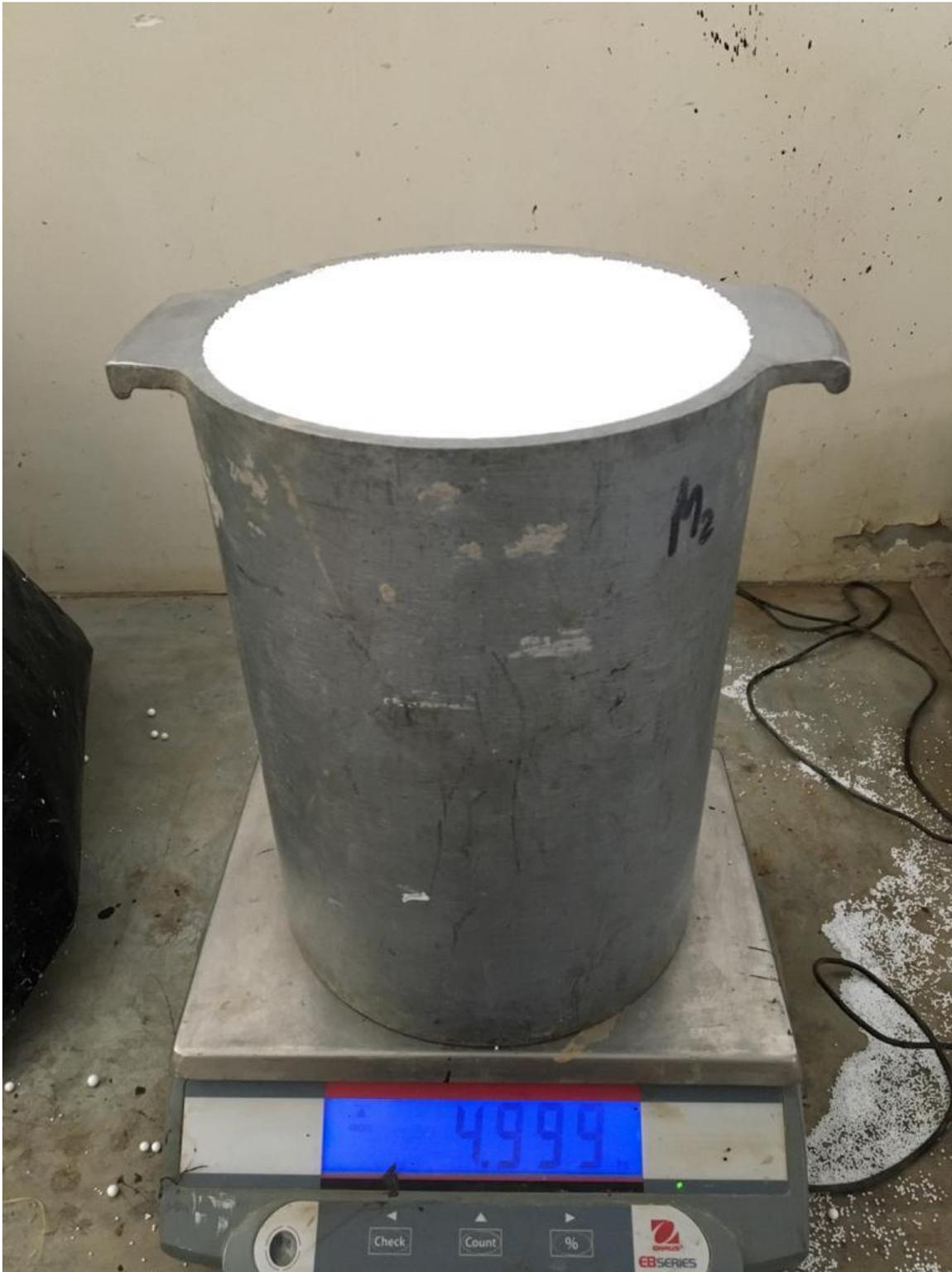
*Figura 29:* Peso unitario suelto de las microperlas de poliestireno
