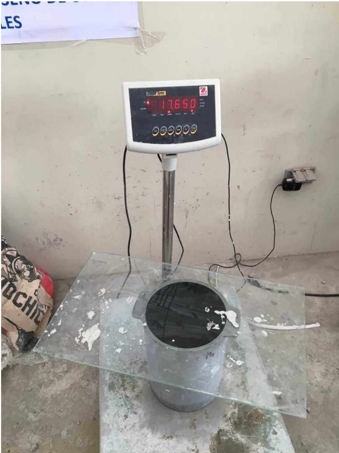
*Figura 30:* Peso del molde + agua + vidrio para el volumen del recipiente
