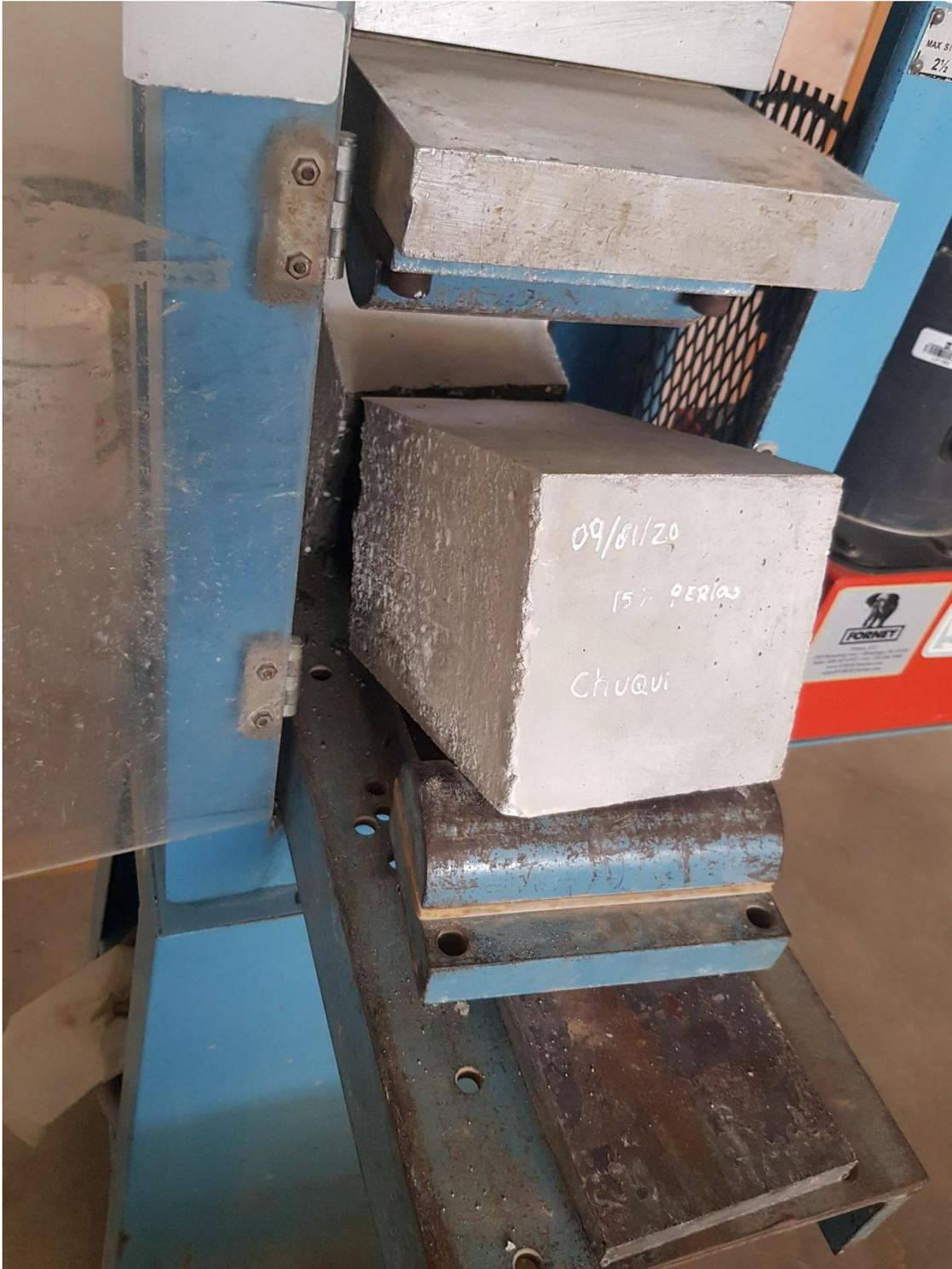
*Figura 52: Resistencia a la flexión del concreto con perlas de poliestireno*
