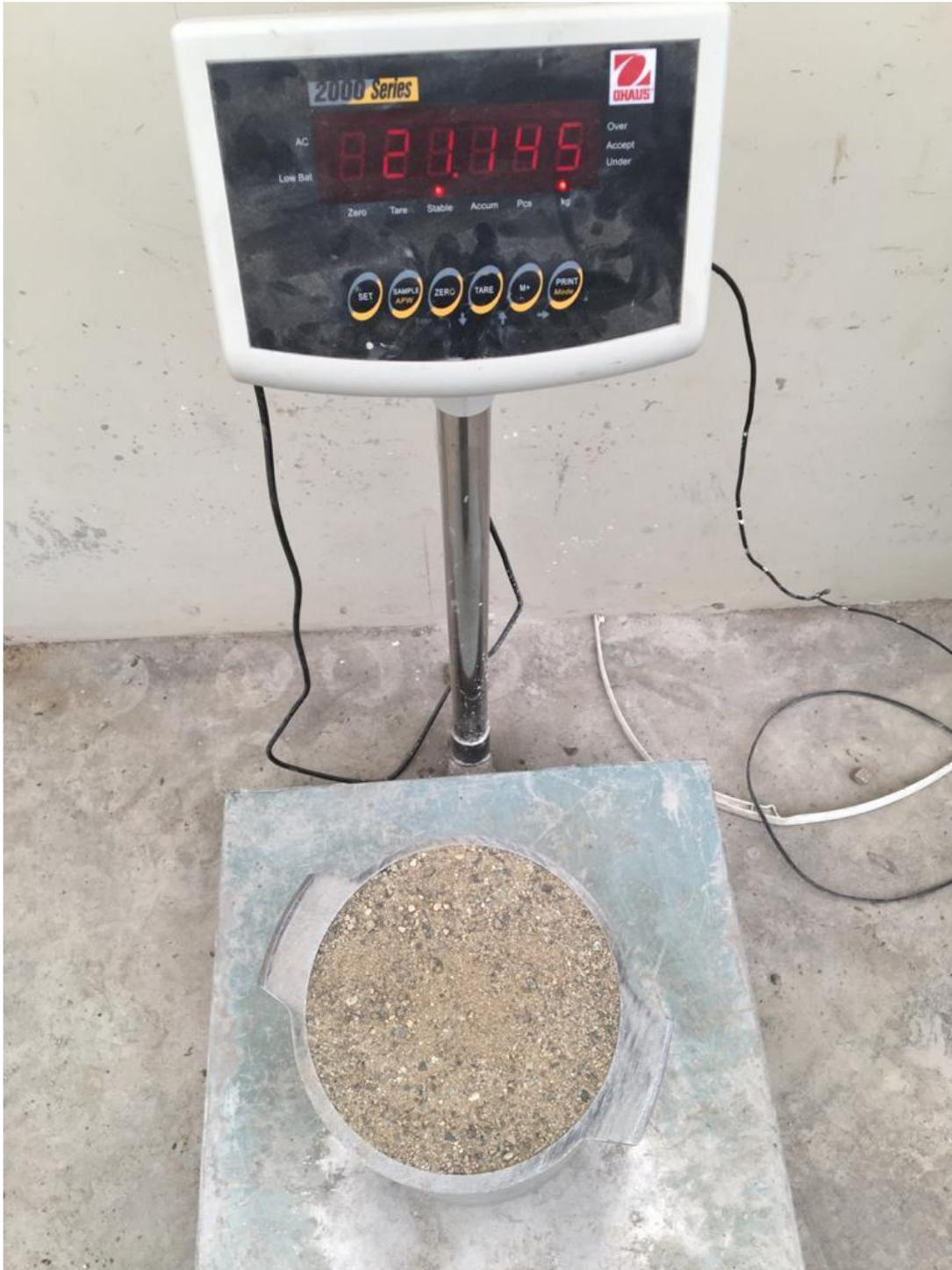
*Figura 24: Peso unitario suelto del agregado fino*
