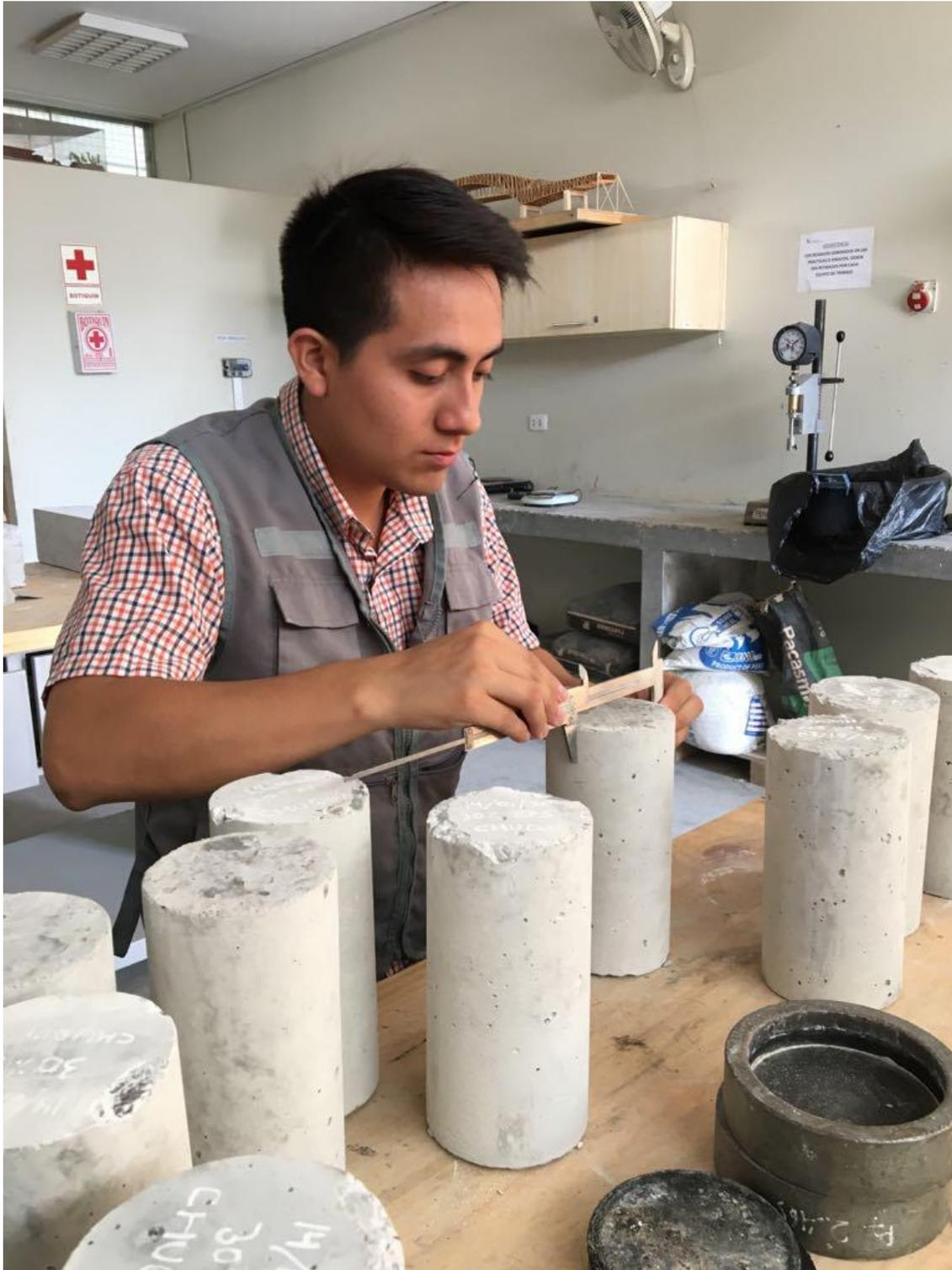
*Figura 46: Medición de probetas de concreto*
