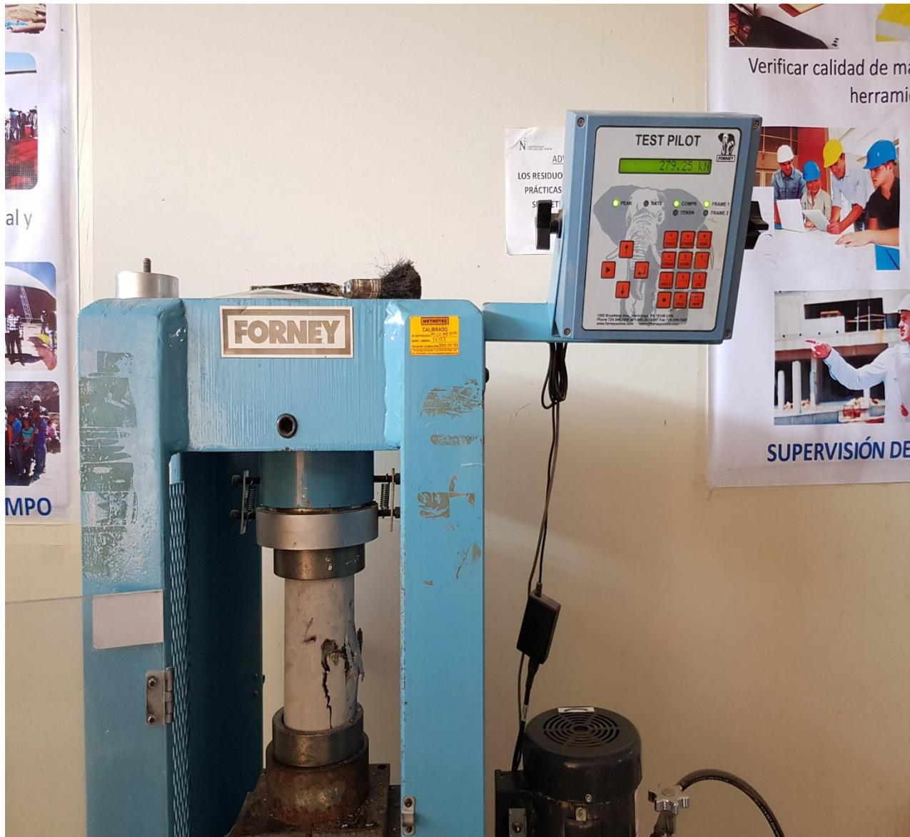
Figura 50: Resistencia a la compresión del concreto con microperlas de poliestireno
