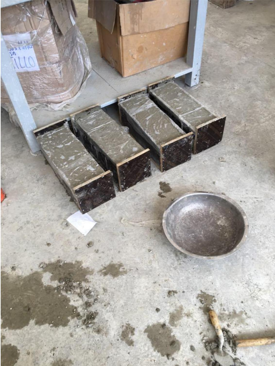
*Figura 42:* Elaboración de vigas de concreto 15x50 centímetros
