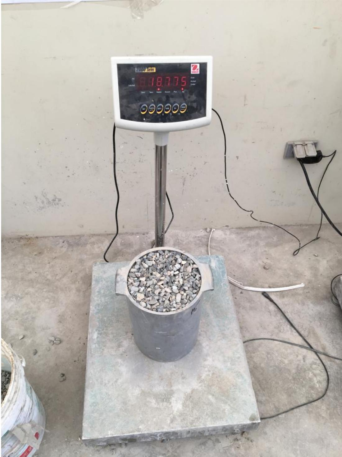
*Figura 26:* Peso unitario suelto del agregado grueso
