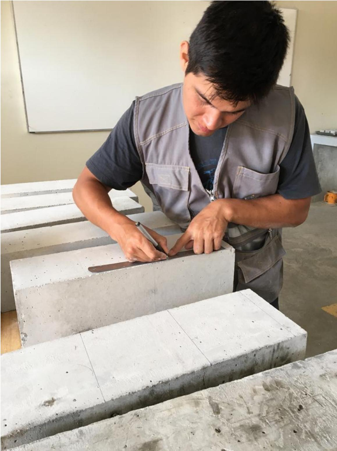
*Figura 47:* Medidas al tercio medio de la viga de concreto
