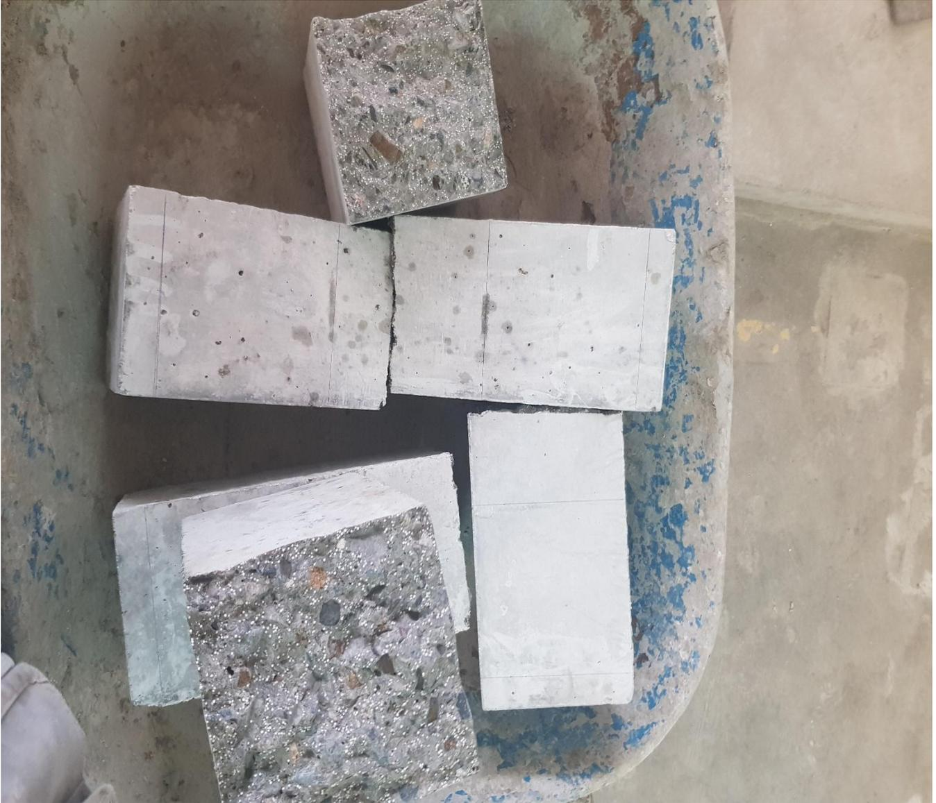
*Figura 54:* Distribución de las microperlas de poliestireno en el concreto en estado endurecido
