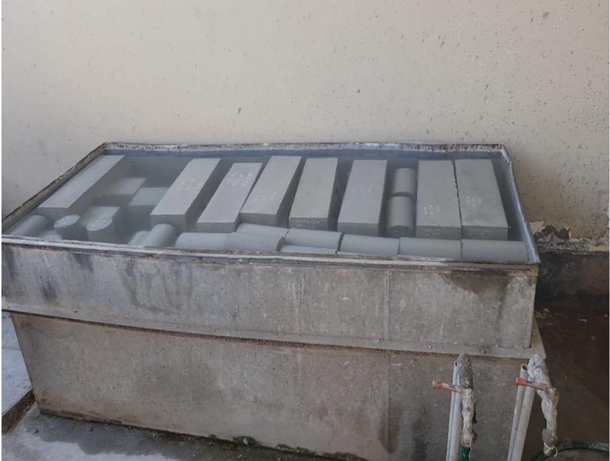
*Figura 43: Curado de probetas y vigas*
