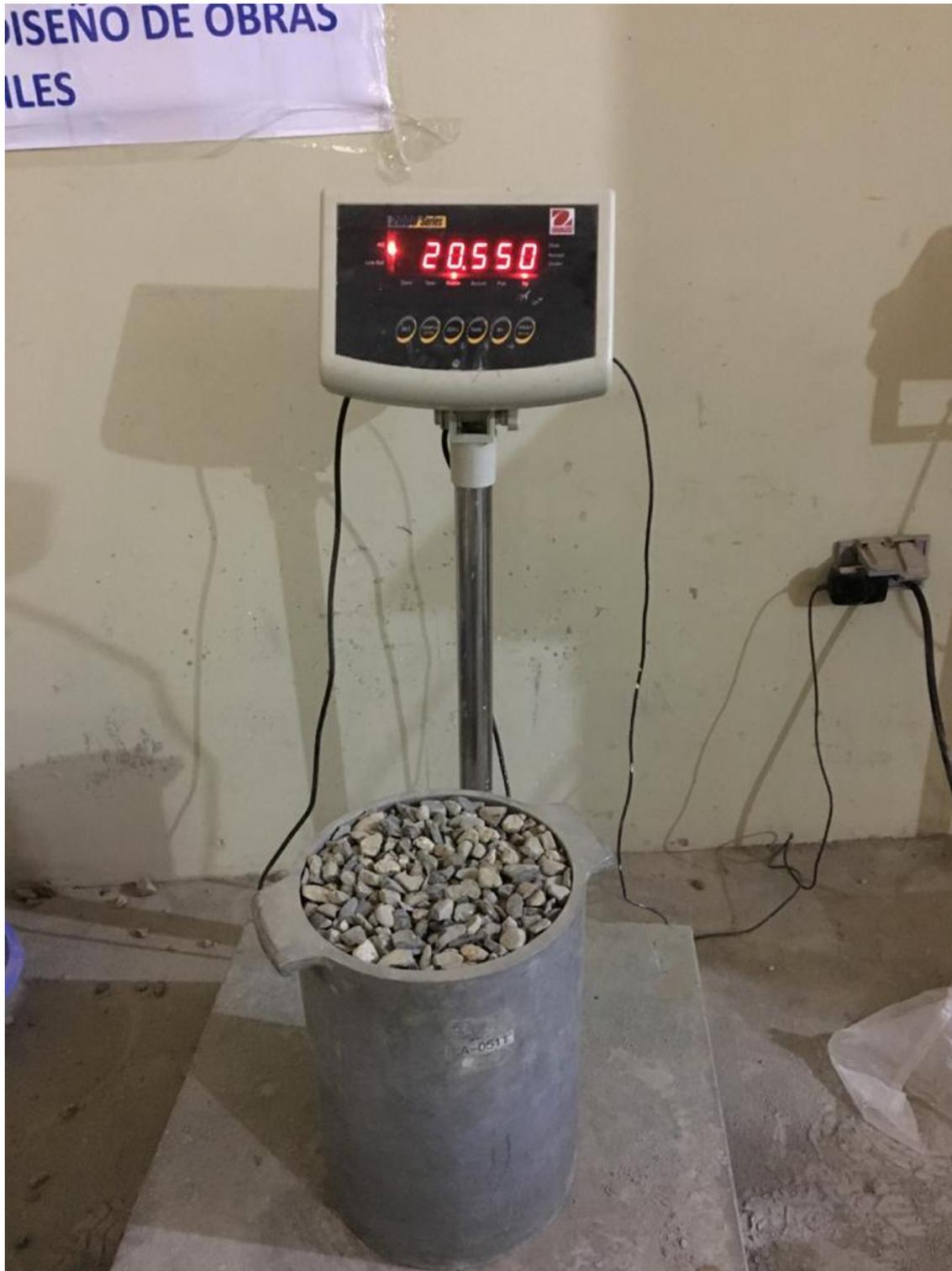
*Figura 27:* Peso unitario compactado del agregado grueso
