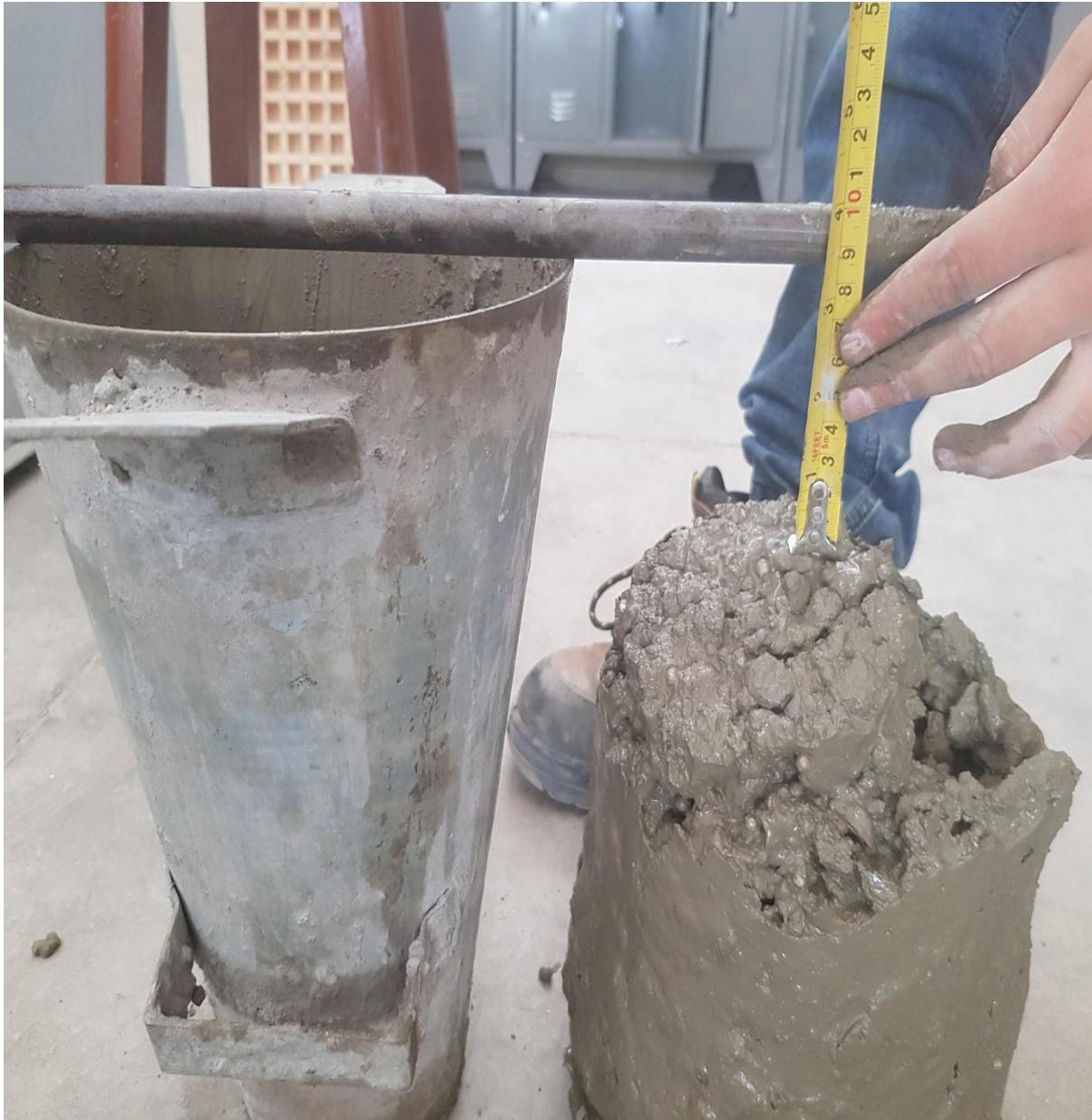
*Figura 39:* Asentamiento del concreto con perlas de poliestireno
