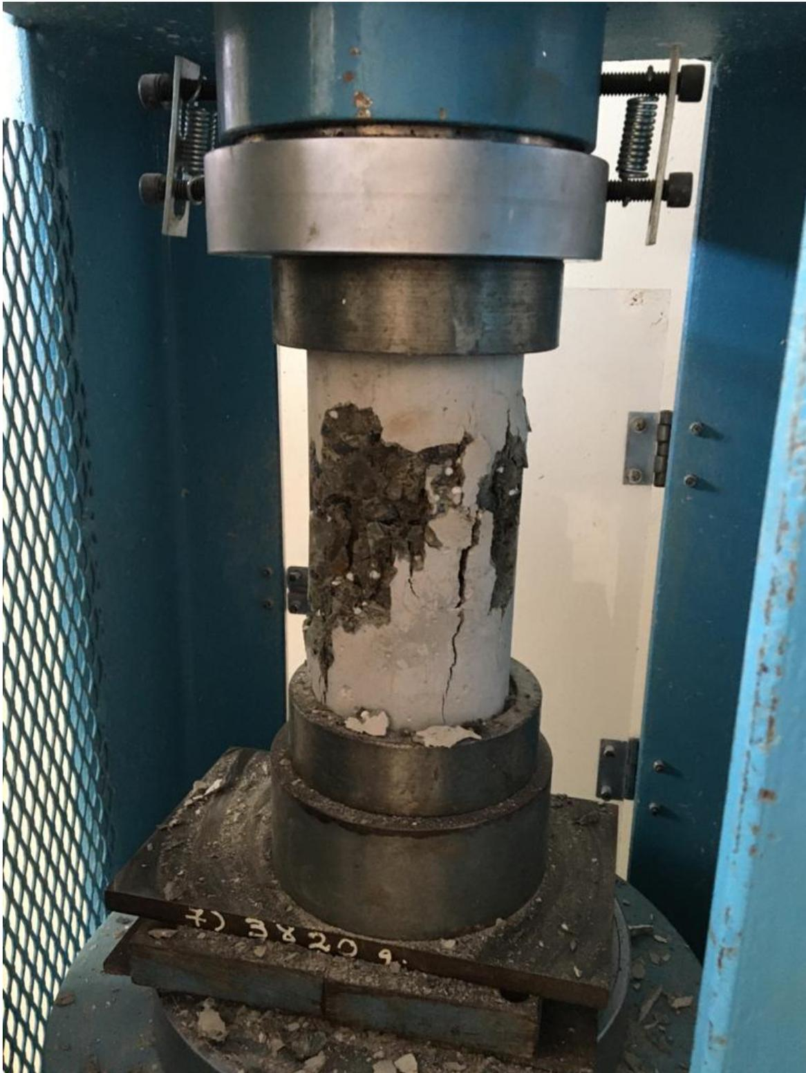
*Figura 49:* Resistencia a la compresión del concreto con perlas de poliestireno
