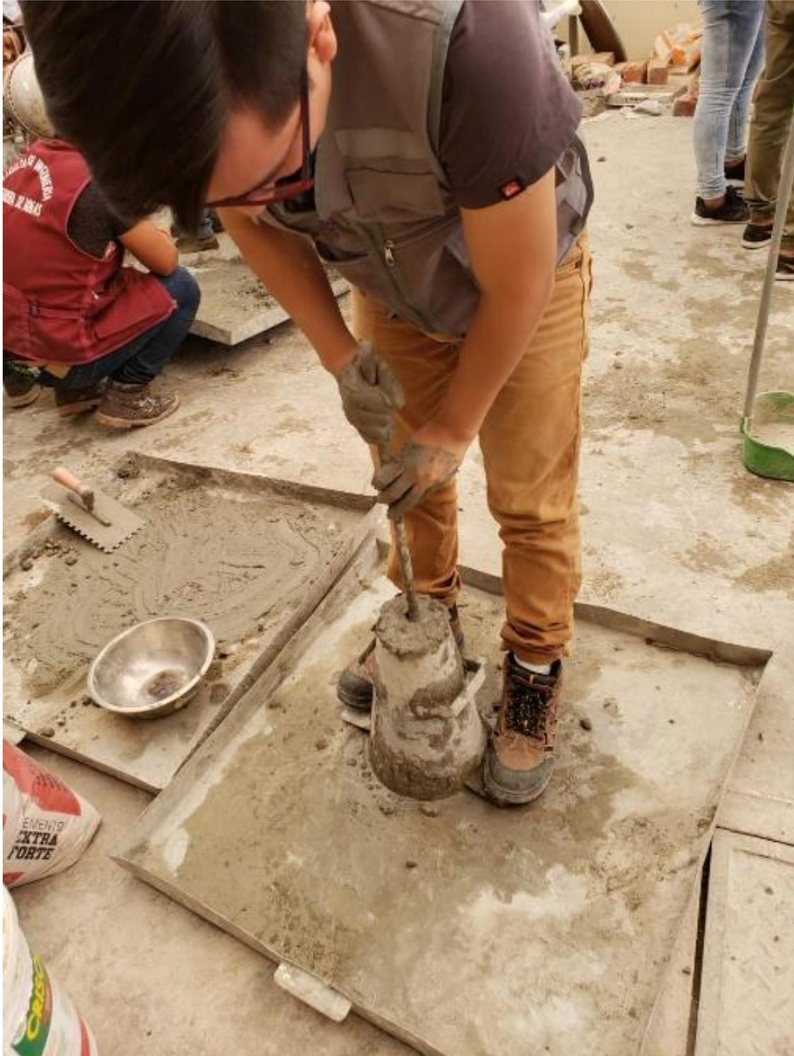
*Figura 36: Asentamiento del concreto convencional*
