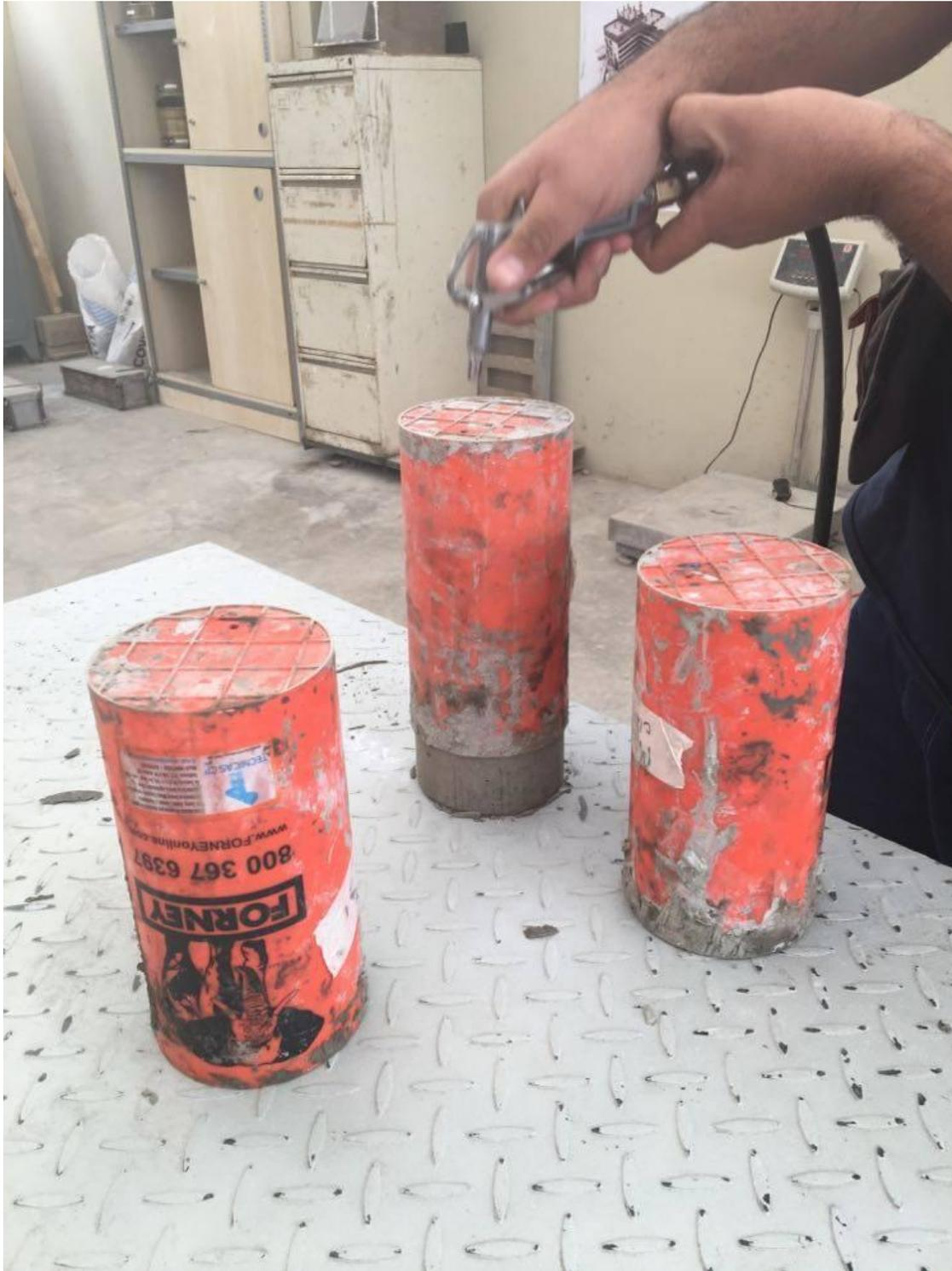
*Figura 44:* Desmolde de probetas
