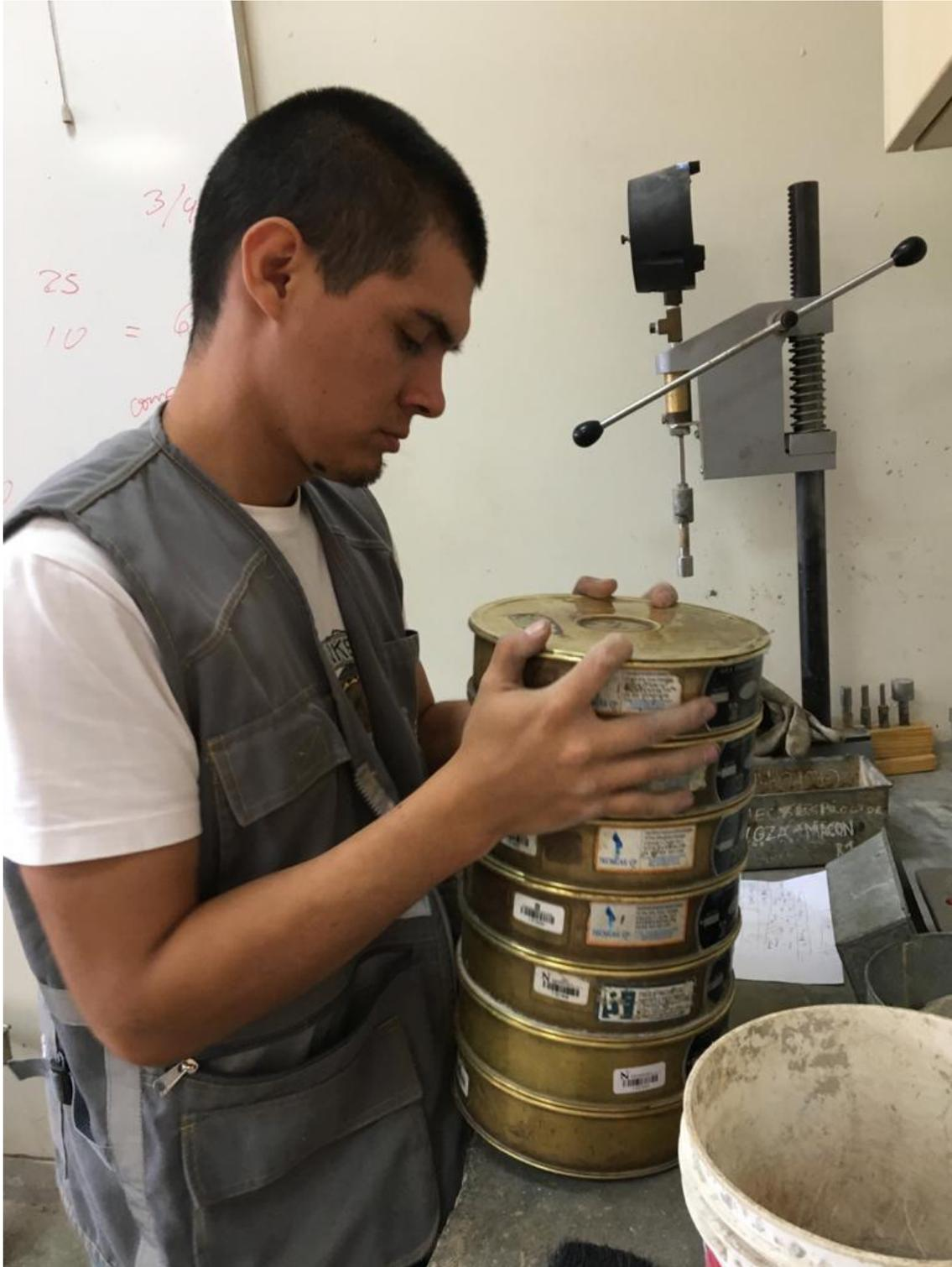
*Figura 22: Análisis granulométrico*
