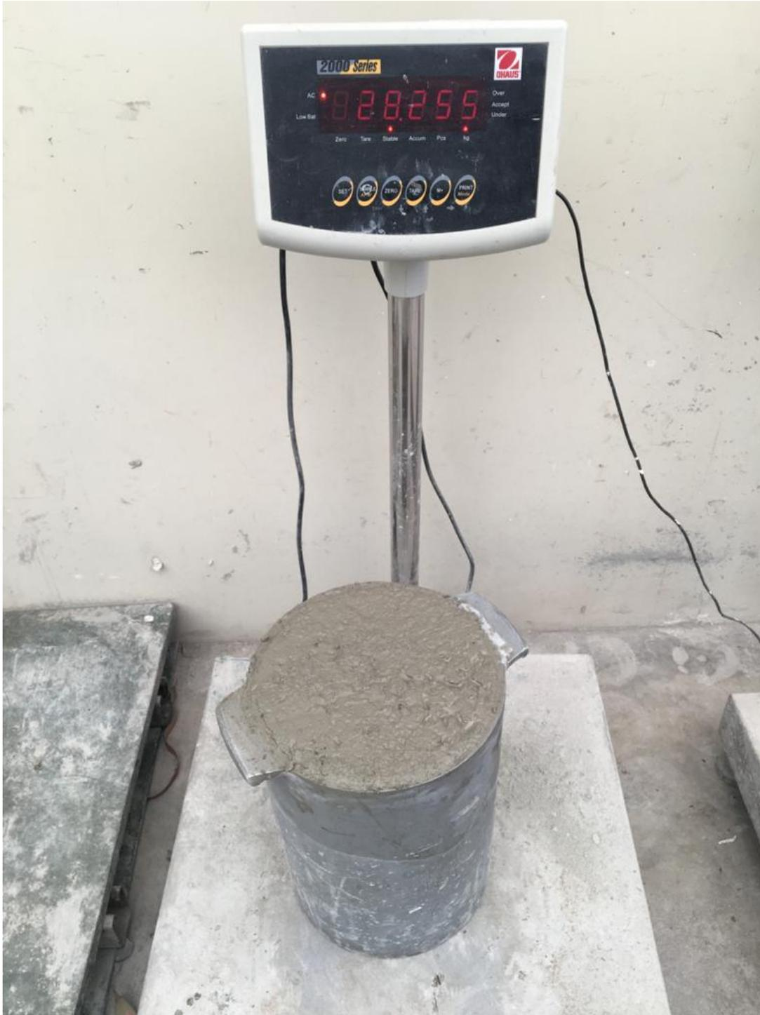
*Figura 37: Peso unitario del concreto convencional*
