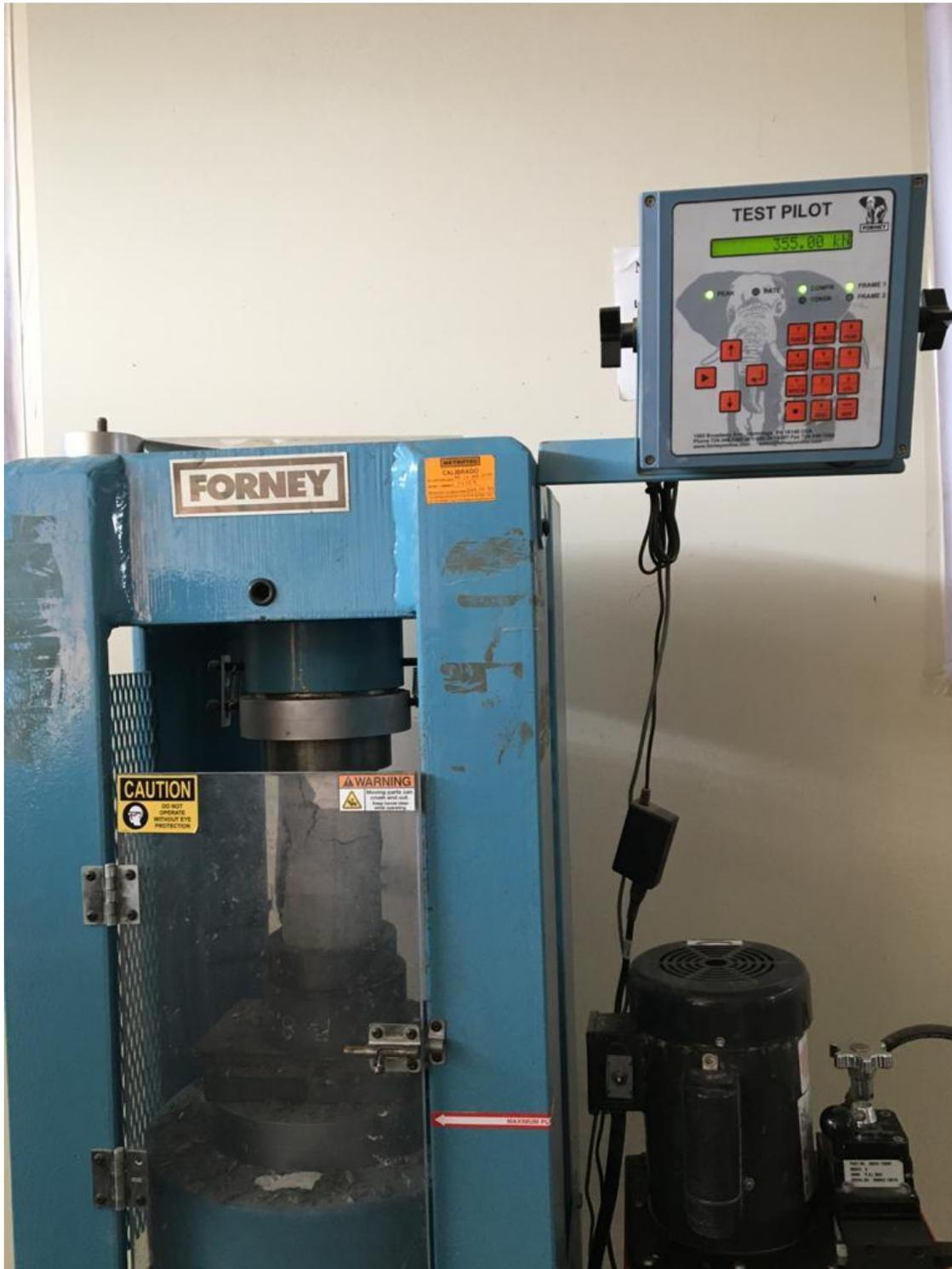
Figura 48: Resistencia a compresión del concreto convencional
