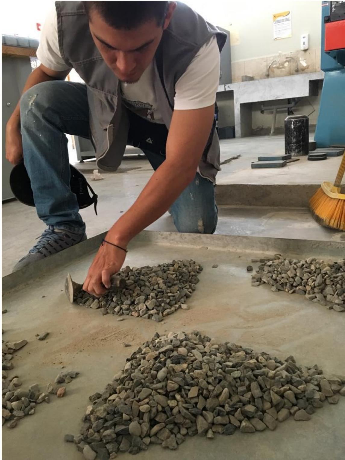
*Figura 21:* Cuarteo del agregado grueso
