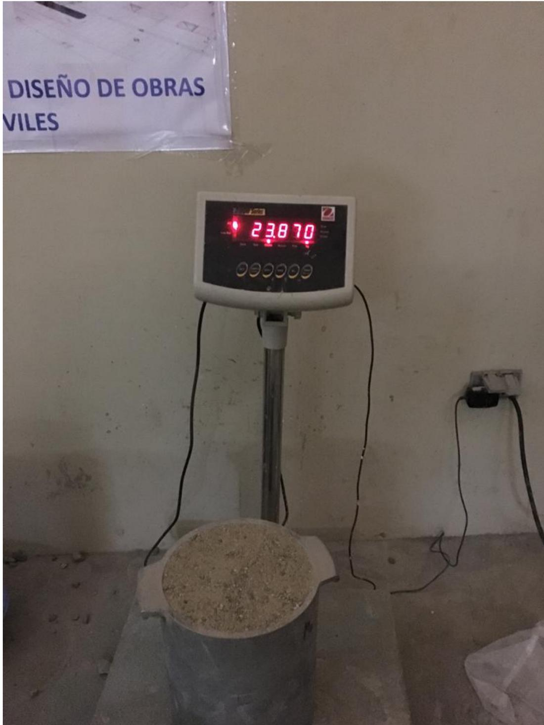
*Figura 25:* Peso unitario compactado del agregado fino
