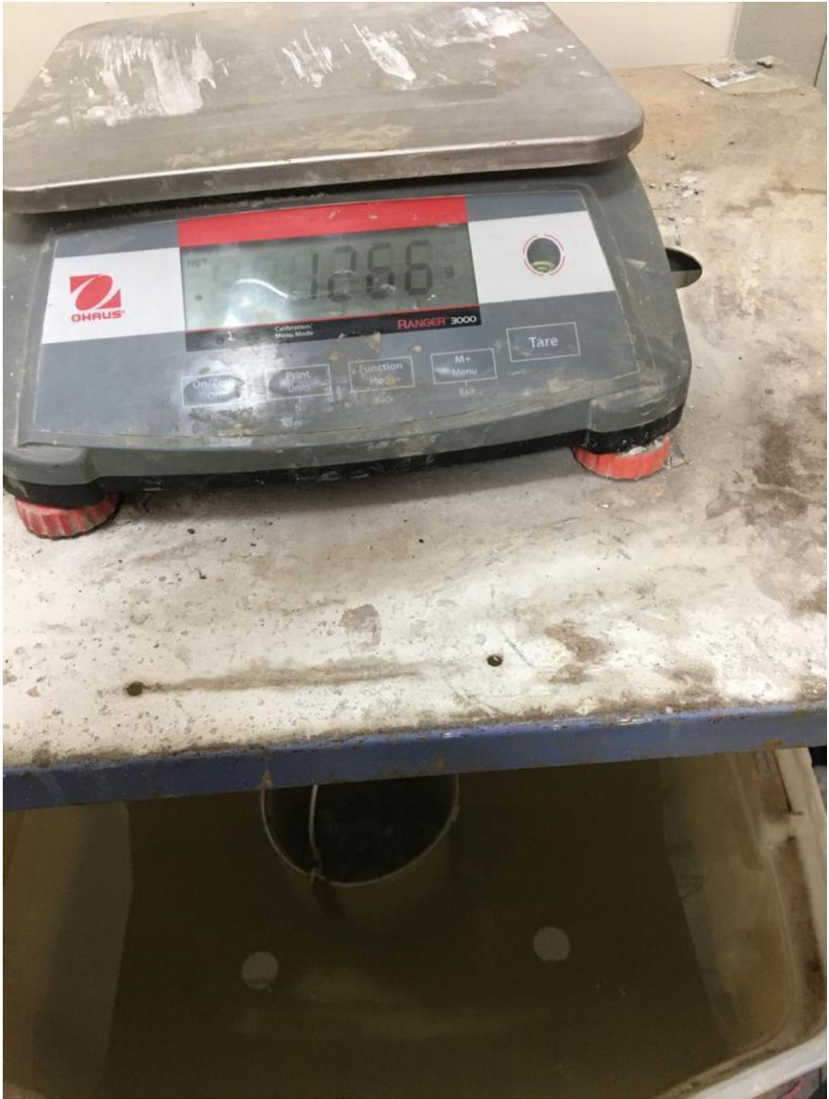
*Figura 35:* Peso de la muestra suspendida en agua
