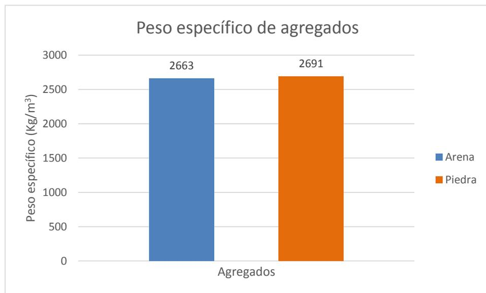
Figura 13: Peso específico ( $\text{kg/m}^3$ ) de los agregados
