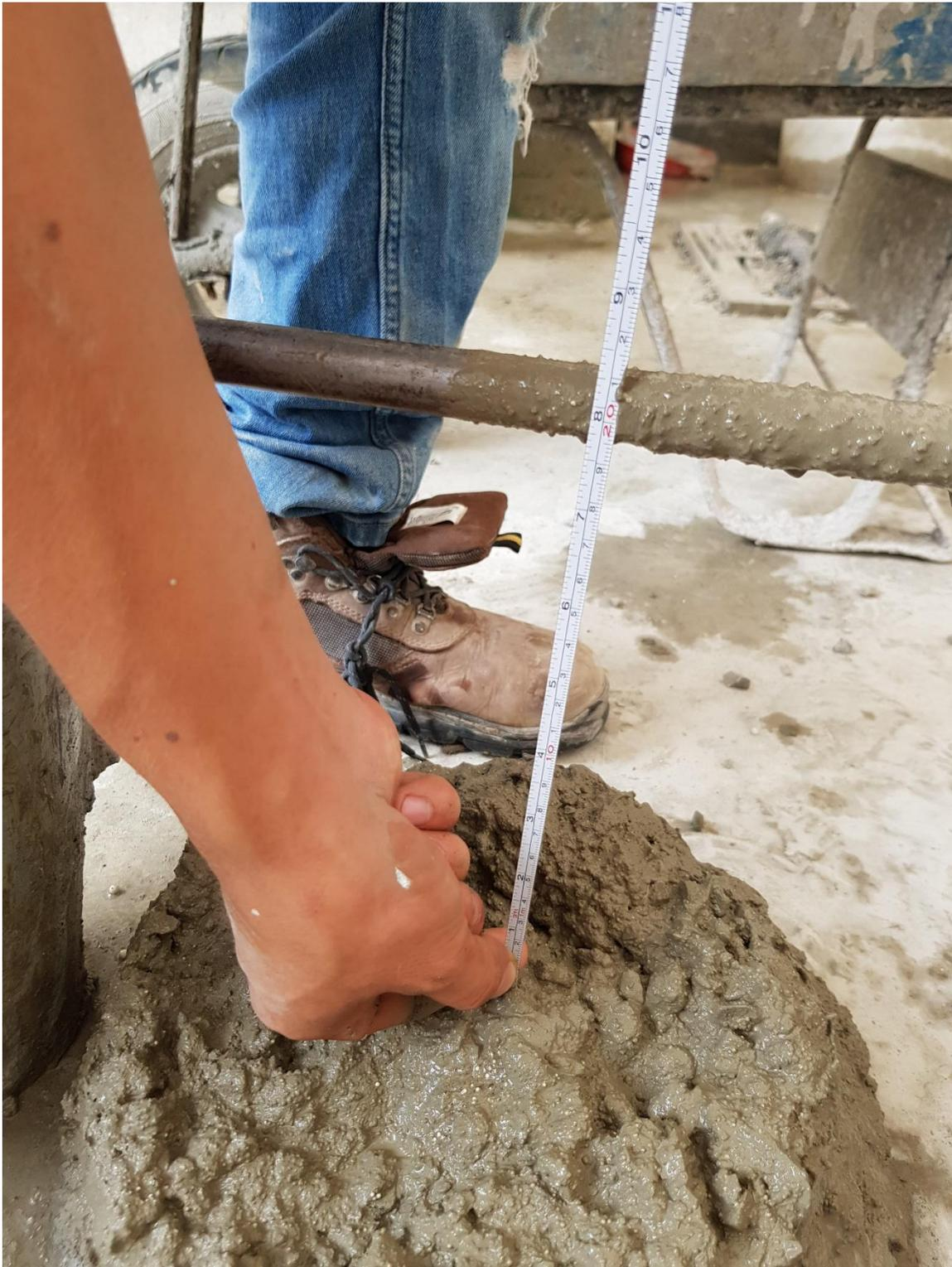
*Figura 40:* Asentamiento del concreto con microperlas de poliestireno
