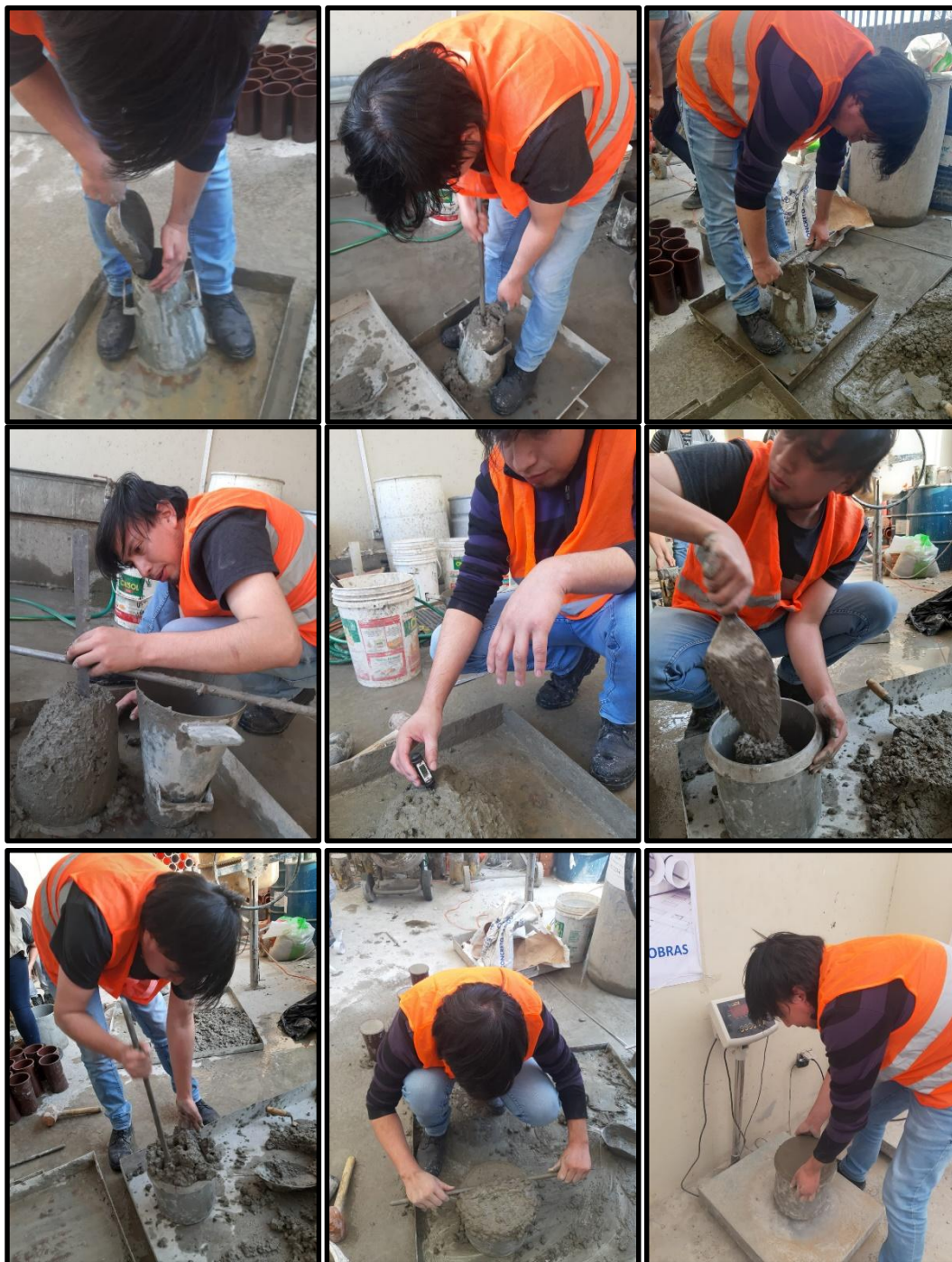
Figura 25. Determinación del asentamiento, temperatura y densidad del concreto tradicional y concreto predosificado seco
