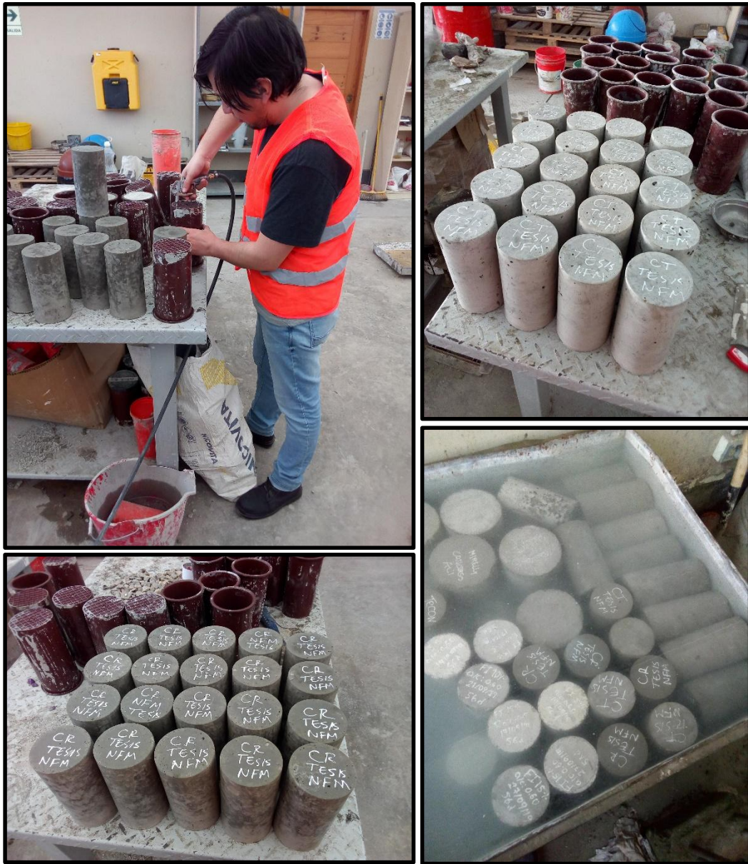
Figura 26. Desencofrado y curado de los especímenes de concreto tradicional y concreto predosificado seco
