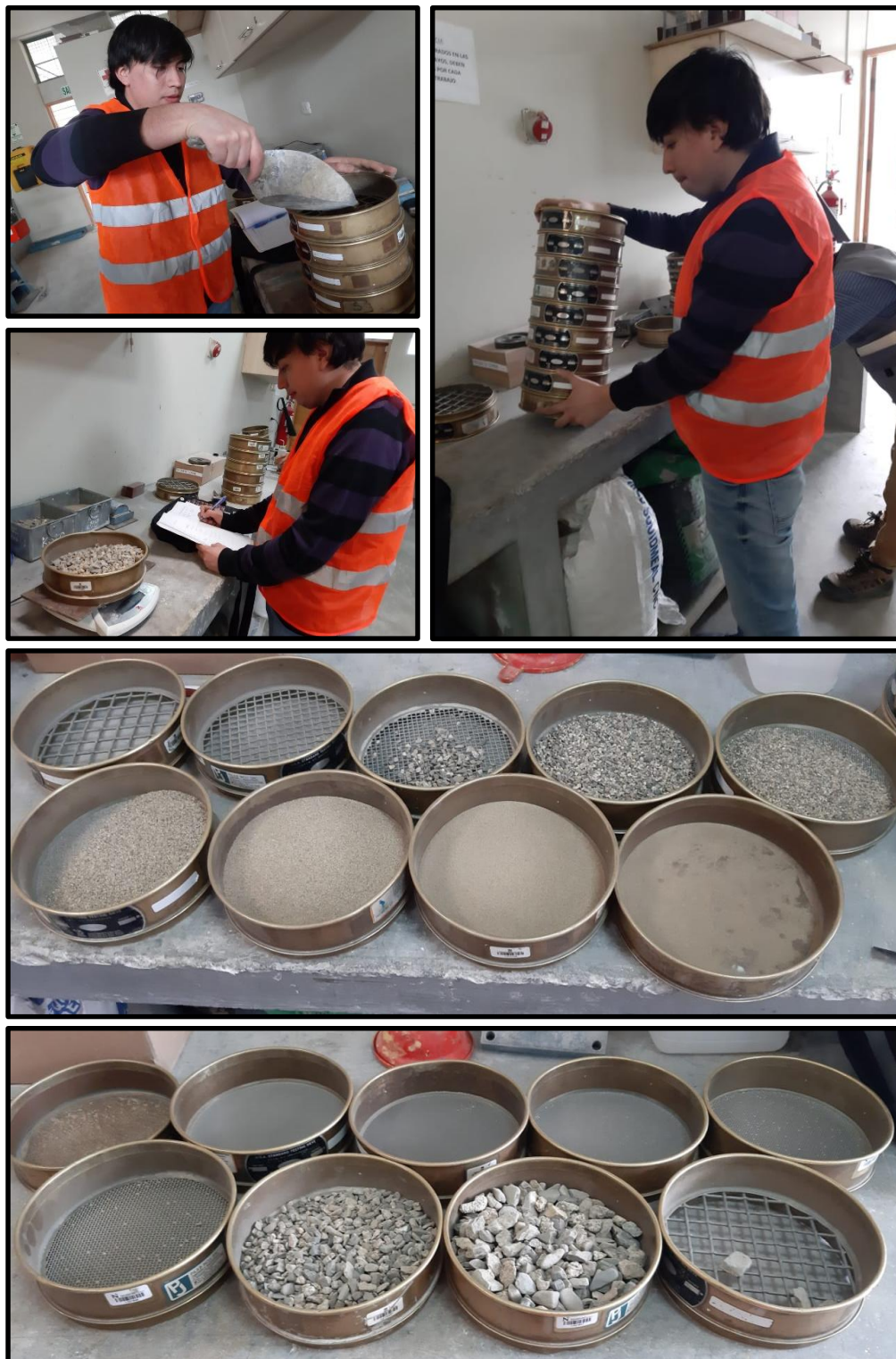
Figura 18. Ejecución del ensayo de granulometría de los agregados
