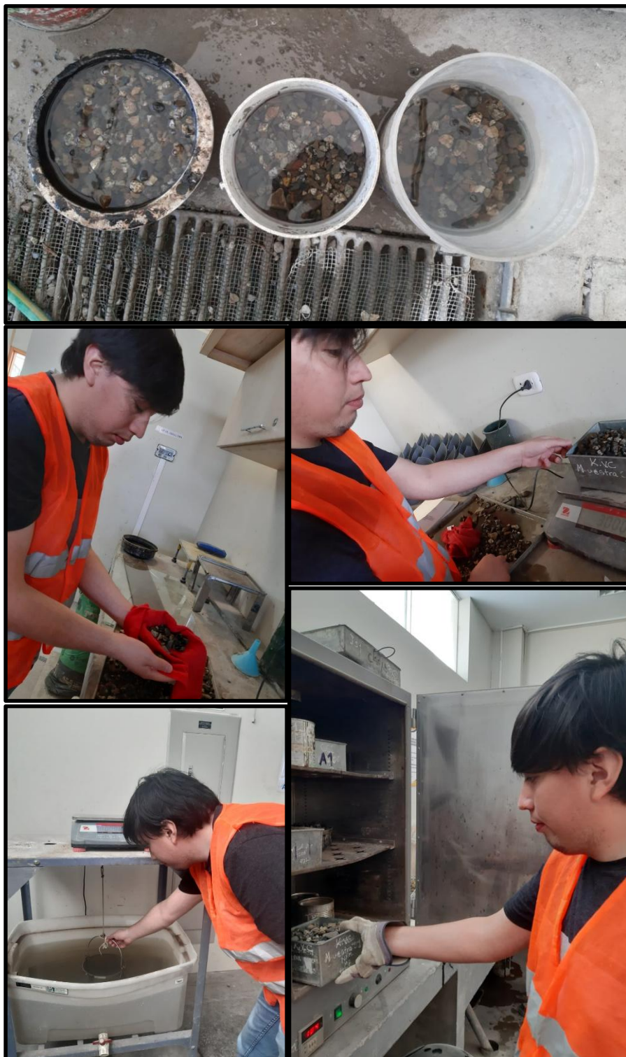
Figura 22. Ejecución del ensayo de densidad relativa del agregado grueso
