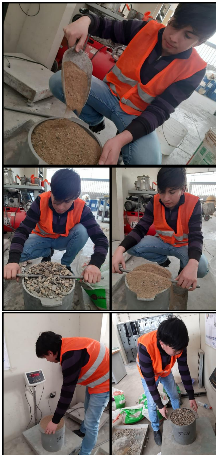
Figura 20. Ejecución del ensayo para determinar la densidad de masa suelta de los agregados
