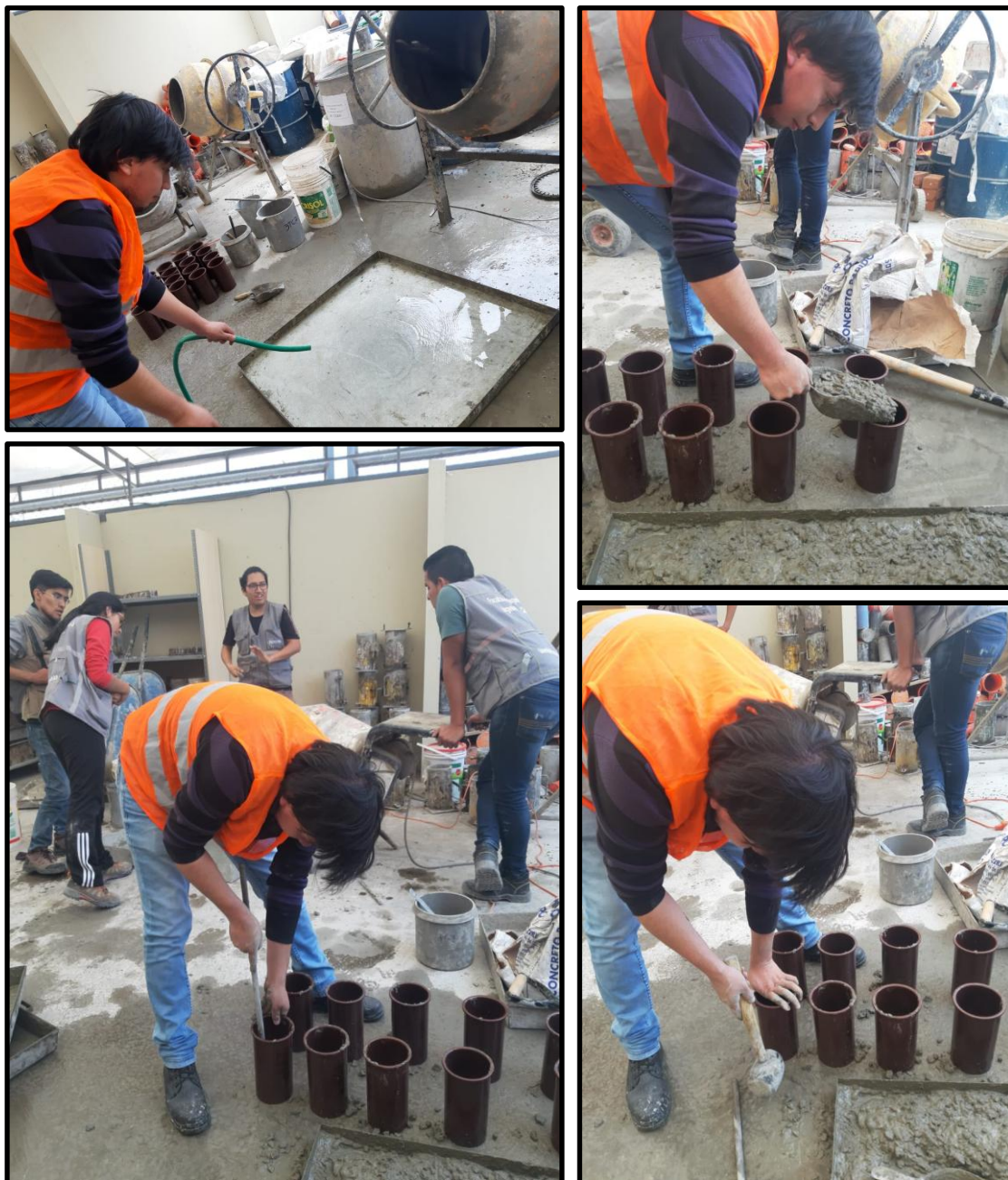
Figura 23. Elaboración de testigos cilíndricos de concreto predosificado seco
