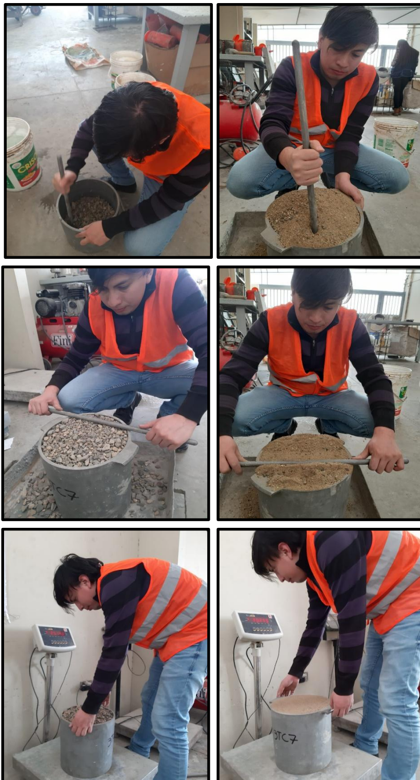
Figura 19. Ejecución del ensayo para determinar la densidad de masa compactada de los agregados
