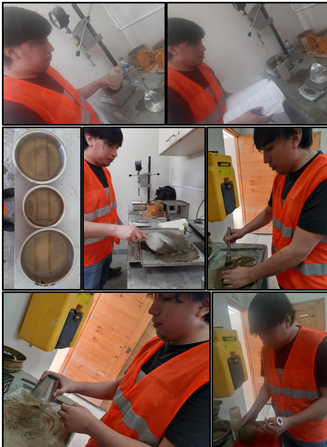
Figura 21. Ejecución del ensayo de densidad relativa del agregado fino
