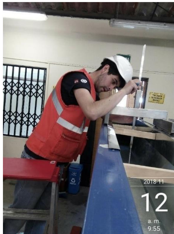
Fotografía 33: Toma de dato en la base del canal trapezoidal
