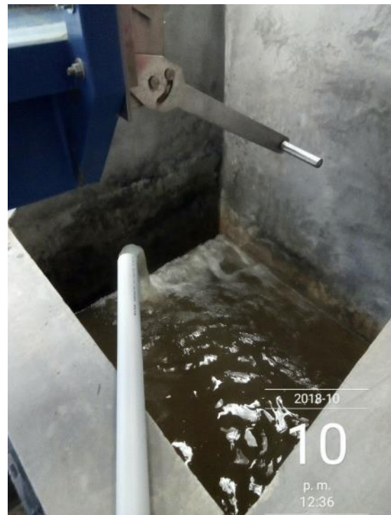
Fotografía 3: Conducción del agua al primer deposito del canal de pendiente variable
