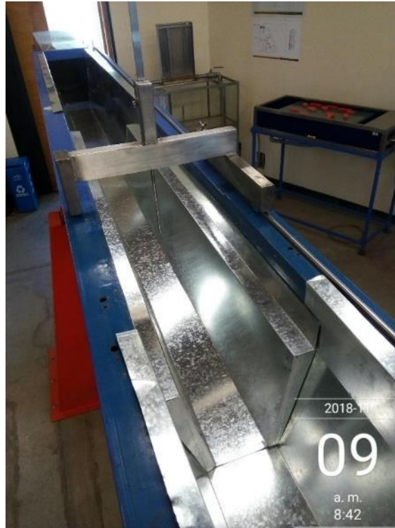
Fotografía 27: Ampliación brusca del canal trapezoidal a un 25%
