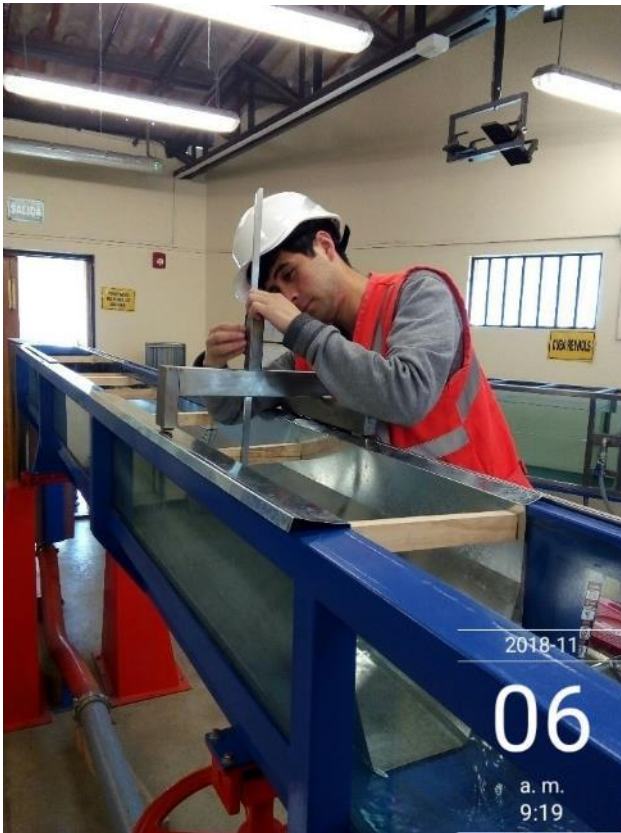
Fotografía 23: Toma de datos del tirante hidráulico en la expansión y altura del vertedero
