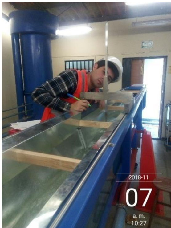
Fotografía 25: Toma de datos del tirante hidráulico en la contracción y altura del vertedero
