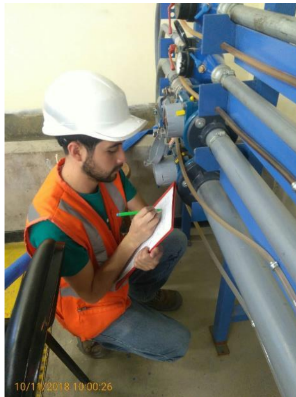
Fotografía 8: Apunte del volumen inicial del micromedidor
