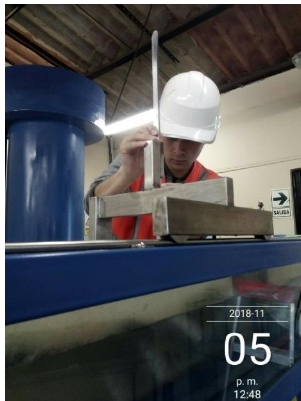
Fotografía 22: Medición del tirante hidráulico
