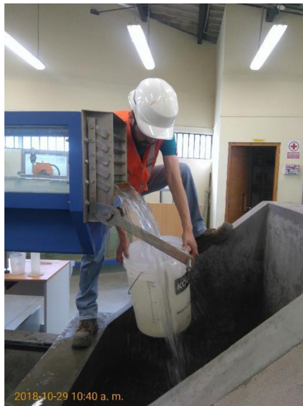
Fotografía 12: Medición volumétrica a la salida del canal de pendiente variable.
