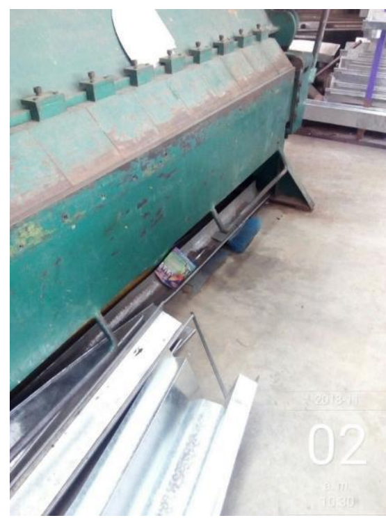
Figura 8. Doblaje de la plancha de acero.
