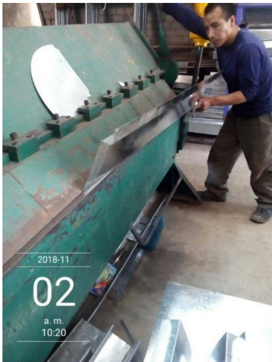
Figura 8. Doblaje de la plancha de acero.
