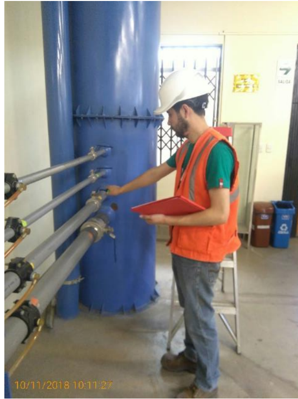
Fotografía 10: Toma de datos, medición de la altura de agua en el vertedero.
