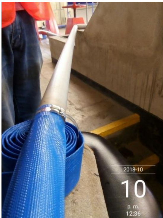
Fotografía 3: Conducción del agua al primer deposito del canal de pendiente variable
