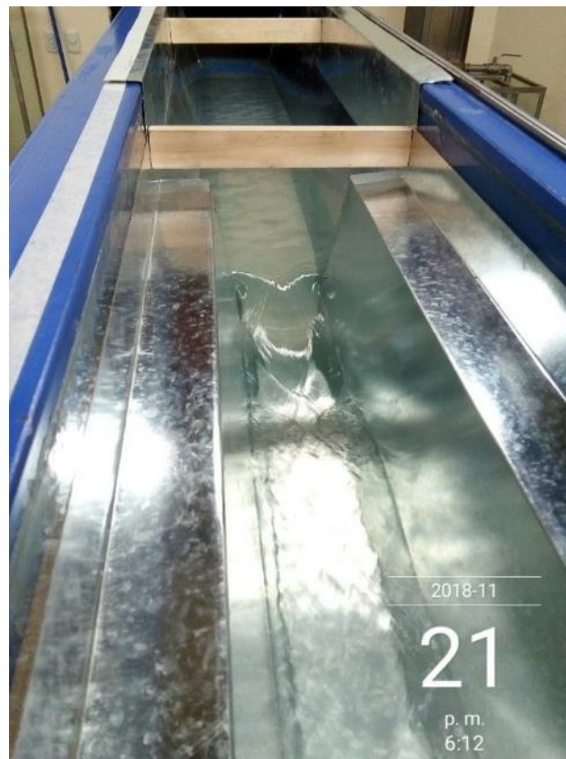
Fotografía 39: Toma de datos cada 5cm para elaboración del perfil de la altura de agua
