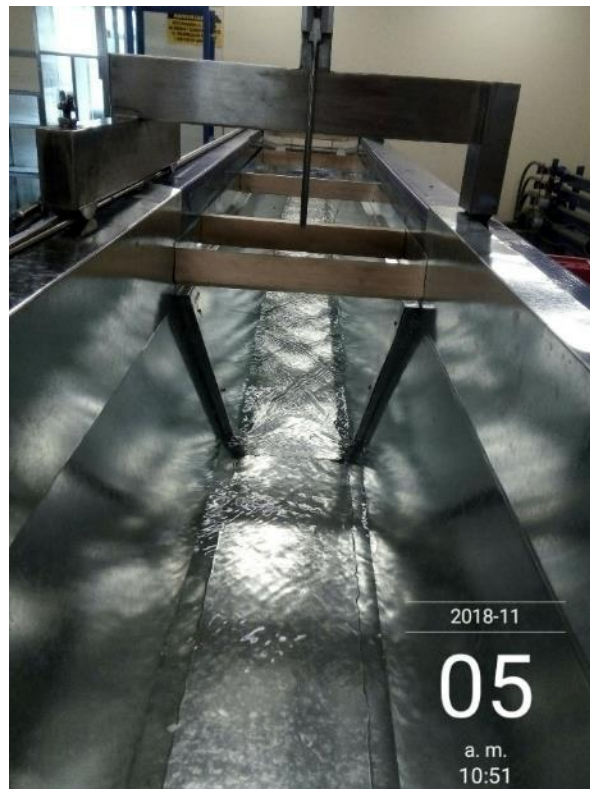
Fotografía 20: Flujo de agua dentro del canal trapezoidal, reducción del ancho de 10%
