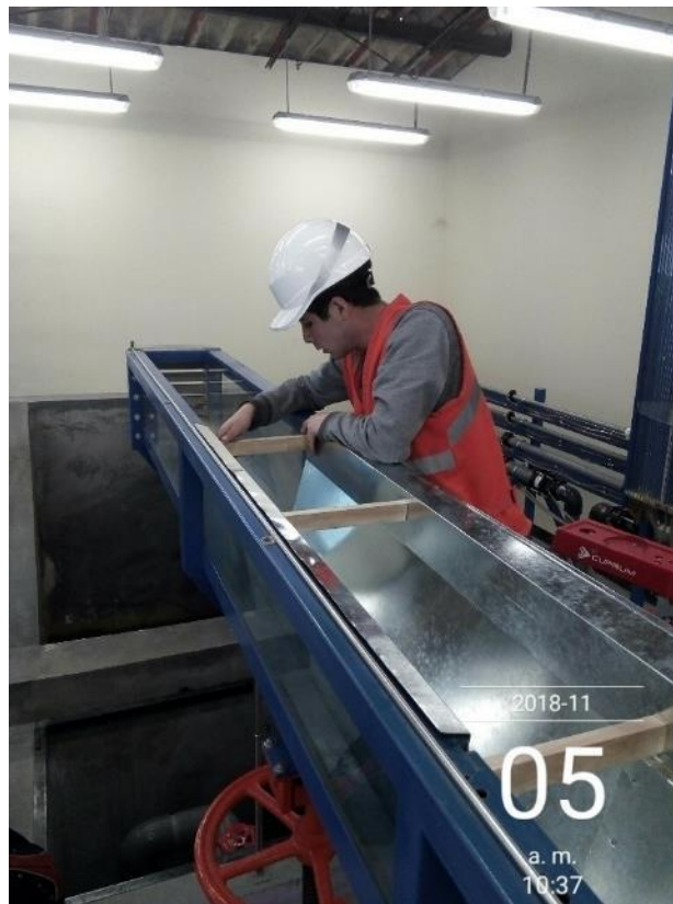
Fotografía 17: Instalación de los canales trapezoidales en el laboratorio
