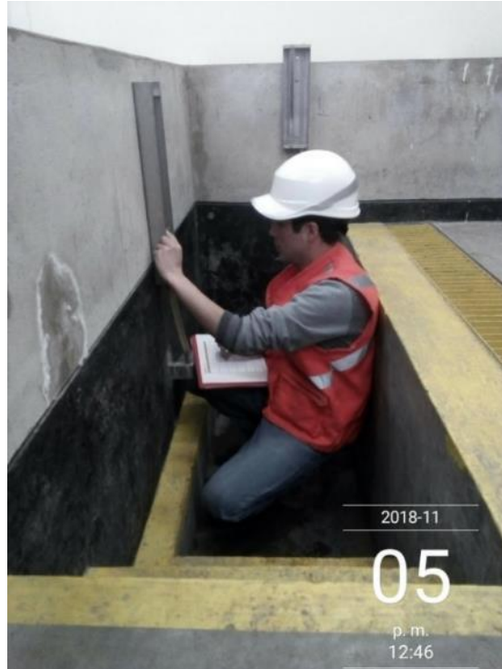
Fotografía 22: Medición del tirante hidráulico
