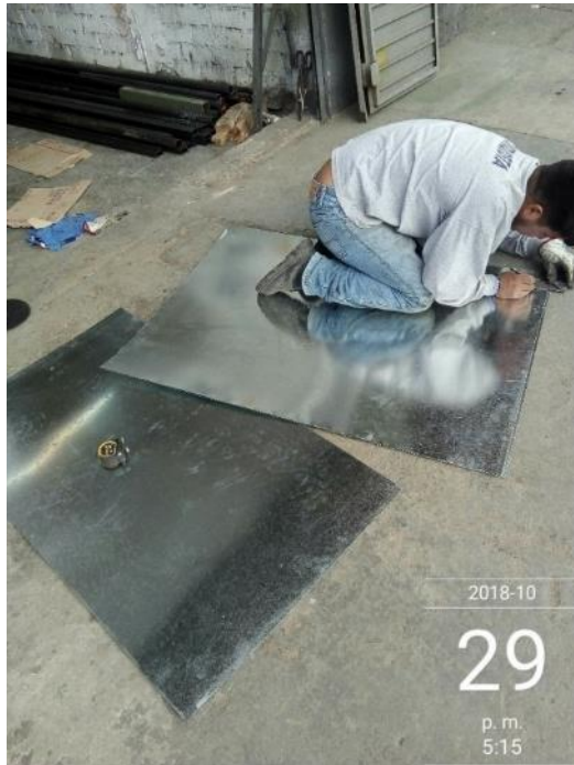
Figura 7. Habilitación de las planchas de acero galvanizado.
