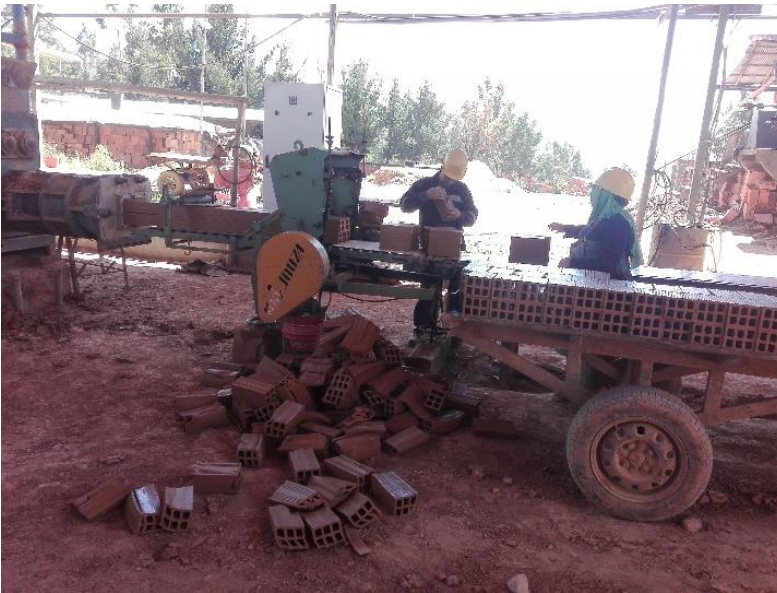
Figura 12. Residuos en el área de formado
