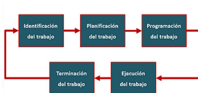
Figura 1: Proceso para el aseguramiento de un mantenimiento efectivo
