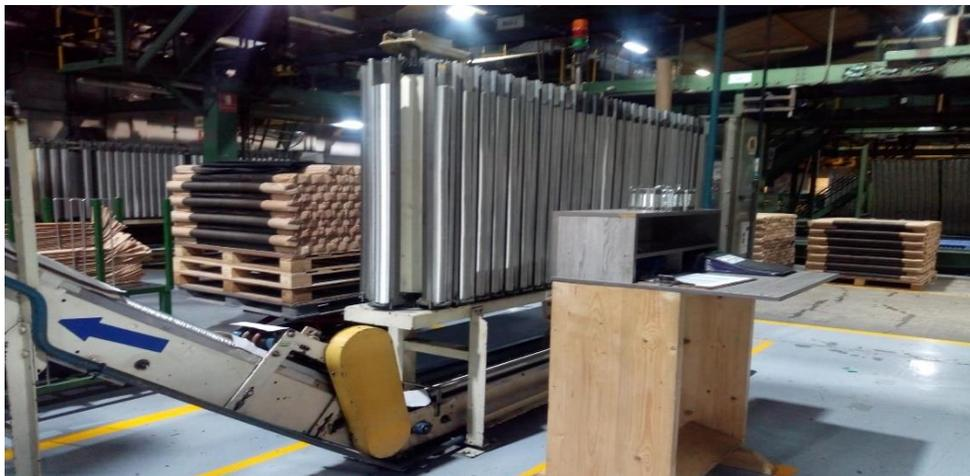
*Figura 28:* Máquina alimentadora de fondos
