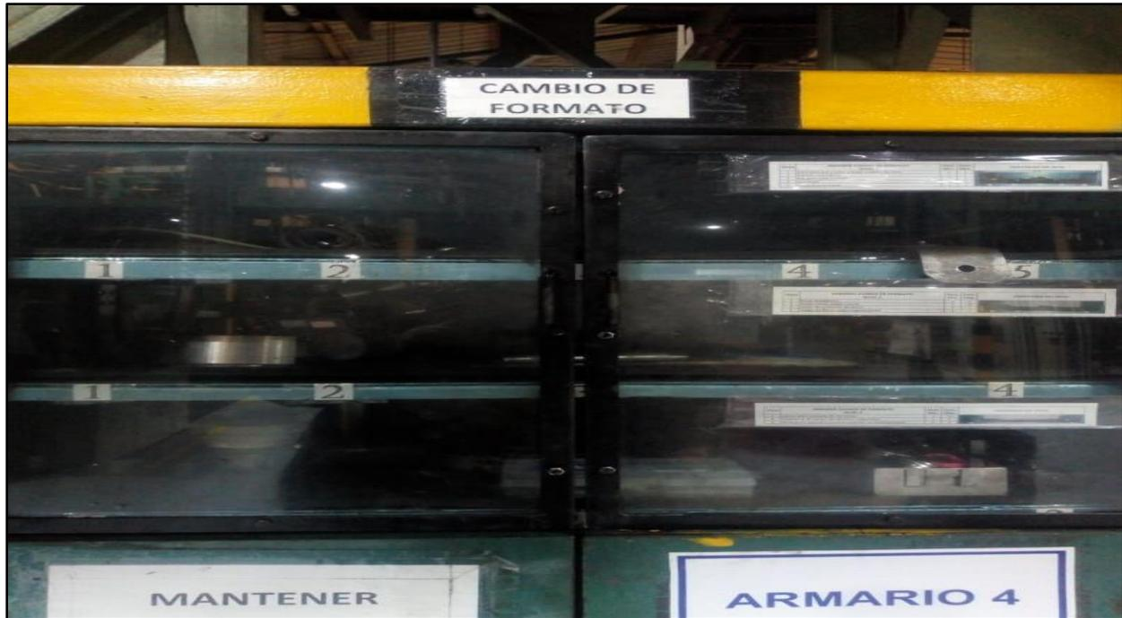
Figura 32: Organización de herramientas, equipos y piezas para el cambio de formato
