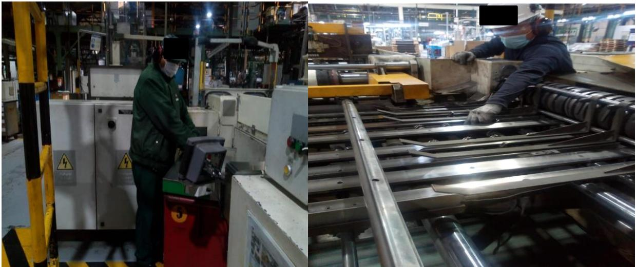
Figura 44: medición de los parámetros y regulación de cuchillas en paralelo
