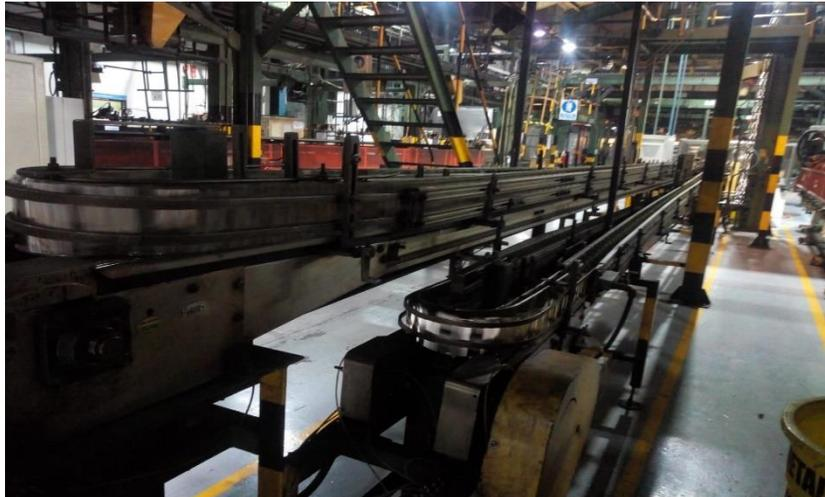
*Figura 26:* Transporte de Envases Metálicos.
