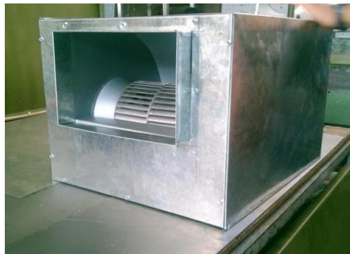
Figura 6. Equipo de ventilación mecánica tipo booster
