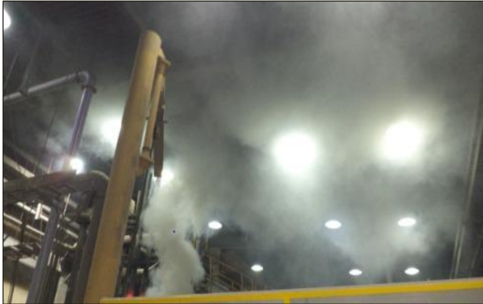
Figura 25 Material particulado sin recuperarse.
