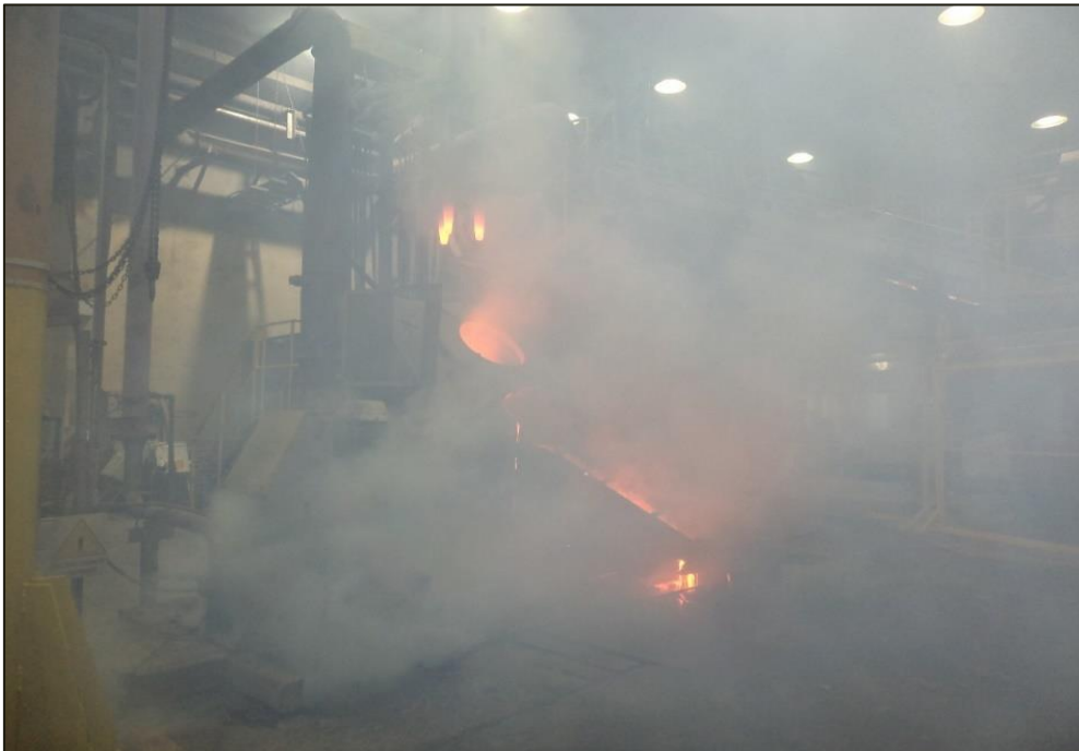
Figura 21 Pérdidas de material particulado en fundición.
