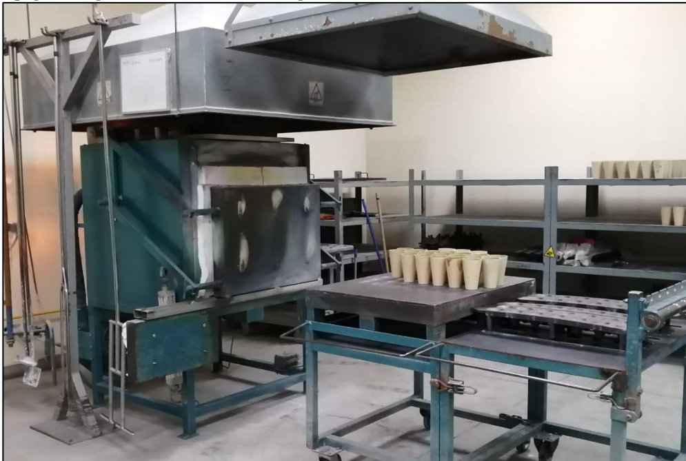
Figura 9 Equipo de copelación de muestras en la planta.
