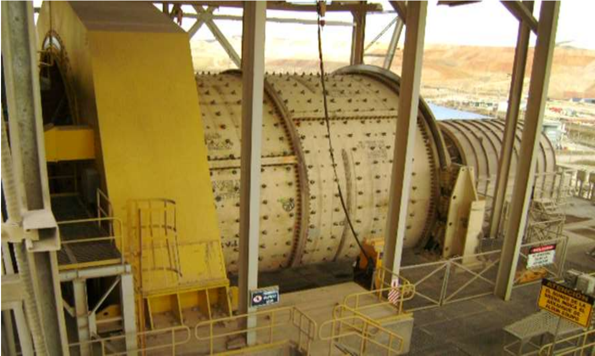
Foto 1. Molino SAG de 9.75 metros de diámetro por 9.75 metros de largo, de la Empresa Minera en estudio
