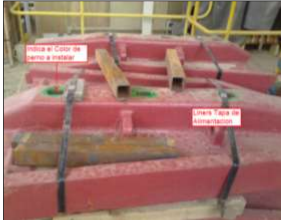
Ilustración 1. Liners Tapa de Alimentación. Molino SAG 32'X32'
