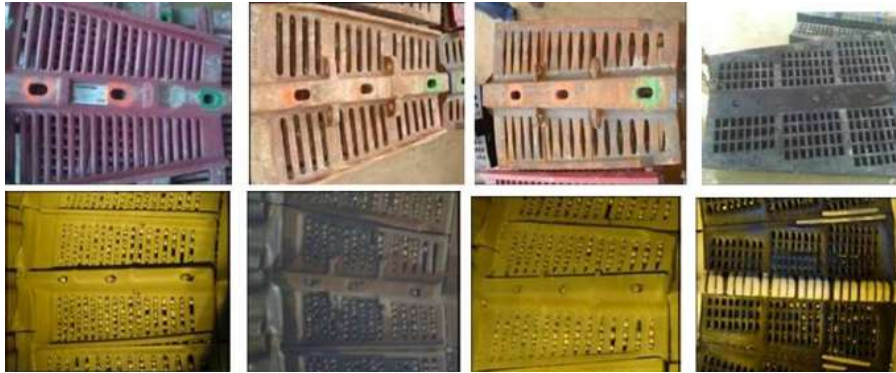
Ilustración 5. Antes y después de los diferentes diseños de parrillas de descarga.
