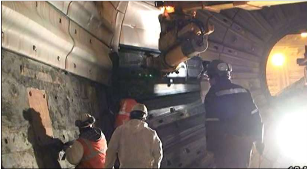
Ilustración 3. Backing Rubber despegado, al retirar los liners Shell del Molino SAG.
