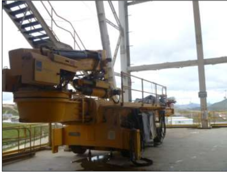
Ilustración 4. Máquina manipuladora de liners de capacidad 4500 kg. Mill Relining Systems de RME.
