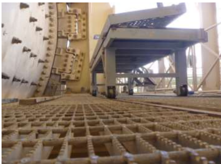
Ilustración 9. Plataforma deslizante para la extracción de pernos.
