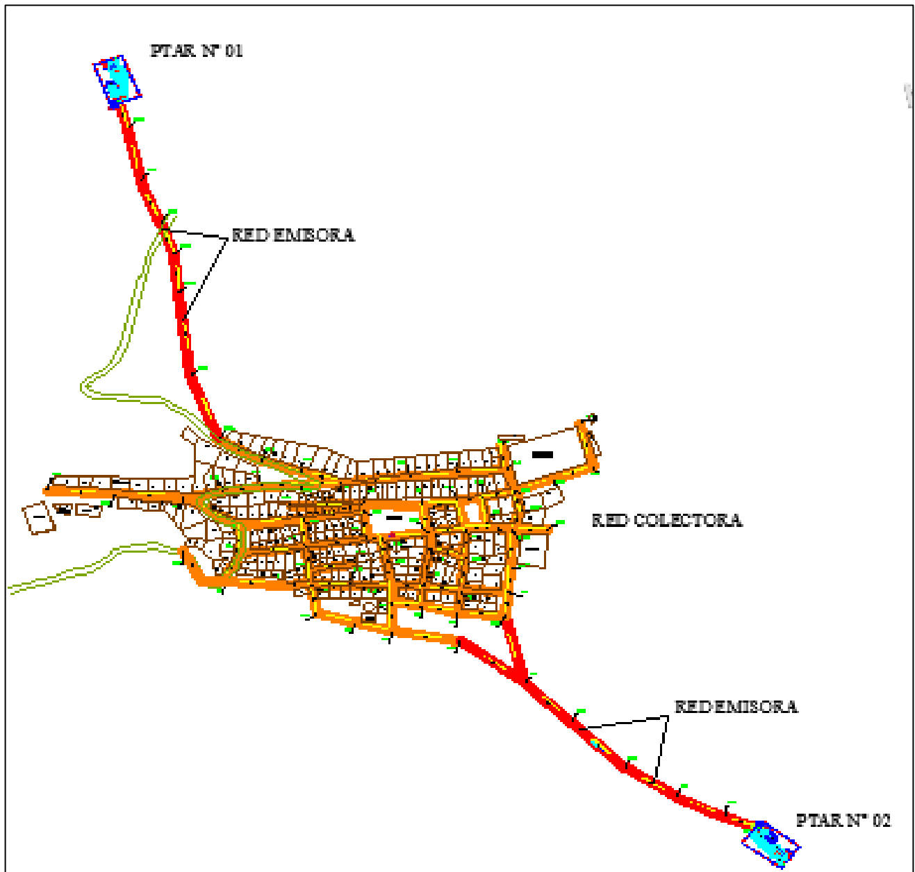
Figura 17. Componentes del sistema de alcantarillado sanitario del centro poblado de San Antonio.
