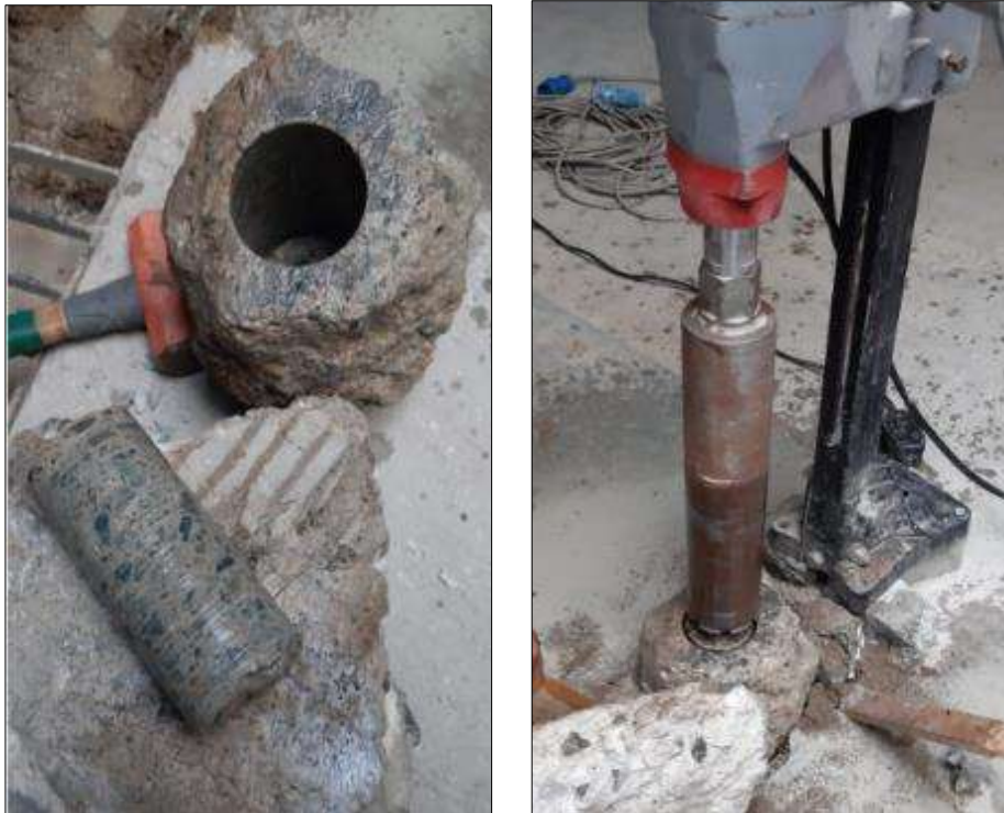
Figura 47: Diamantina al material reciclado con la condición de ver su resistencia a la compresión ( f'c )
