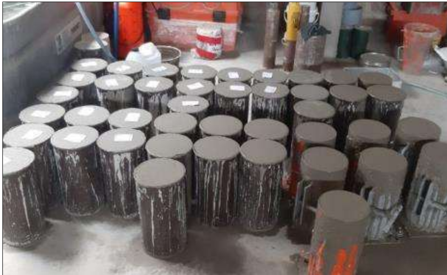
Figura 36: Vaciado de probetas de 6" x 12" con agregado 100% reciclado
