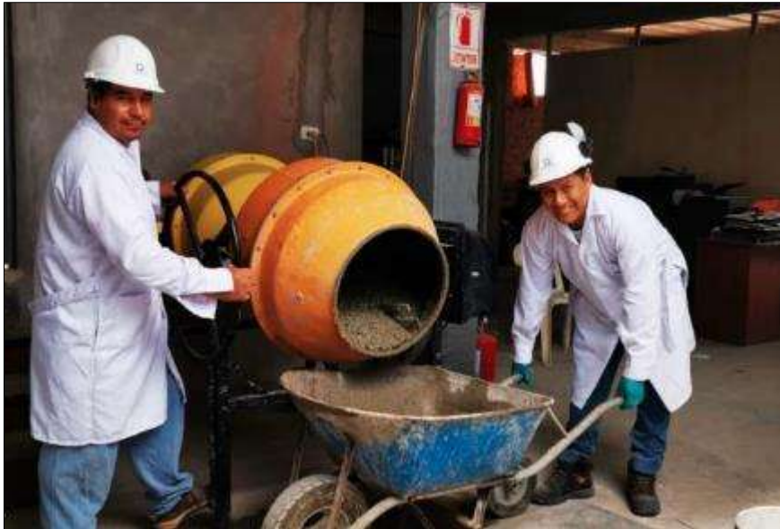
Figura 32: Preparación del concreto, con agregado reciclado, según el método de agregados globales
