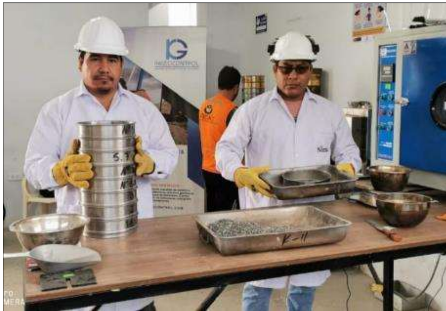
Figura 20: Granulometría y tamizado ASTM D-422, AASHTO T88, MTC E 107-2000
