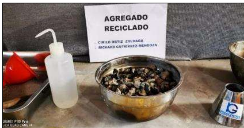
Figura 24. Ensayo de pesos específico y absorción del agregado grueso (NTP 400.021 / ASTM C127)
