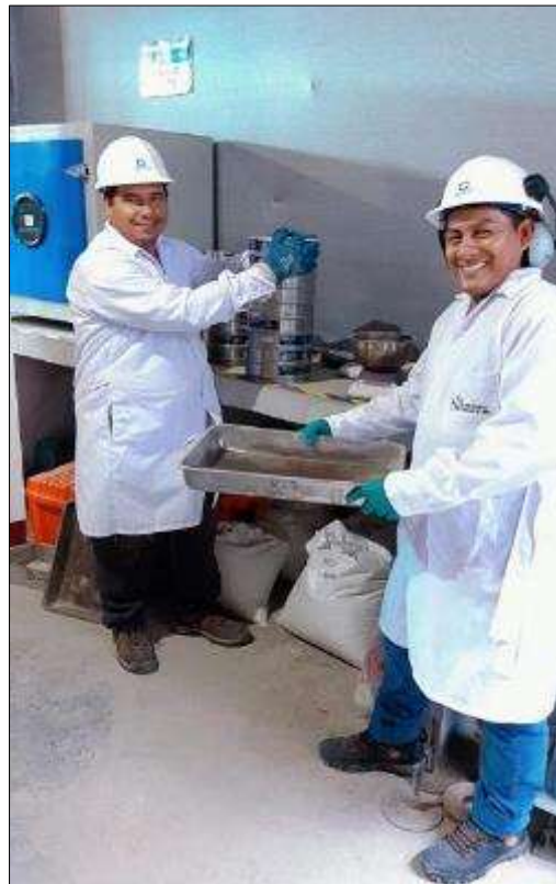
Figura 19: Granulometría y tamizado ASTM D-422, AASHTO T88, MTC E 107-2000
