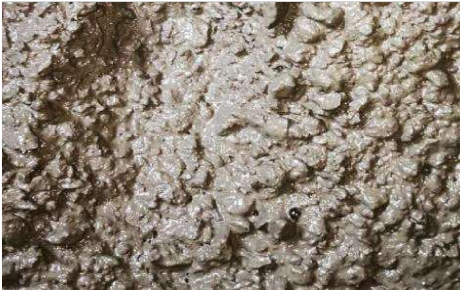
Figura 34: Consistencia plástica, muestra pastosa óptima para vaciado
