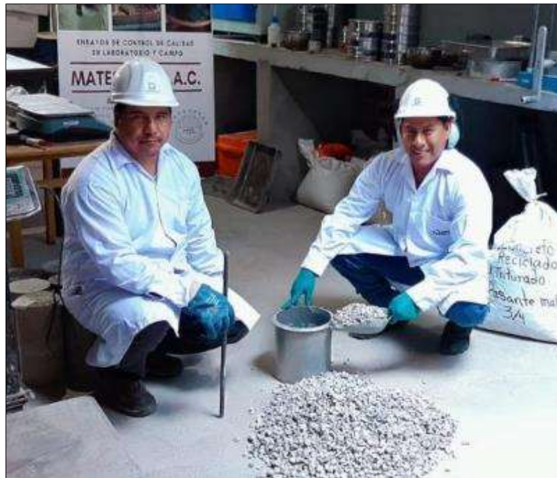
Figura 22: Ensayo de peso unitario de agregado reciclado grueso y fino (compactado y suelto) según la NTP 400.017
