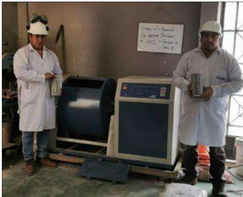
Figura 39: Ensayo de abrasión en maquina los ángeles, con especímenes de agregado 100% reciclado (ASTM C131)
