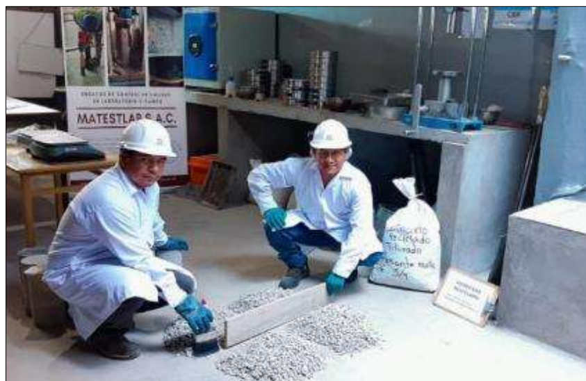
Figura 21: Cuarteo de concreto reciclado triturado según la norma AASHTO T 248 – ASTM C702.
