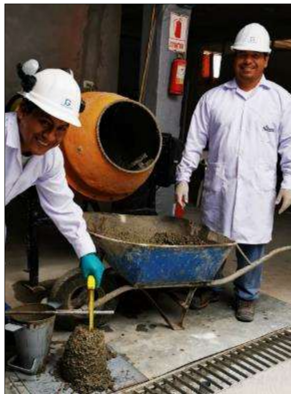
Figura 33: Ensayo de revenimiento con concreto 100% reciclado
