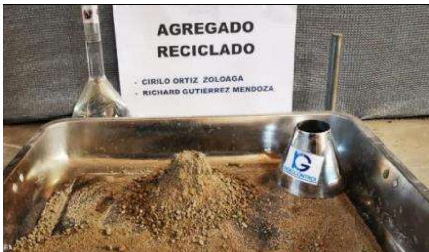
Figura 26: Agregado fino superficialmente saturado seco. (SSS)
