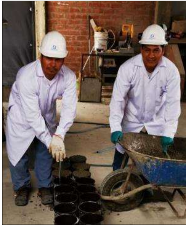
Figura 35: Vaciado de probetas 6" x 12", para someterlos a ensayo de compresión
