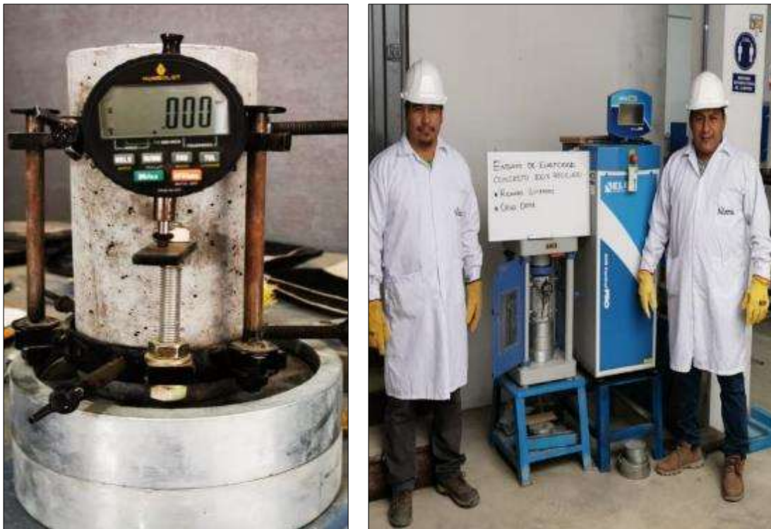
Figura 46: Calibración de compresómetro y ensayo de elasticidad, con concreto 100% reciclado.
