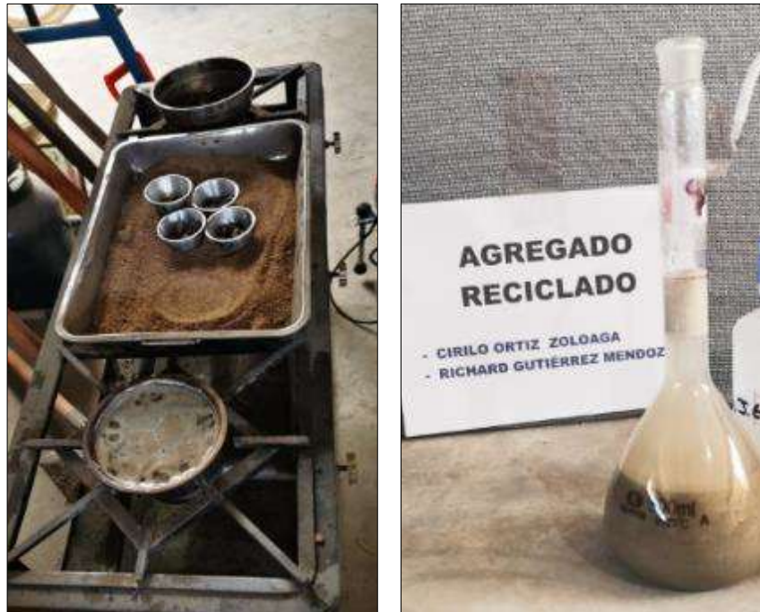
Figura 25: Ensayo de pesos específico y absorción del agregado fino (NTP 400.022 / ASTM C128)
