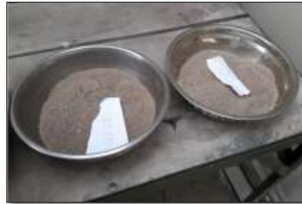
Figura 26. Cuarteo y separación de las cantidades necesarias para los ensayos A. F. Fuente propia.
