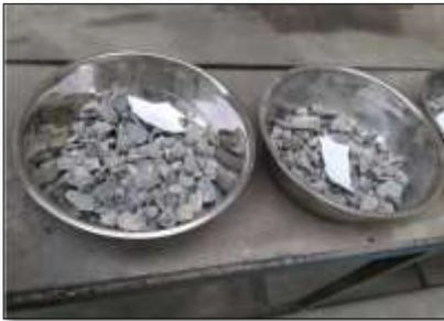
Figura 25. Cuarteo y separación de las cantidades necesarias para los ensayos A. G. Fuente propia.
