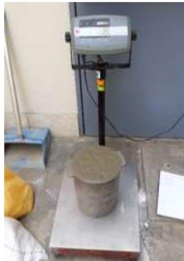
Figura 40 Verificación del peso unitario del concreto usando diatomita. Fuente propia.
