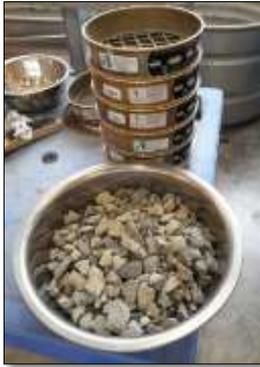
*Figura 29* Colocación del agregado en las mallas. Fuente propia.
