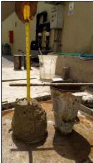
Figura 41 Verificación del asentamiento del concreto. Fuente propia.
