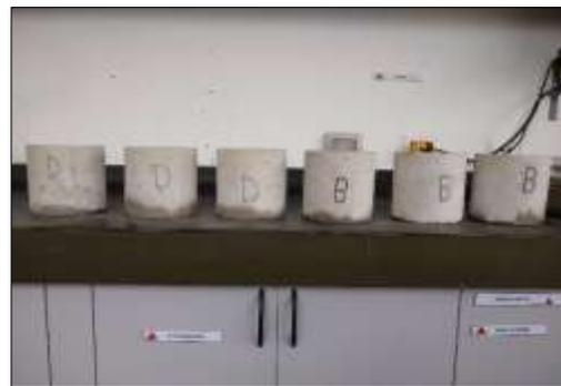
*Figura 52* Muestras de concreto después de ser sometidos ensayos de permeabilidad. Fuente propia.
