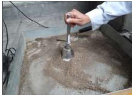
*Figura 32* Apisonado del agregado fino en el cono para determinar su cantidad que será usada en el ensayo. Fuente propia.
