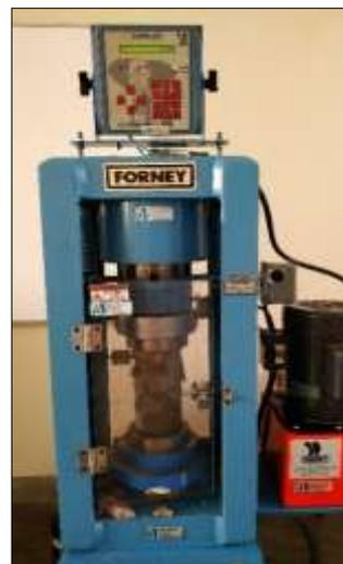
Figura 42 Equipo para determinar la resistencia a la compresión del concreto. Fuente propia.
