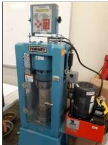
Figura 3 Rotura de probeta de concreto. Elaboración propia.
