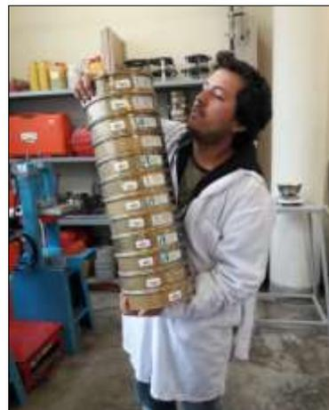
Figura 28. Proceso para determinar la granulometría de los agregados. Fuente propia.
