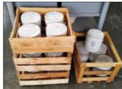
*Figura 45* Muestras de concreto para realizar ensayos de permeabilidad. Fuente propia,
