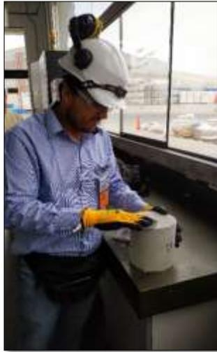
*Figura 51* Preparación de la superficie que tendrá contacto con la presión constante del equipo. Fuente propia.
