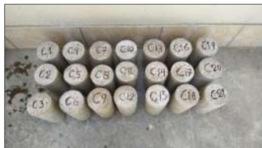
Figura 43 Muestras de concreto para realizar ensayos de rotura. Fuente propia.
