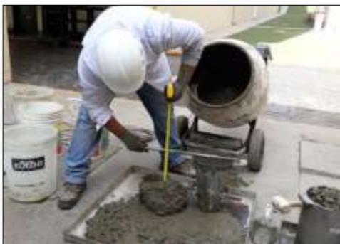
*Figura 37* Ensayo de slump para verificar la consistencia de la mezcla. Fuente propia.
