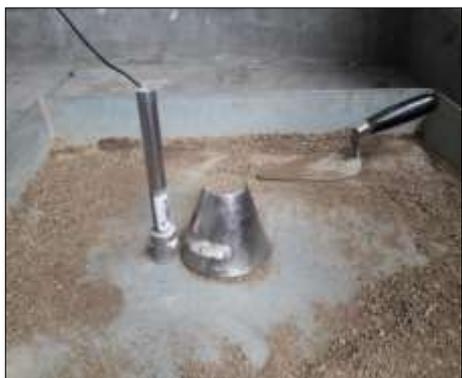
*Figura 33* Muestras compactada ara determinar su peso específico. Fuente propia.
