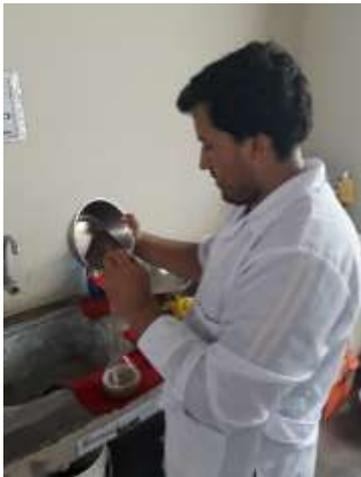
*Figura 39* Colocación del agregado fino en el picnómetro para determinar el peso específico. Fuente propia.
