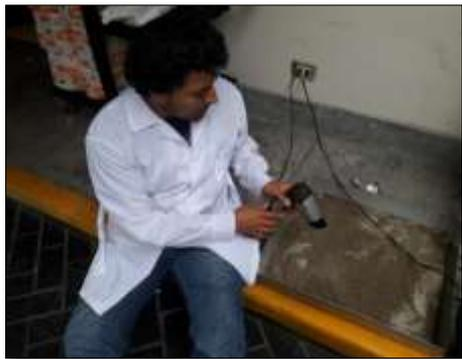
*Figura 31* Secado del agregado fino para determinar su peso específico. Fuente propia.
