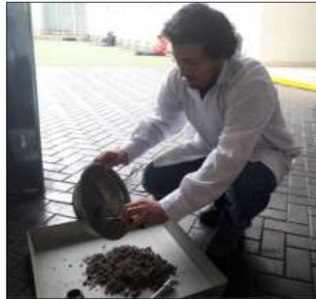
*Figura 30* Proceso de ensayo para determinar el específico del agregado fino. Fuente propia.
