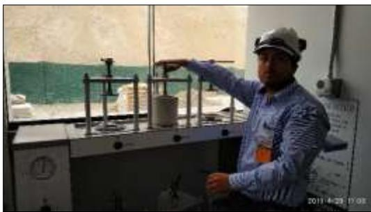
*Figura 53* Colocación de la muestra de concreto en el equipo de permeabilidad. Fuente propia.
