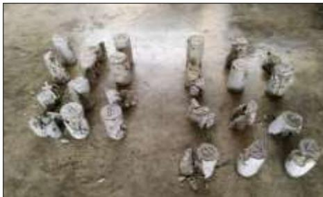
*Figura 46* Muestras de concreto después de ser sometidas a compresión. Fuente propia.
