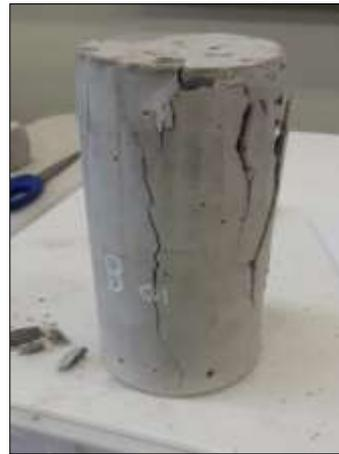
*Figura 47* Probeta de concreto después de ser sometida a compresión. Fuente propia.
