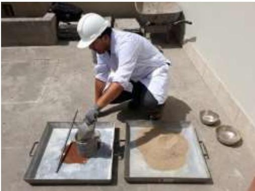
*Figura 34* Determinación del peso unitario de los agregados Fuente propia.
