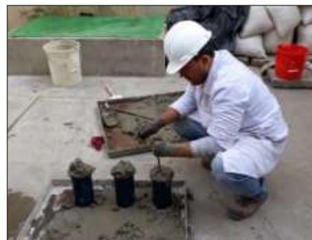
*Figura 36* Colocación de la mezcla en los moldes de concreto. Fuente propia.
