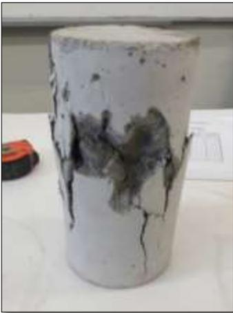
*Figura 48* Probeta de concreto después de ser sometida a compresión. Fuente propia.
