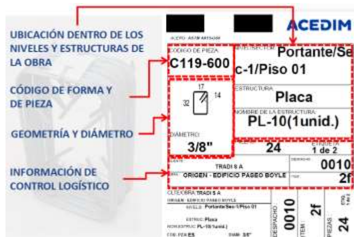
Figura 30: Etiqueta que va en los paquetes de acero
