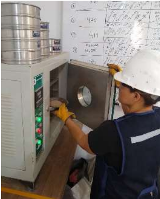
Colocación de agregado delgado a horno
