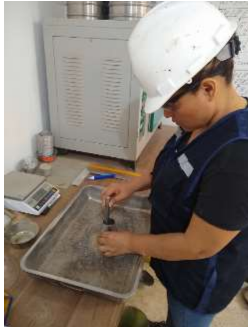
Compactando arena en cono
