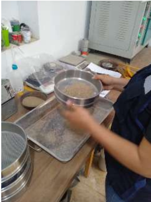
Tamizado de agregado grueso
