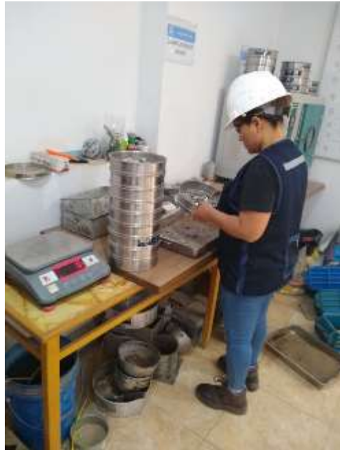
Tamizado de agregado fino
