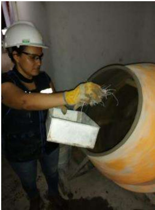
Agregando la fibra óptica
