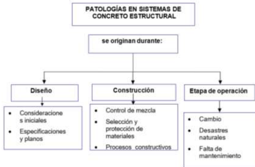
Figura 2. Patologías en sistemas de concreto estructural
