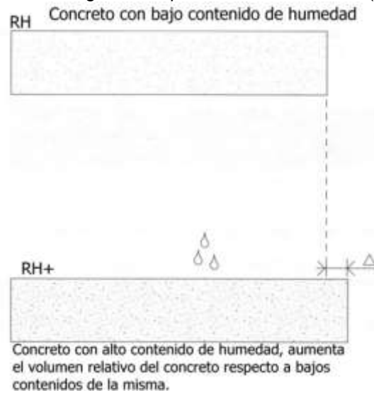
Figura 4. Deterioro generado por el cambio climático (humedad)
