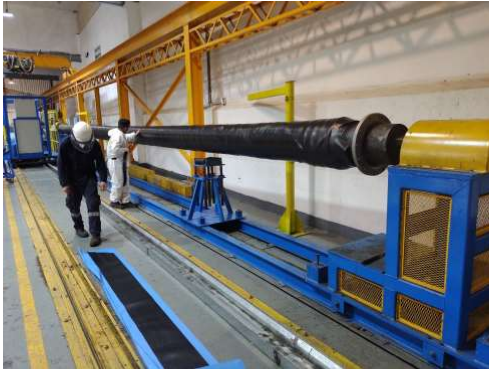
Figura 10. Proceso de fabricación de mangueras tipo 650. Fabricación
