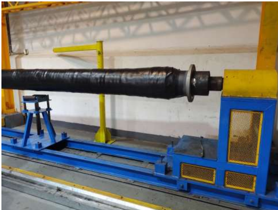
Figura 11. Proceso de fabricación de mangueras tipo 650. Fabricación
