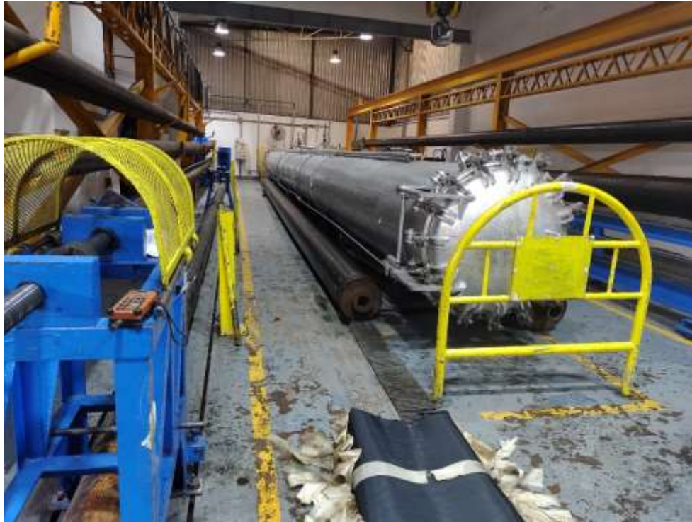
Figura 12. Proceso de fabricación de mangueras tipo 650. Autoclave
