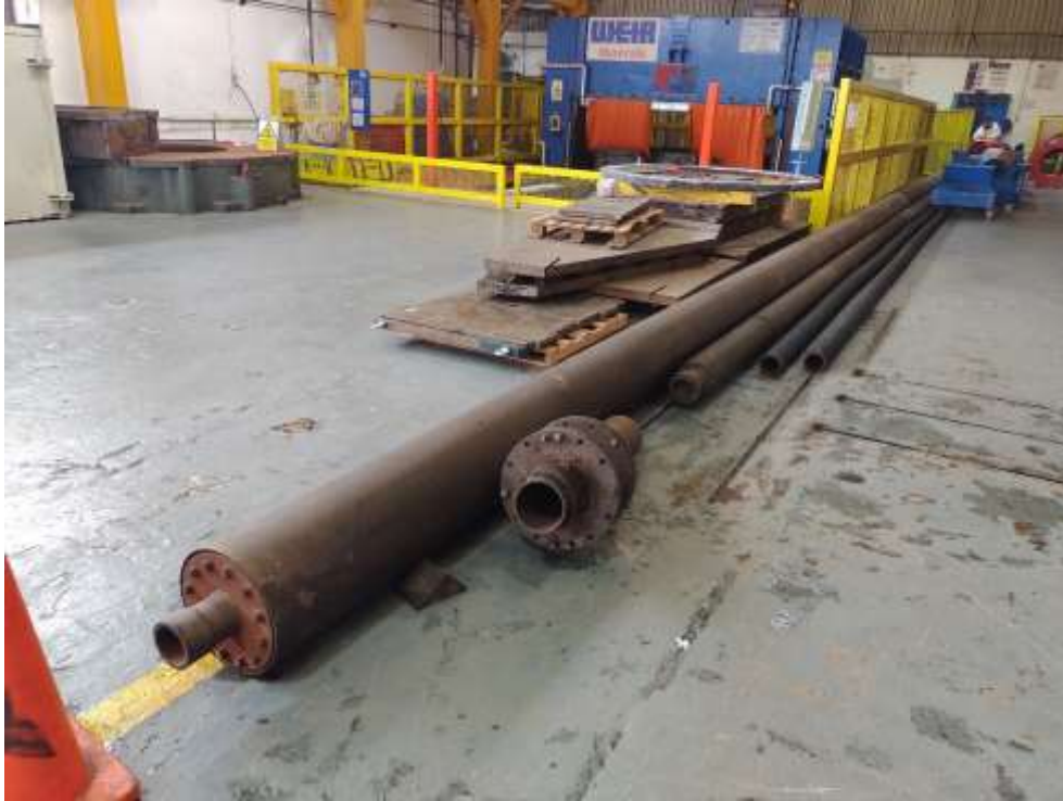
Figura 8. Proceso de fabricación de mangueras tipo 650. Mandril o molde
