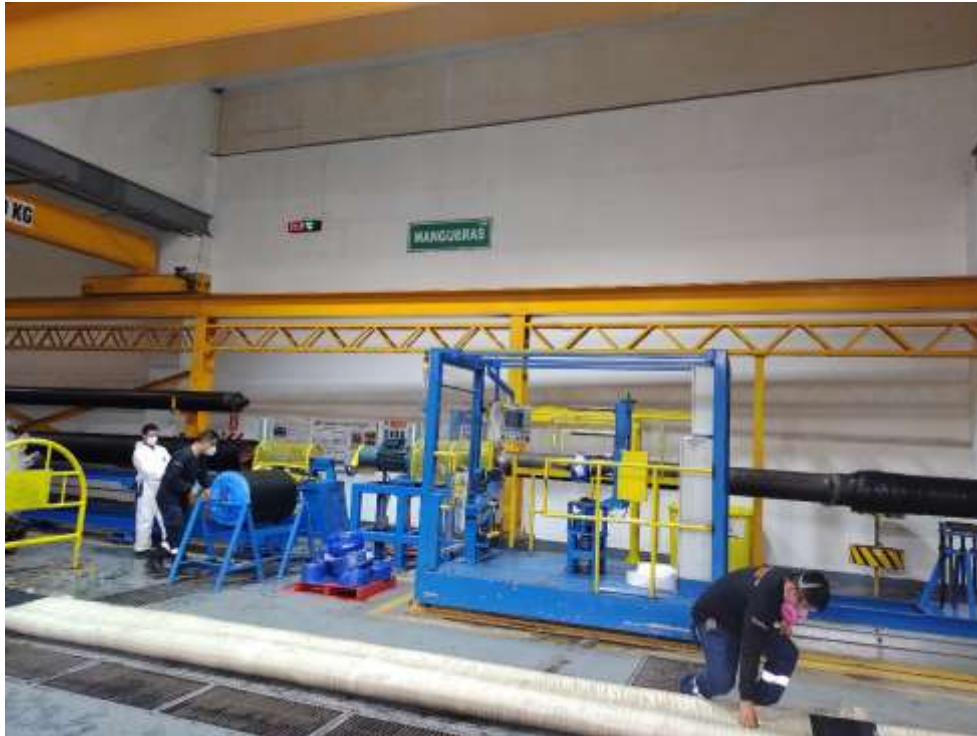
Figura 6. Proceso de fabricación de mangueras tipo 650. Área de mangueras
