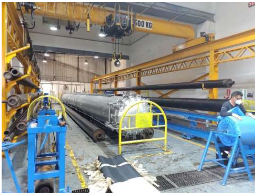
Figura 13. Proceso de fabricación de mangueras tipo 650. Autoclave
