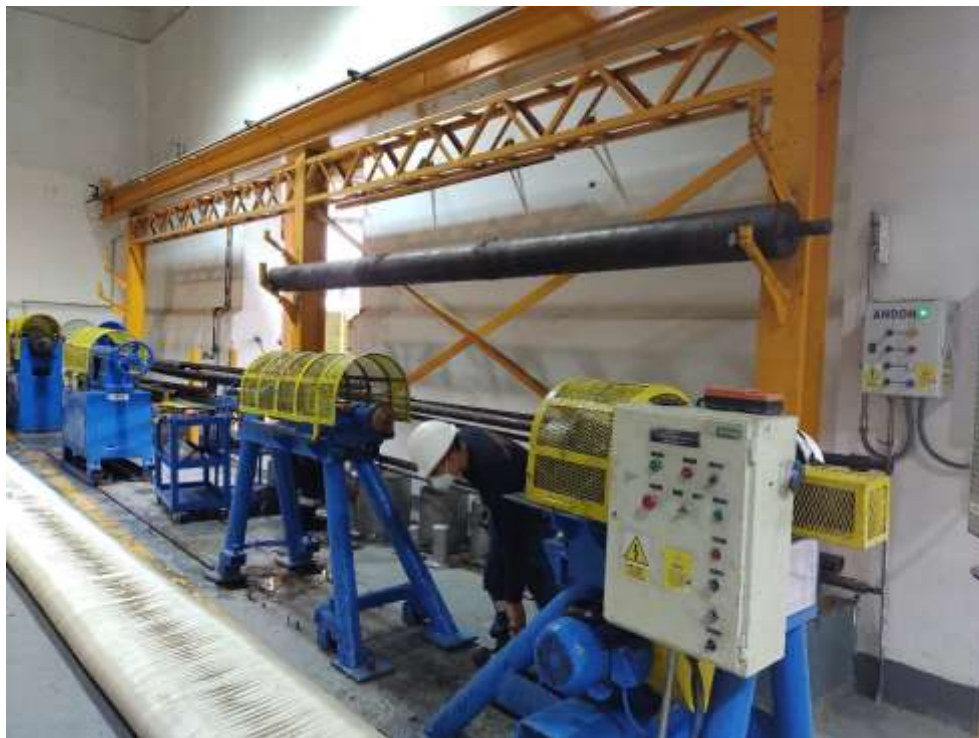
Figura 9. Proceso de fabricación de mangueras tipo 650. Tornos
