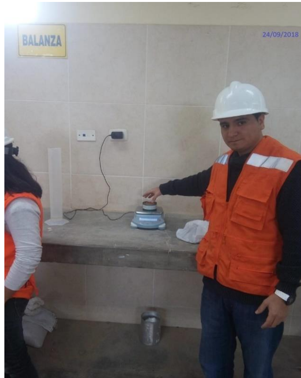
Figura 5: Ensayo contenido de humedad de la materia prima.
