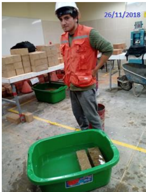
Figura 16: Ensayo de grado de absorción de los BTC.
