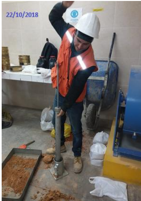
Figura 10: Ensayo de Proctor modificado para la muestra patrón
