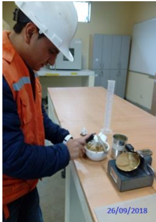
Figura 8: Ensayo límite líquido de la materia prima.
