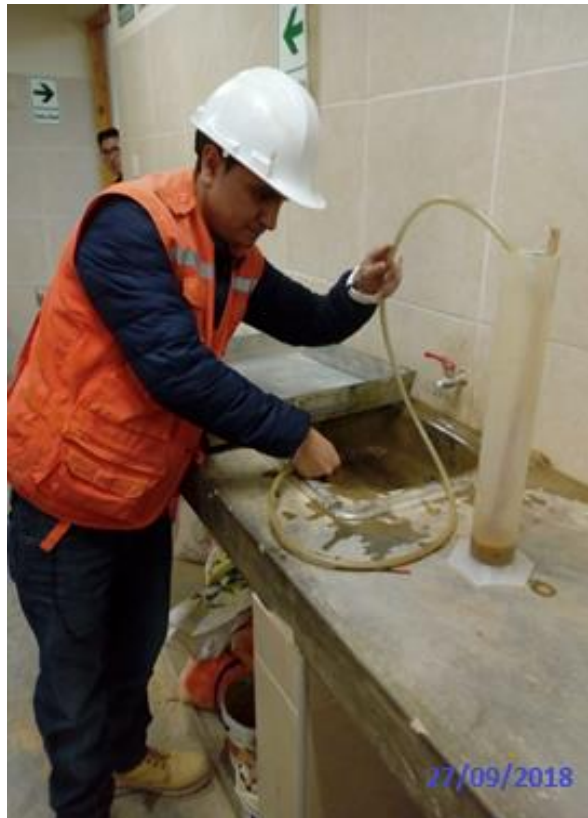
Figura 7: Ensayo granulométrico por sifonaje de la materia prima.
