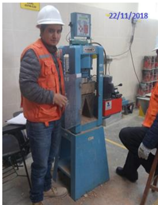
Figura 15: Ensayo de resistencia a la flexión de los BTC.
