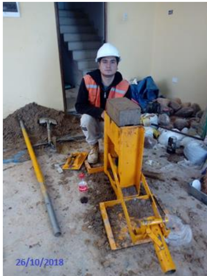
Figura 12: Elaboración de los BTC en la máquina CINVA RAM.
