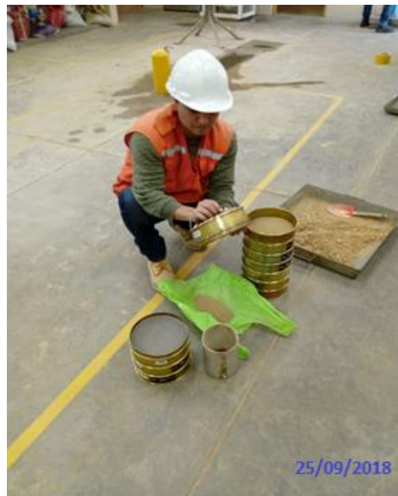
Figura 6: Ensayo granulométrico de la materia prima.
