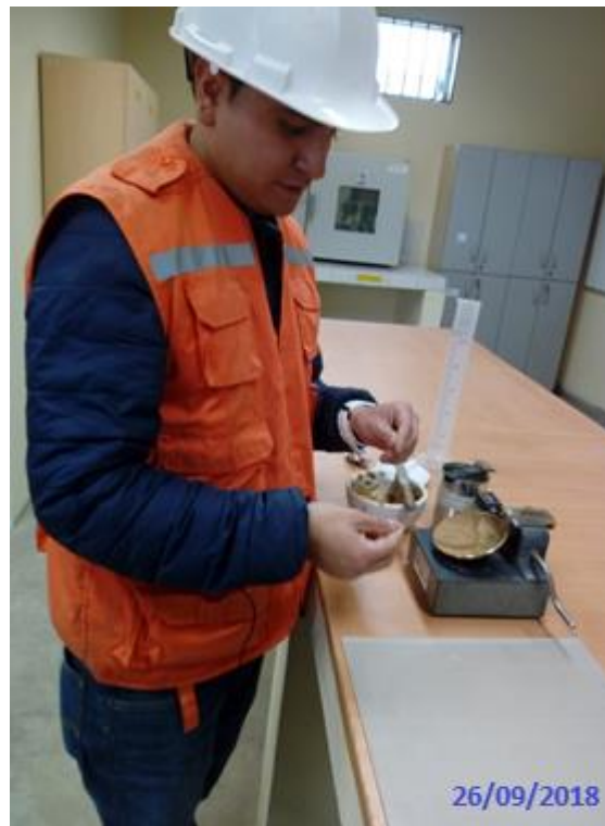
Figura 9: Ensayo límite plástico de la materia prima.
