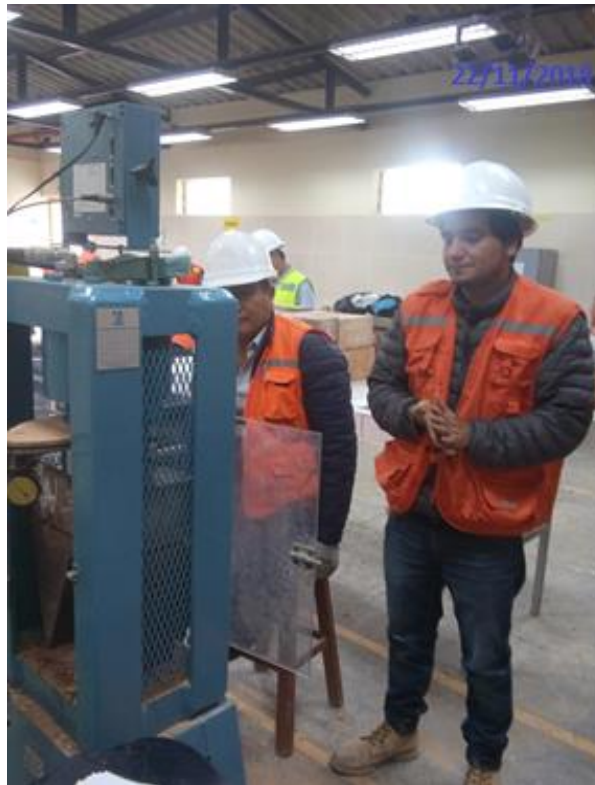
Figura 14: Ensayo de resistencia a la compresión de los BTC.
