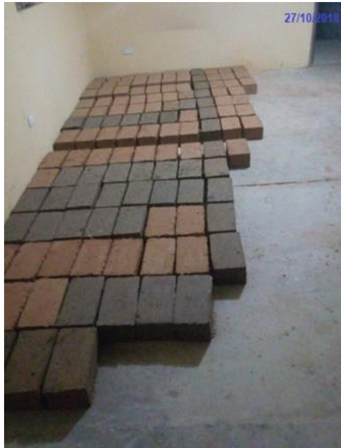
Figura 13: BTC en estado natural y con adición de emulsión asfáltica (RC-250)
