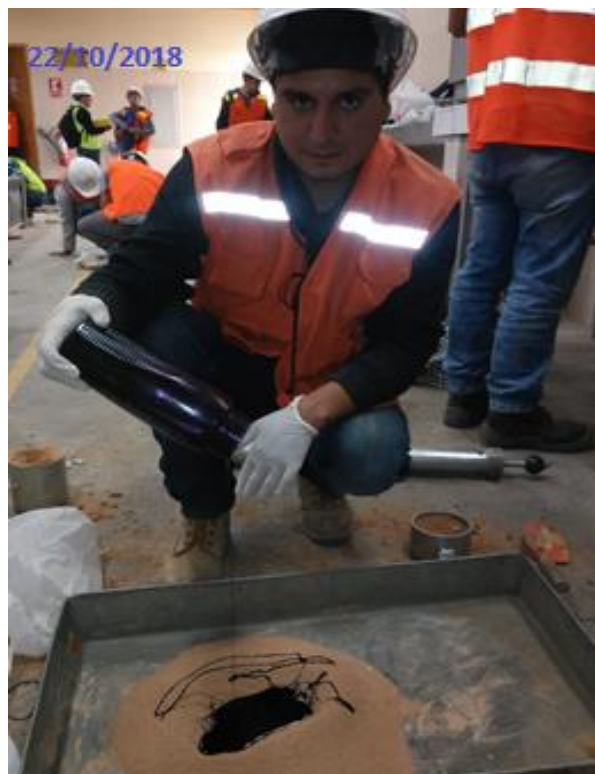
Figura 11: Ensayo de Proctor modificado con emulsión asfáltica (RC-250).
