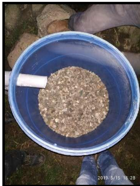
FIGURA 62 Gravilla capa 02 de filtro de carbón activado
