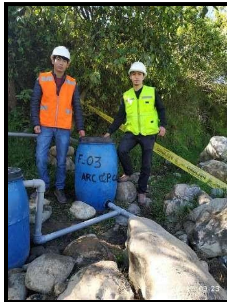
FIGURA 70 Filtro 03 Arcilla y piedra caliza
