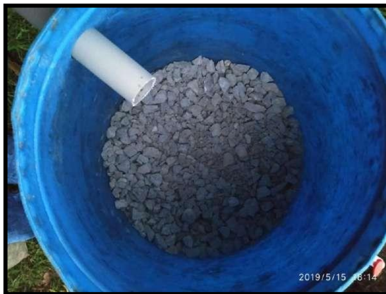
FIGURA 57 Arena gruesa capa 04 de filtro con arcilla y piedra caliza
