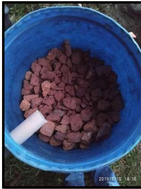
FIGURA 59 Arcilla Capa 06 de filtro con arcilla y piedra caliza
