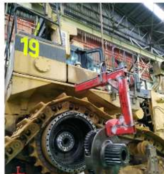
Verificando el estado del retén central del mando final
