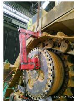
Verificando el estado del retén central del mando final
