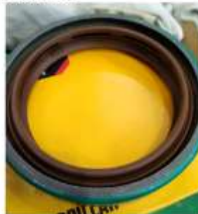
Verificando el estado del retén central del mando final
