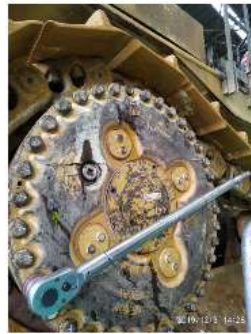
Instalación de la segunda reducción En mando final
