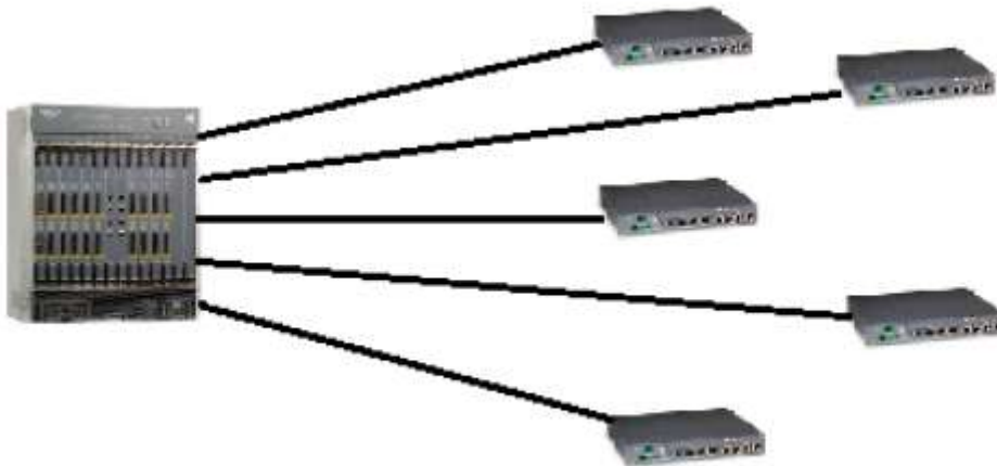
Figura N° 11 Enlace punto a punto Fuente: (Marchukov, 2011)
