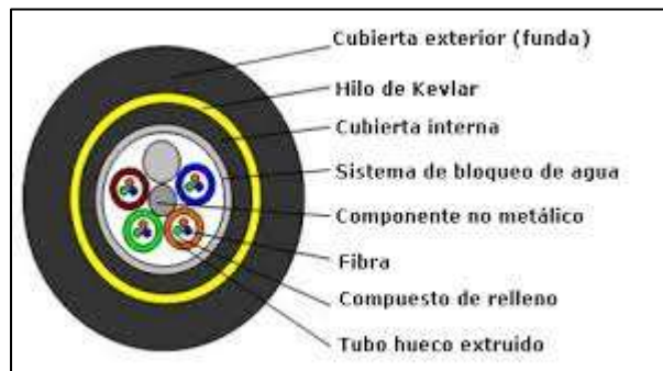
Figura N° 34 Detalle de Fibra óptica
