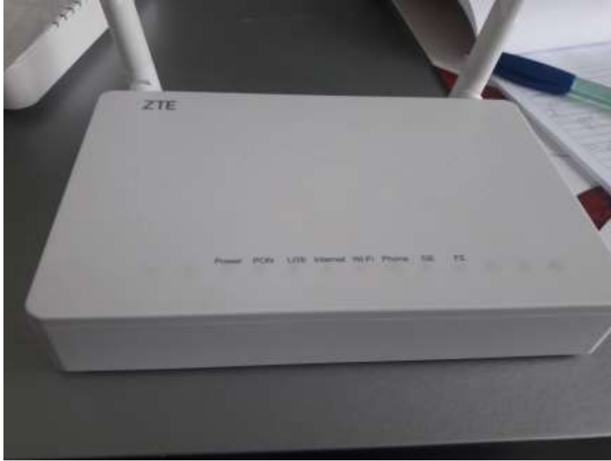
Figura N° 59 ONT para el cliente
