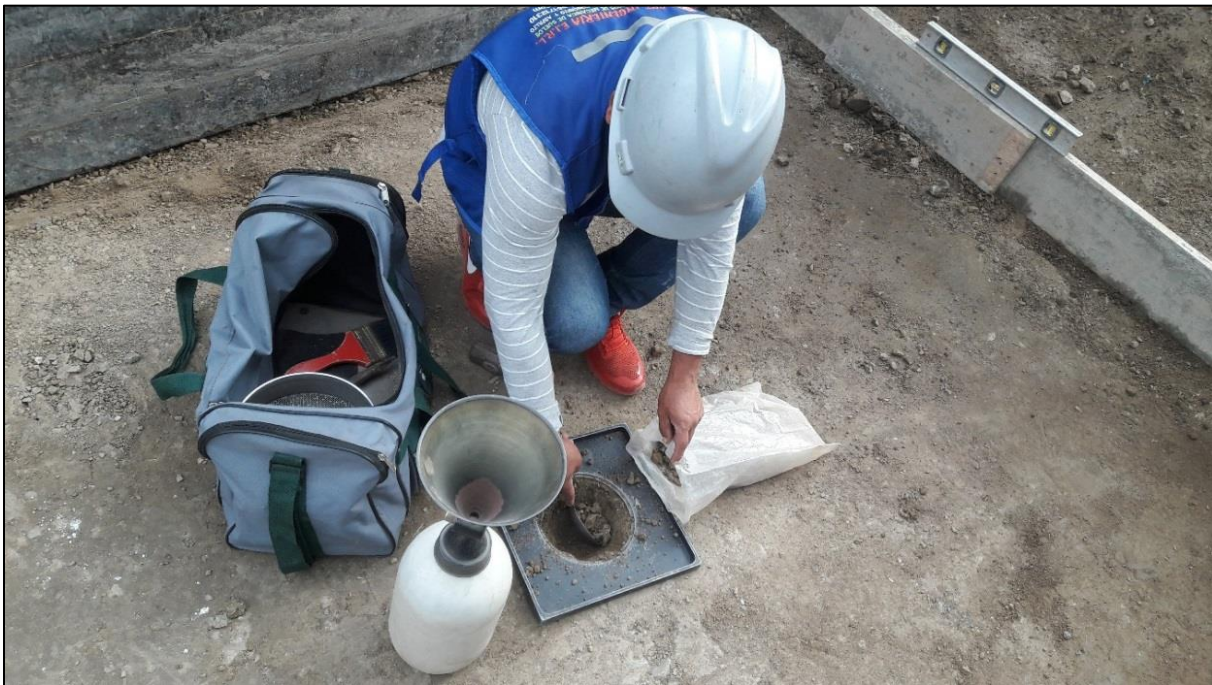
Figura N ° 10. Estudio de suelos llevando material a laboratorio del proyecto B. Autoría propia.
