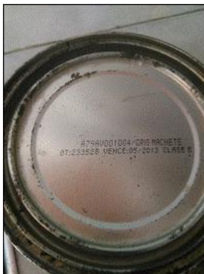
Figura 31. pintura deteriorada por vencimiento. Fuente: Empresa ALCA E.I.R.L
