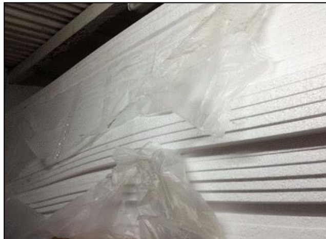
Figura 27. Tecnopor deteriorada por manipulación. Fuente: Empresa ALCA E.I.R.L
