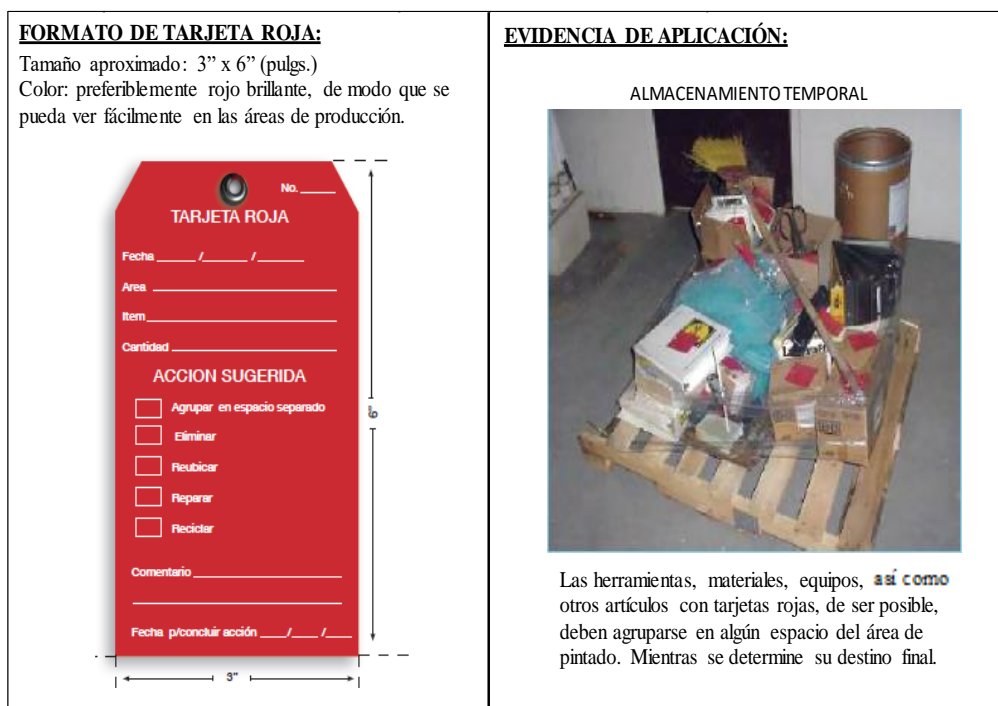
Figura 14. Aplicación se SEIRI mediante tarjetas rojas
