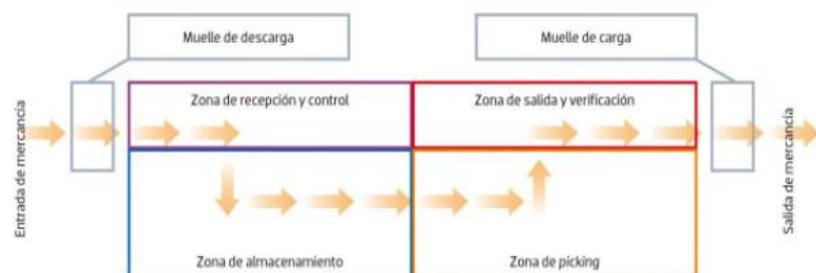
**Imagen 3:** Diseño de un almacén en línea recta, donde las flechas representan el flujo de materiales.
