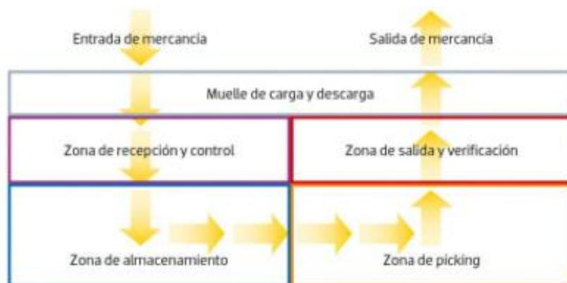
**Imagen 1:** Diseño de un almacén en U, donde las flechas representan el flujo de materiales.
