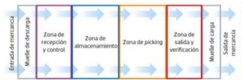
**Imagen 2:** Diseño de un almacén en línea recta, donde las flechas representan el flujo de materiales.
