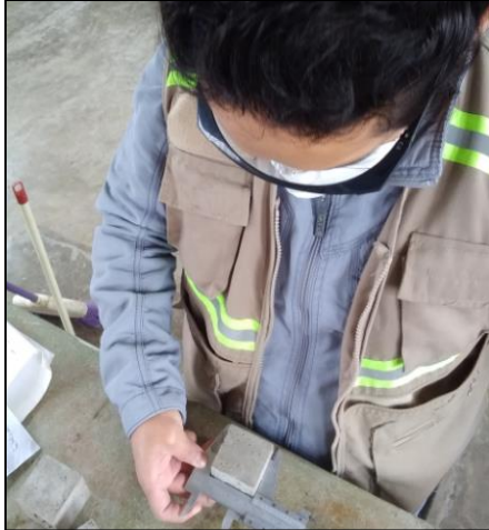
Fotografía N°63: Control de las dimensiones de los cubos con adición de fibra de coco (L: 2cm).
