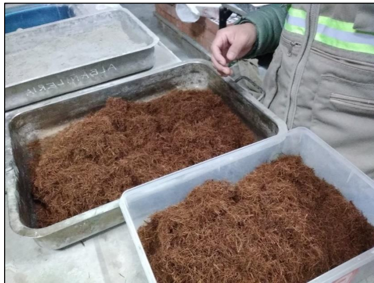
Figura 10. Corte de fibra de estopa de coco, de acuerdo a las longitudes requeridas.
