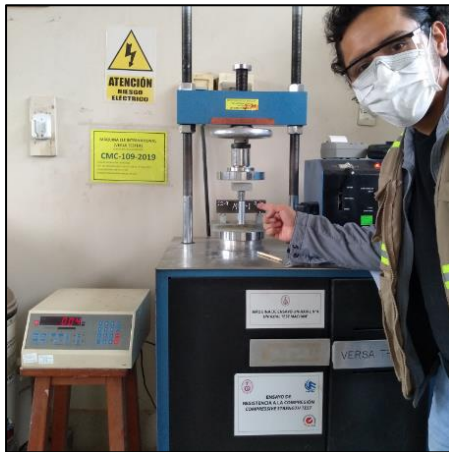
Fotografía N°79: (a) y (b): Instalación del dispositivo complementario en el equipo de compresión de hidráulica, para llevarse a cabo el ensayo a flexión en prismas.
