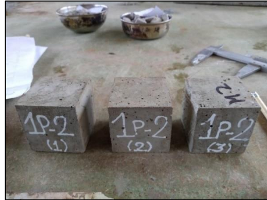
Fotografía N°64: Control de las dimensiones de los cubos de mortero con adición de fibra de coco (L: 2cm).
