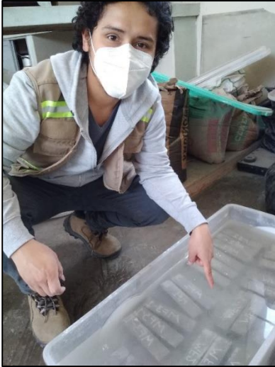
Fotografía N°77: Proceso de curado de las 27 muestras de mortero, posterior al desencofrar.
