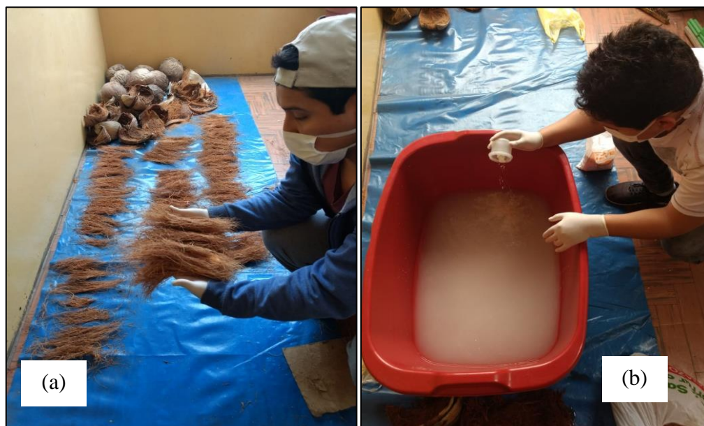
Figura 8. (a) Esparcido de la fibra de estopa de coco obtenida, (b) Preparación de la solución de cal 10 g /L.
