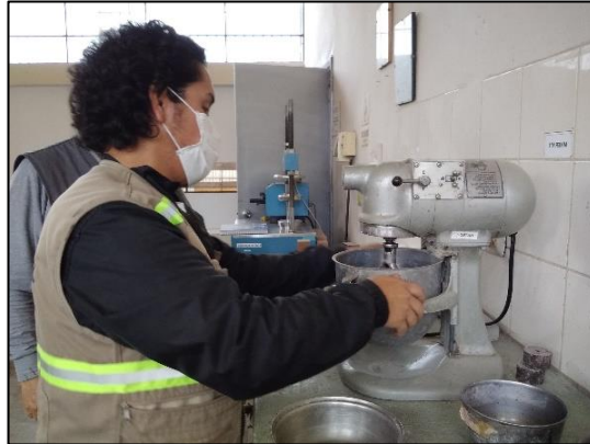
Figura 12. Elaboración de mezcla de mortero para la realización del ensayo de fluidez.
