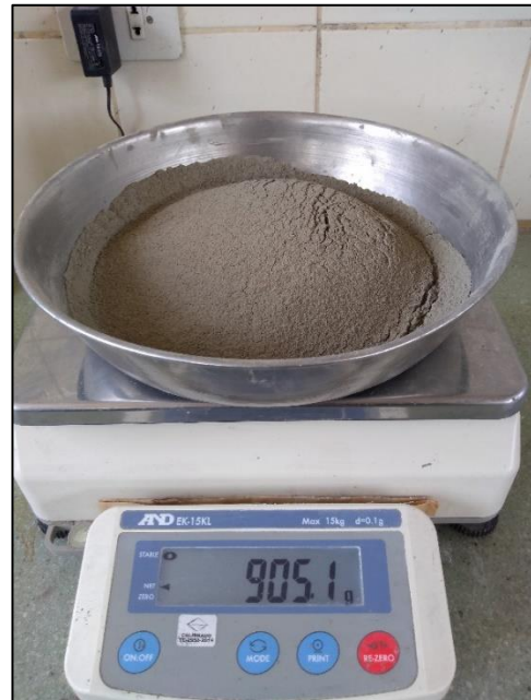
Fotografía N°10: Control de peso necesario del cemento.
