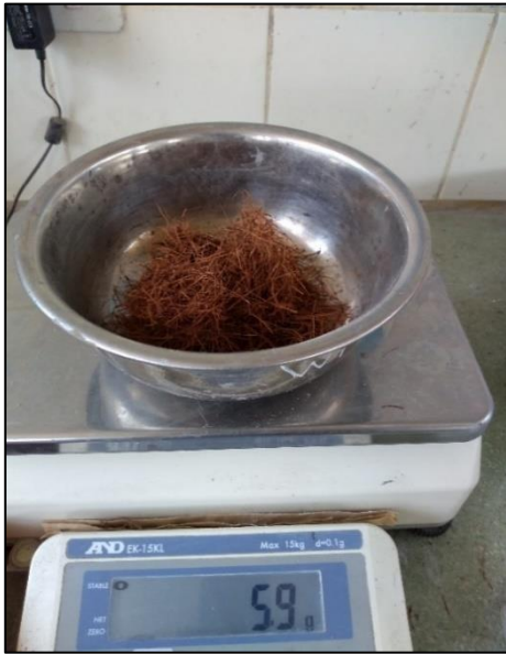
Fotografía N°13: Control de peso necesario del agregado fino.
