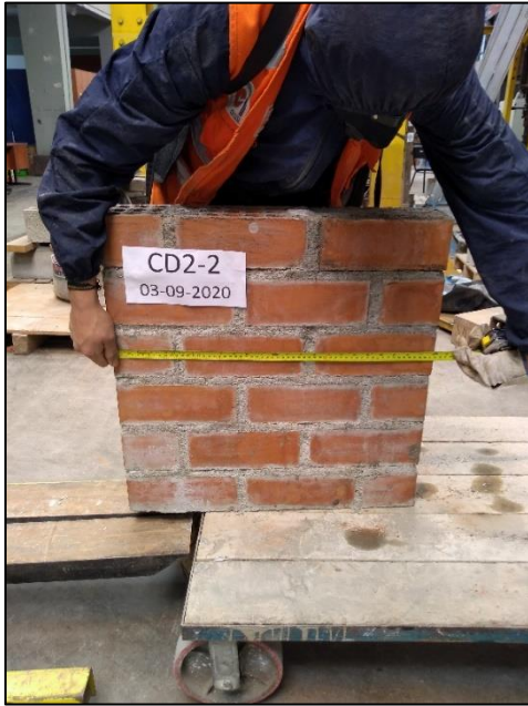
Fotografía N°51: Control de dimensiones del murete con adición de fibra (L:2cm) elaborado.
