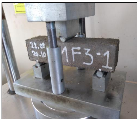
Fotografía N°80: (a) y (b): Colocación de los prismas de mortero en dispositivo de flexión.
