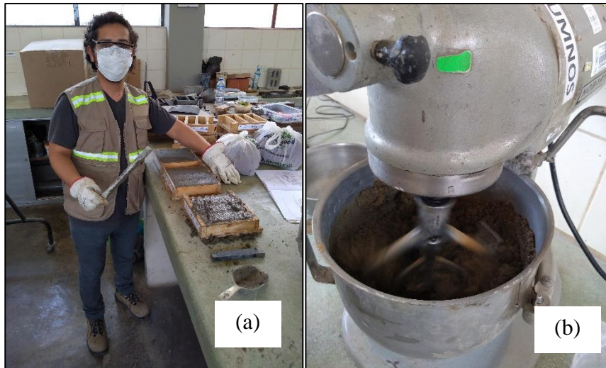
Figura 14. (a) Elaboración de la mezcla de mortero con y sin fibra de estopa de coco; (b) Colocación de las mezclas de mortero en moldes para prismas (40mm*40mm*160mm).
