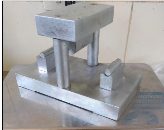
Fotografía N°78: Dispositivo complementario para la flexión de prismas de mortero.
