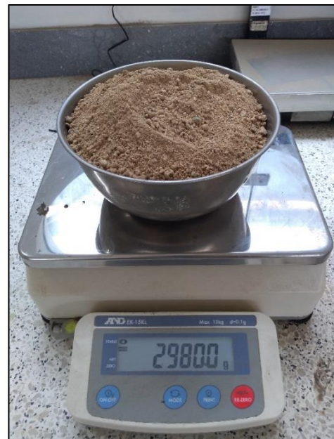
Fotografía N°12: Control de peso necesario del agregado fino.
