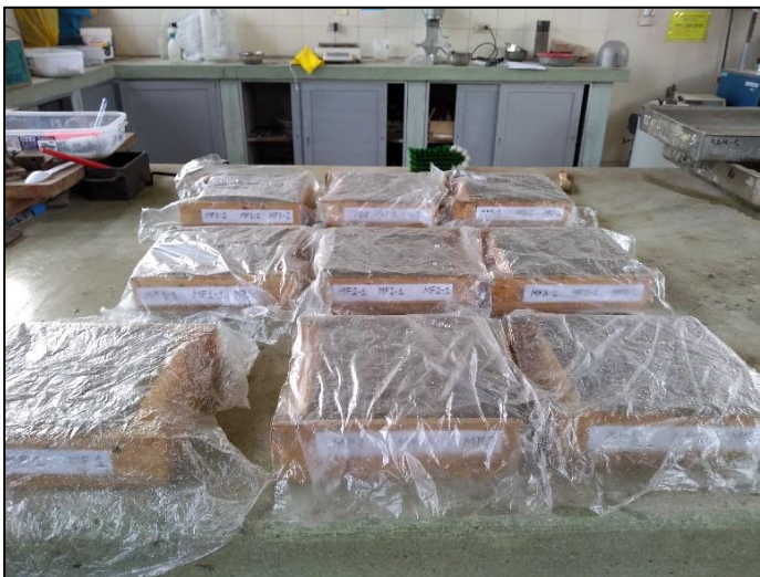
Fotografía N°76: Proceso de curado de los 27 prismas de mortero.
