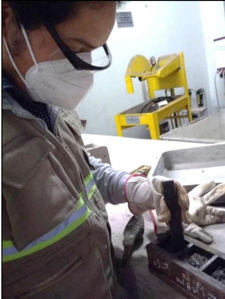
Fotografía N°54: Compactado de mezcla de mortero en molde para cubo.
