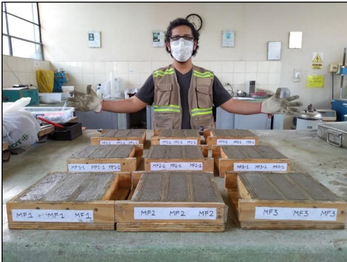
Fotografía N°75: Culminación de elaboración de 27 muestras de prismas de mortero (9 muestras patrón, 9 muestras patrón + fibra de coco de 1cm y 9 muestras patrón + fibra de coco de 2cm).
