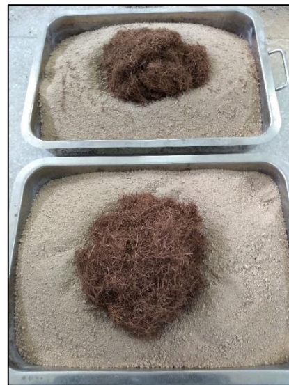
Fotografía N°23: Retiro del agregado fino y de la fibra de coco del horno.
