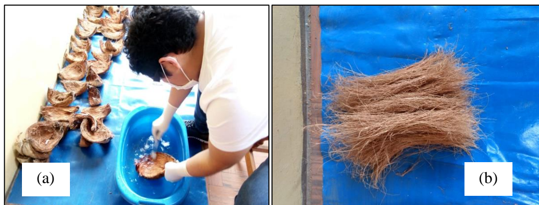
Figura 7. (a) Proceso de limpieza de polvillo de la fibra de estopa de coco, (b) Obtención de fibra de estopa de coco.
