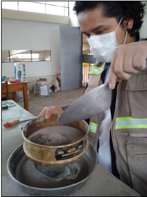
Fotografía N°09: Tamizado de cemento
