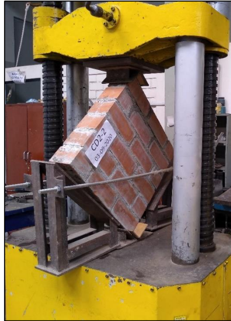
Fotografía N°52: Posicionamiento del murete en equipo de compresión diagonal.
