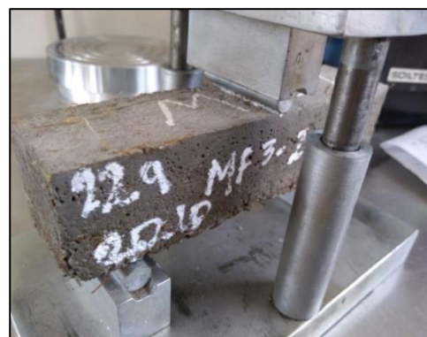
Fotografía N°80: (a) y (b): Colocación de los prismas de mortero en dispositivo de flexión.
