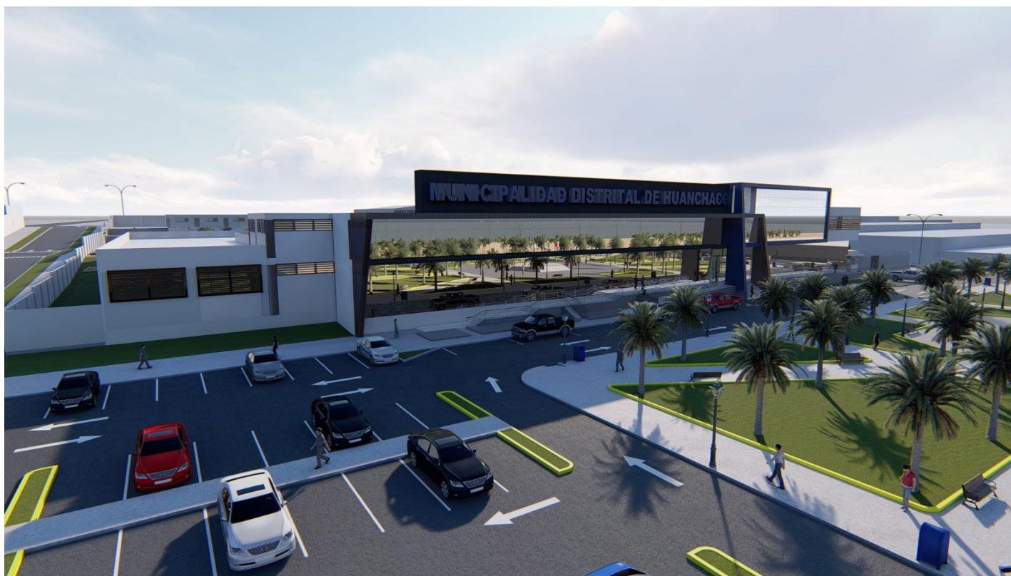
FIGURA N°78 VISTA EXTERIOR DEL PROYECTO FACHADA LADO IZQUIERDO CON APLICACIÓN DE MURO CORTINA Y VIDRIO REFLEJANTE 50% DE TRANSMISIÓN
