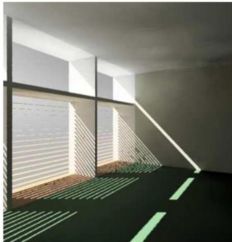
Fig. 1 Lightshelf con cielo despejado Fuente: www.london.uk.lightshelves/main.htm
