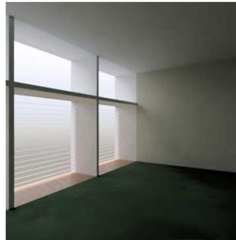
Fig. 2 Lightshelf con cielo nublado Fuente: www.london.uk.lightshelves/main.html
