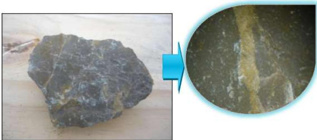
*Nota, calizas de la formación Cajamarca con venillas rellenas de calcita y Limolita.*
